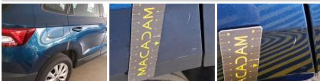
Door RR, Scratch(es), Acceptable
