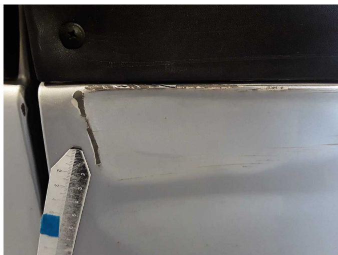
Beschädigung 20: Schiebetür rechts: Schiebetür - verformt - erneuern
