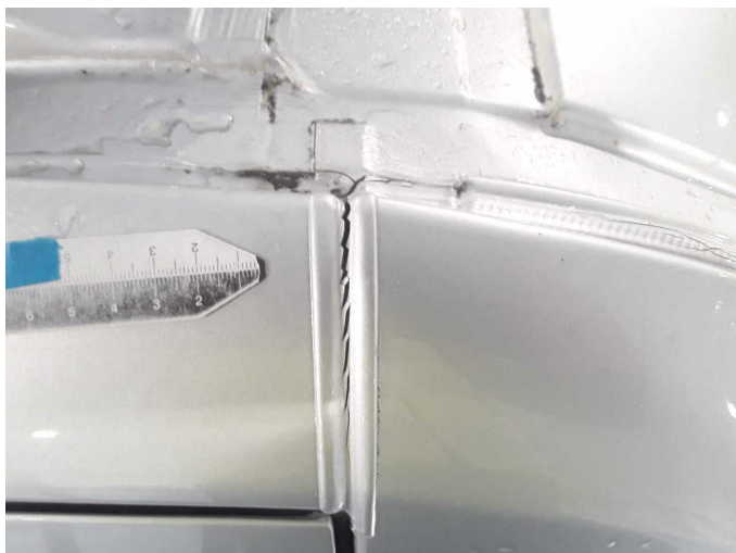
Beschädigung 21: Fahrzeugdach: Dachholm rechts - beschädigt - erneuern
