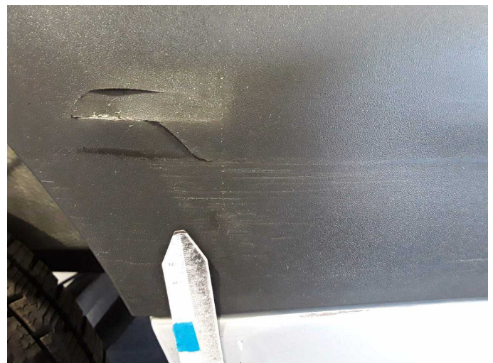
Beschädigung 12: Seitenwand rechts: Schutzleiste - beschädigt - erneuern
