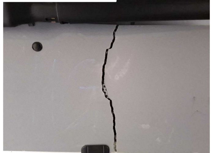
Beschädigung 26: Verkleidungen/Abdeckungen: Laderaumverkleidung links - beschädigt - erneuern
