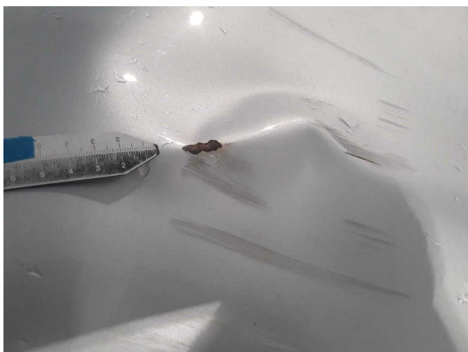
Beschädigung 21: Fahrzeugdach: Dachholm rechts - beschädigt - erneuern
