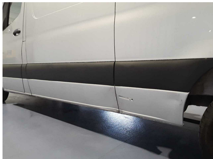
Beschädigung 4: Schweller links: Schweller - beschädigt - erneuern
