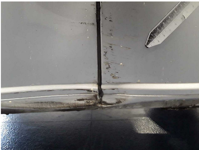
Beschädigung 4: Schweller links: Schweller - beschädigt - erneuern
