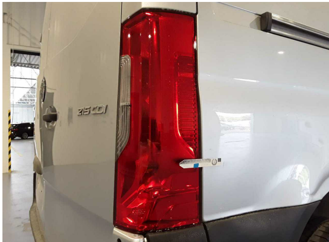
Beschädigung 10: Heckleuchte: Heckleuchte rechts - beschädigt - erneuern
