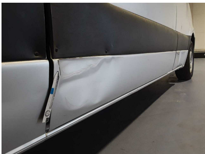
Beschädigung 20: Schiebetür rechts: Schiebetür - verformt - erneuern
