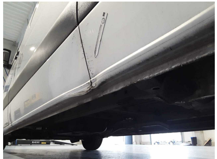
Beschädigung 4: Schweller links: Schweller - beschädigt - erneuern
