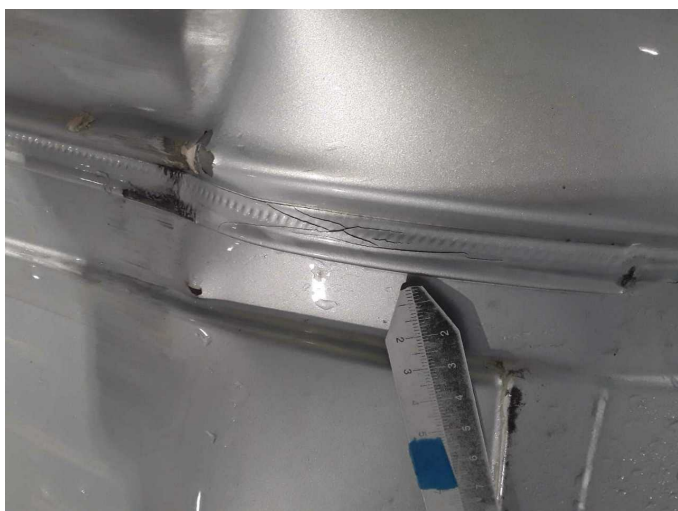
Beschädigung 21: Fahrzeugdach: Dachholm rechts - beschädigt - erneuern
