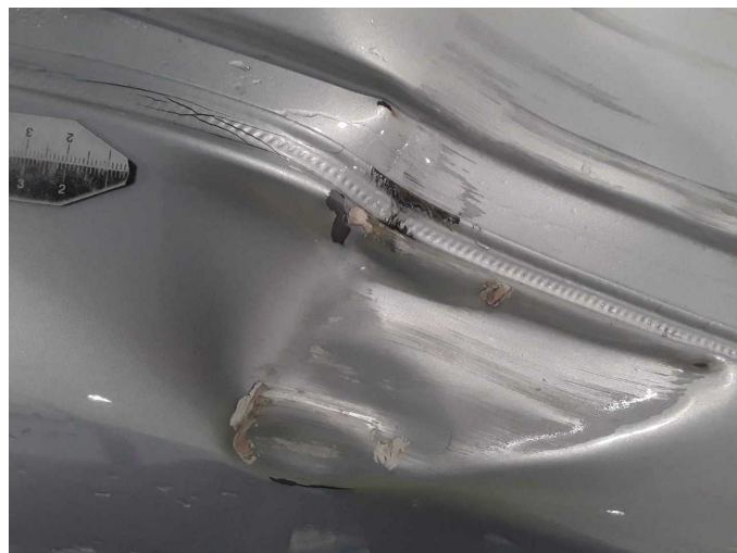
Beschädigung 21: Fahrzeugdach: Dachholm rechts - beschädigt - erneuern
