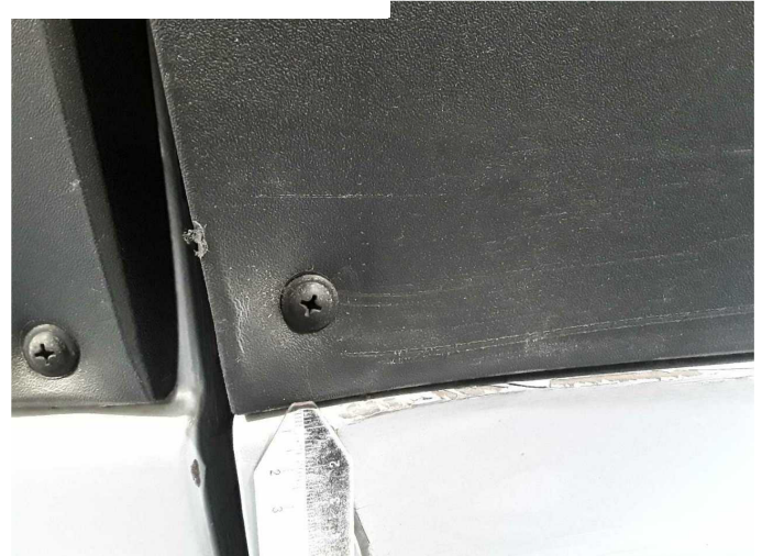
Beschädigung 15: Schiebetür rechts: Schutzleiste - beschädigt - erneuern
