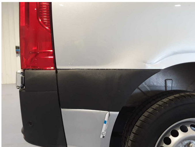
Beschädigung 11: Seitenwand rechts: Schutzleiste - beschädigt - erneuern
