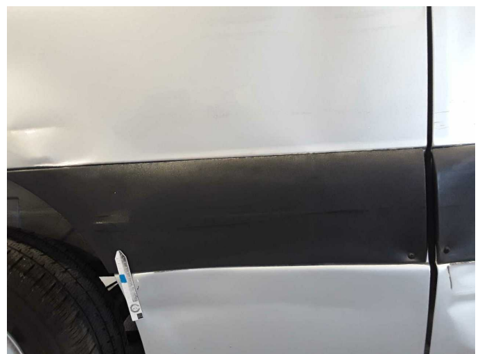
Beschädigung 12: Seitenwand rechts: Schutzleiste - beschädigt - erneuern
