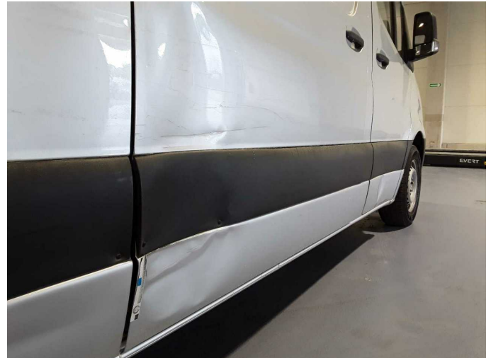
Beschädigung 15: Schiebetür rechts: Schutzleiste - beschädigt - erneuern
