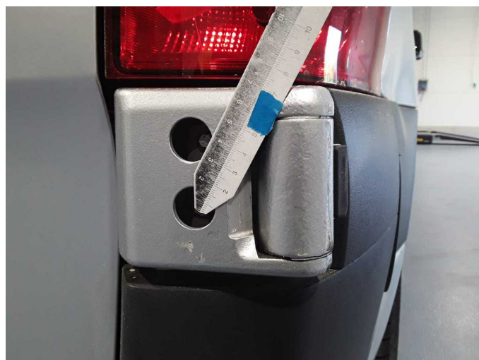
Beschädigung 9: Heckklappe/-tür: Scharnier - verkratzt / verschürft - lackieren
