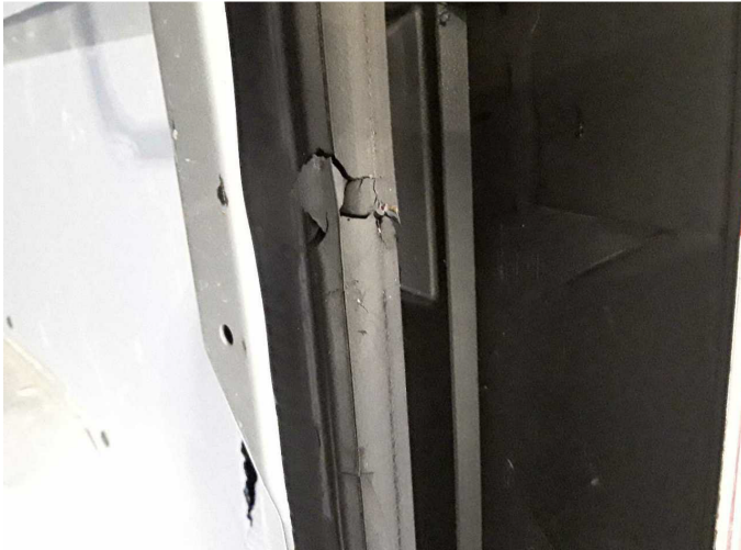
Beschädigung 24: Heckklappe/-tür: Dichtung - beschädigt - erneuern
