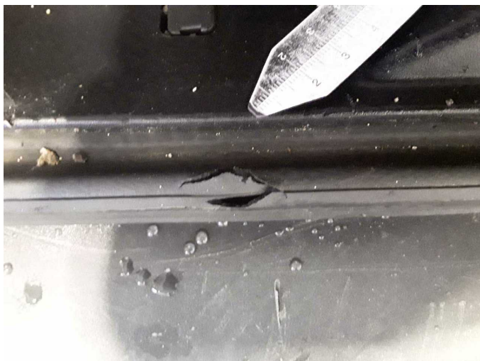
Beschädigung 24: Heckklappe/-tür: Dichtung - beschädigt - erneuern
