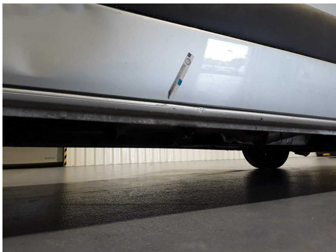
Beschädigung 16: Schweller rechts: Schweller - beschädigt - erneuern
