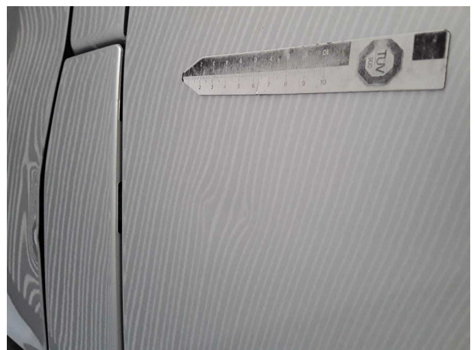
Beschädigung 3: Seitenwand links: Seitenwand - Delle / Lackschaden - instandsetzen/lackieren (S3)
