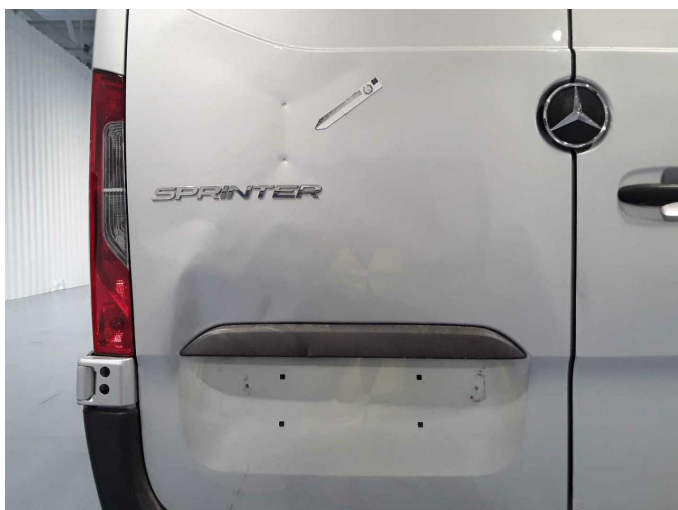
Beschädigung 8: Heckklappe/-tür: Hecktür links - beschädigt - erneuern
