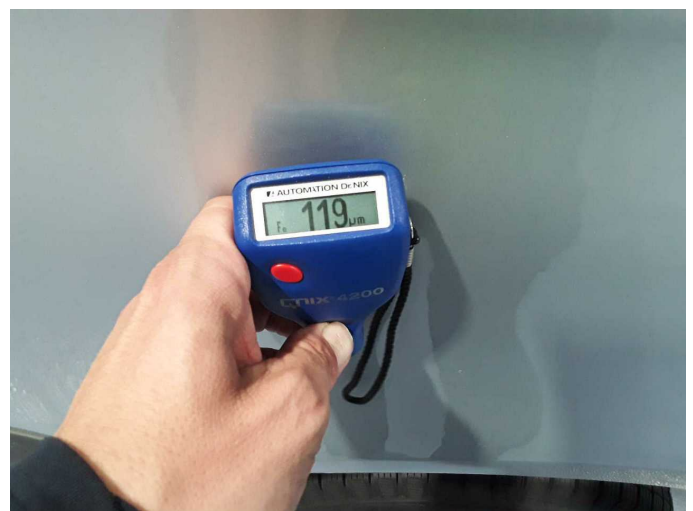
Seitenwand links: 119 µm
