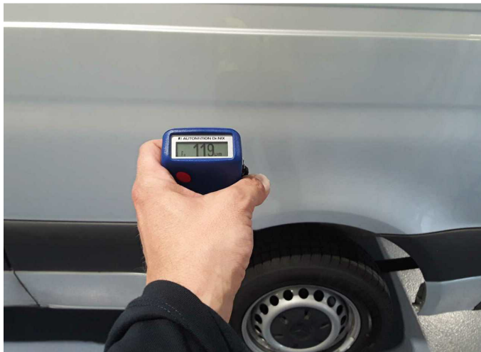
Seitenwand links: 119 µm
