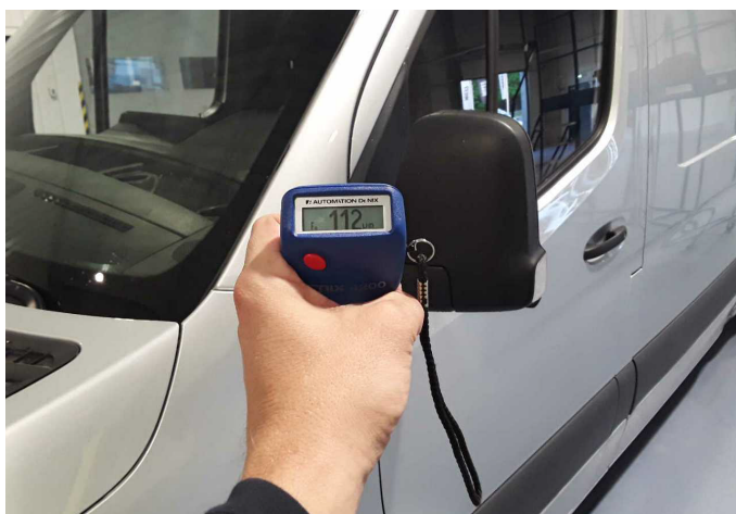
Dachholm rechts: 112 \mu\text{m}
