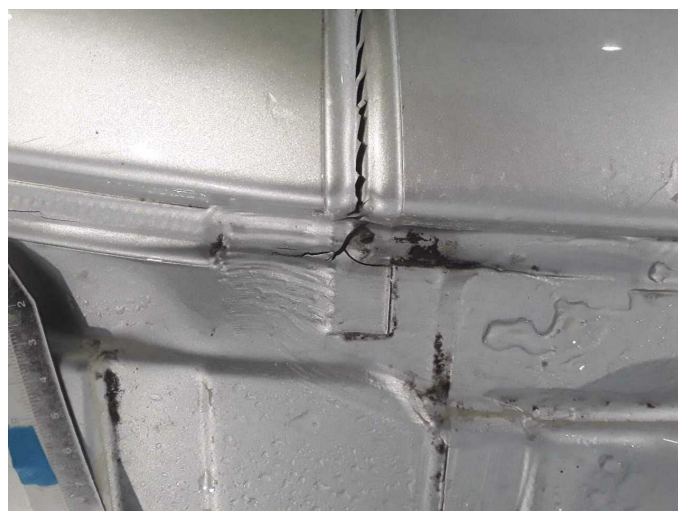
Beschädigung 21: Fahrzeugdach: Dachholm rechts - beschädigt - erneuern
