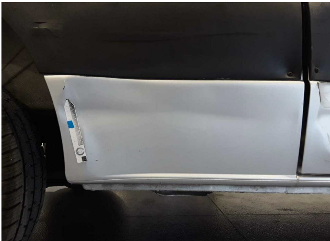
Beschädigung 14: Schweller rechts: Schweller - verformt - erneuern
