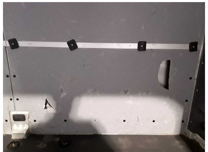
Beschädigung 26: Verkleidungen/Abdeckungen: Laderaumverkleidung links - beschädigt - erneuern
