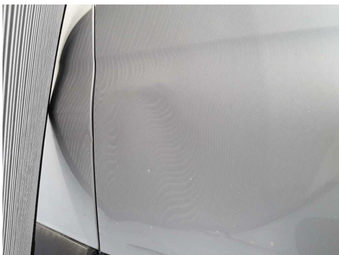
Beschädigung 20: Schiebetür rechts: Schiebetür - verformt - erneuern
