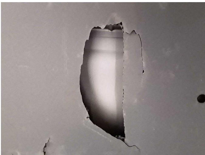
Beschädigung 26: Verkleidungen/Abdeckungen: Laderaumverkleidung links - beschädigt - erneuern
