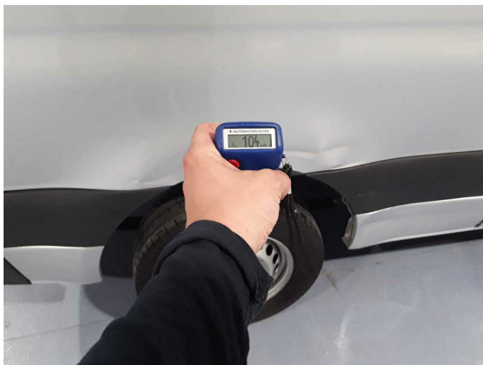
Seitenwand rechts: 104 µm
