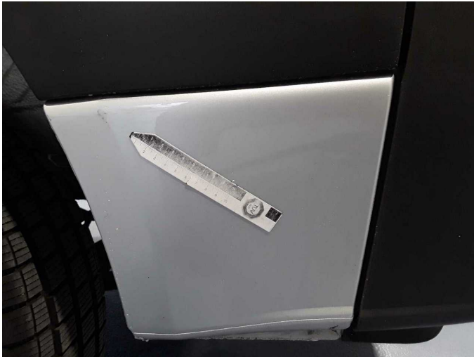
Gebrauchsspur 1: Seitenwand links: Radlauf - verkratzt / verschürft - kein Abzug
