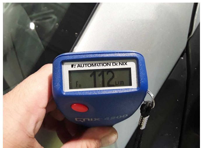
Dachholm rechts: 112 µm
