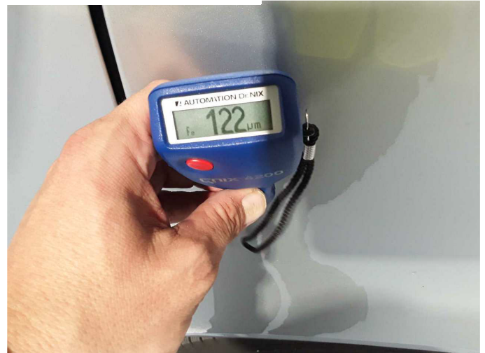
Kotflügel rechts: 122 µm
