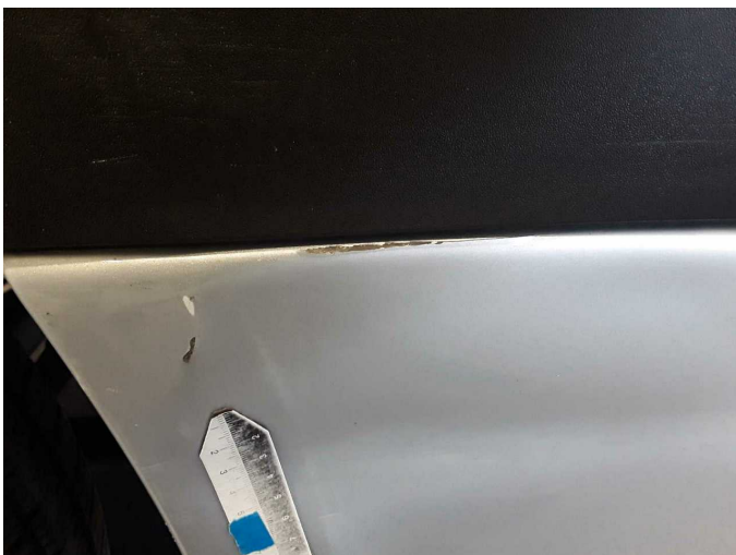
Beschädigung 14: Schweller rechts: Schweller - verformt - erneuern
