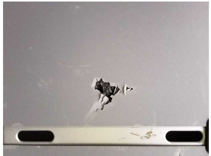
Beschädigung 27: Verkleidungen/Abdeckungen: Laderaumverkleidung rechts - gebrochen / gerissen - erneuern
