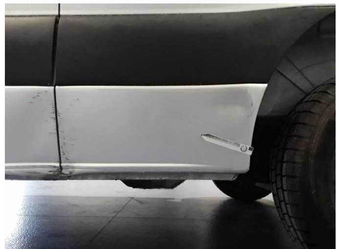
Beschädigung 4: Schweller links: Schweller - beschädigt - erneuern
