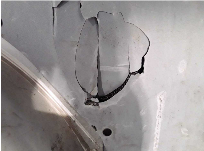
Beschädigung 26: Verkleidungen/Abdeckungen: Laderaumverkleidung links - beschädigt - erneuern
