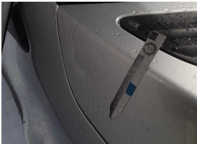
Beschädigung 19: Motorhaube: Motorhaube - Delle(n) - instandsetzen lt. Kalkulation
