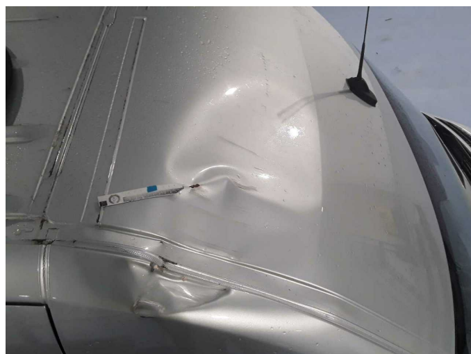
Beschädigung 21: Fahrzeugdach: Dachholm rechts - beschädigt - erneuern
