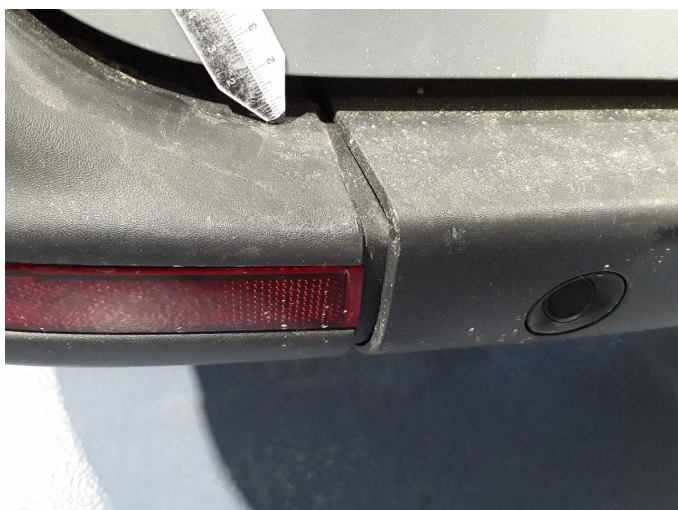
Beschädigung 5: Stossfänger vorn: Schutzleiste links - beschädigt - erneuern
