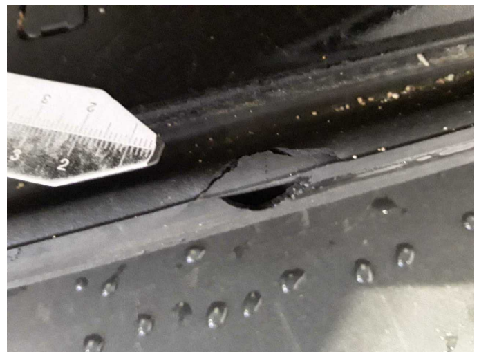
Beschädigung 24: Heckklappe/-tür: Dichtung - beschädigt - erneuern
