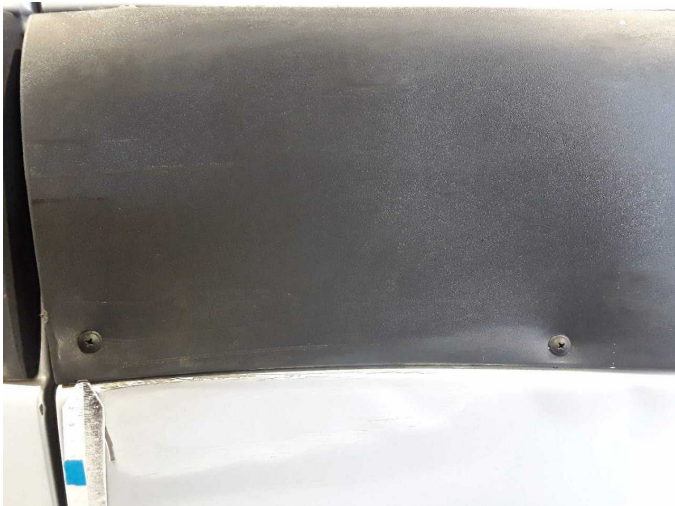
Beschädigung 15: Schiebetür rechts: Schutzleiste - beschädigt - erneuern
