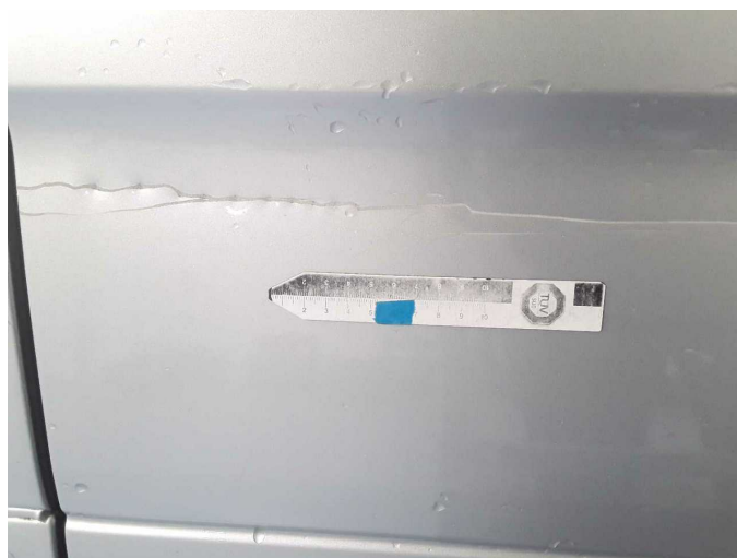
Beschädigung 20: Schiebetür rechts: Schiebetür - verformt - erneuern
