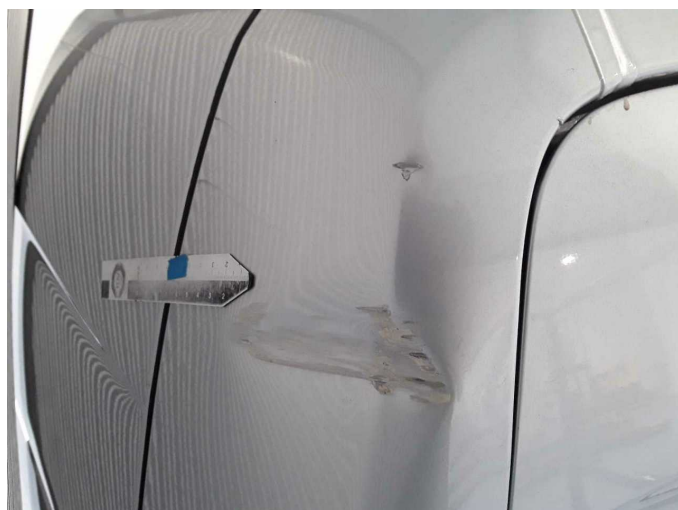
Beschädigung 30: Karosserie: D-Säule links - Delle / Lackschaden - instandsetzen/lackieren (S3)
