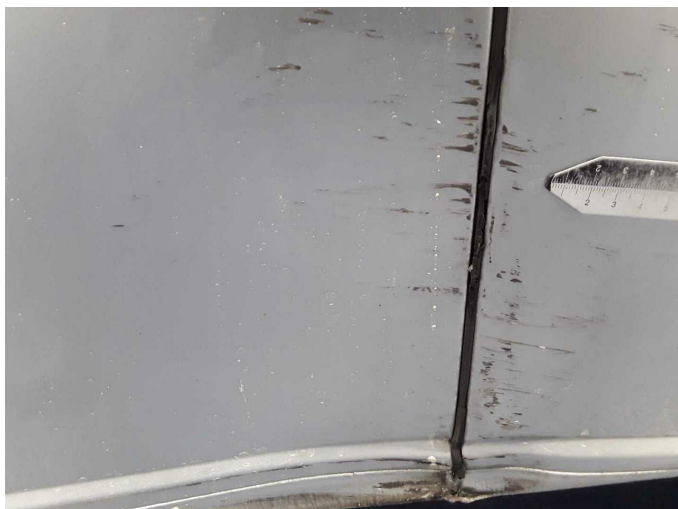
Beschädigung 4: Schweller links: Schweller - beschädigt - erneuern
