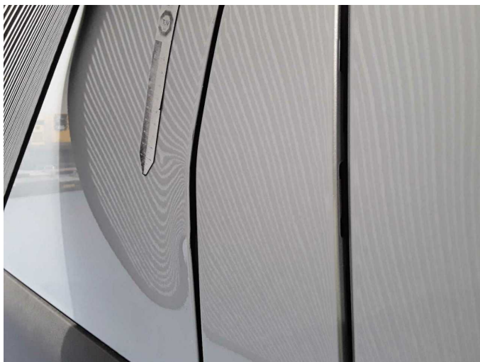
Beschädigung 2: Tür vorn links: Tür - beschädigt - erneuern
