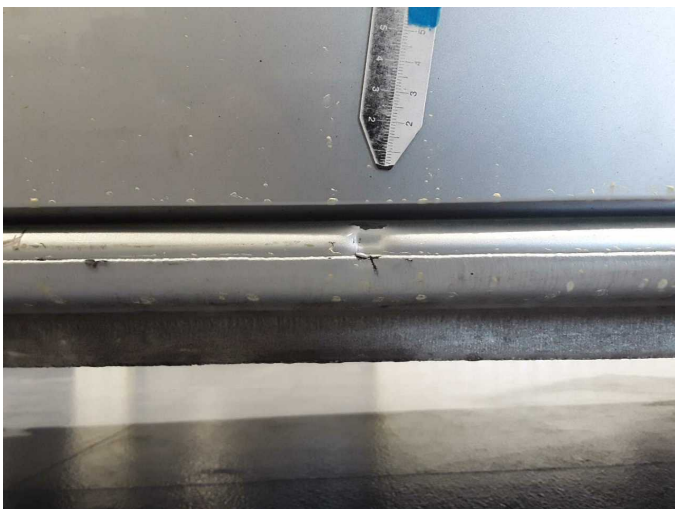
Beschädigung 16: Schweller rechts: Schweller - beschädigt - erneuern
