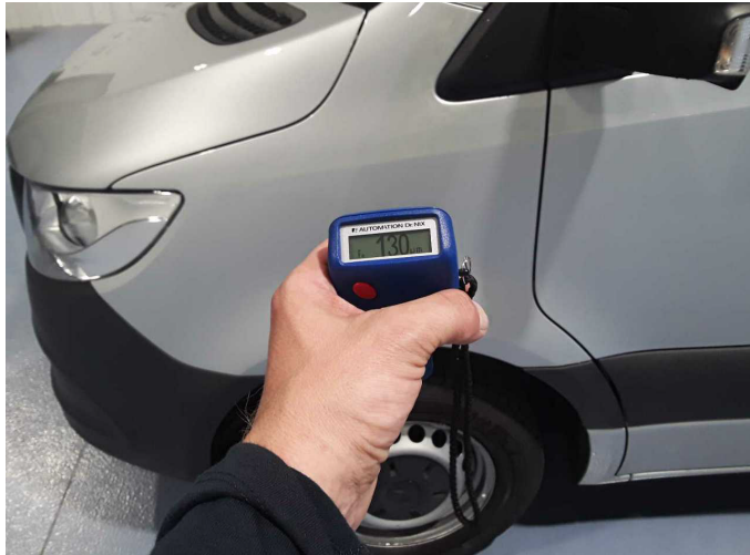
Kotflügel links: 130 µm
