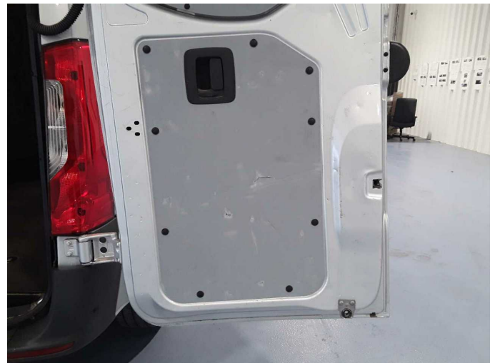
Beschädigung 23: Heckklappe/-tür: Verkl. Hecktür Sperrholz unten - beschädigt - erneuern
