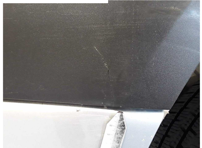
Beschädigung 11: Seitenwand rechts: Schutzleiste - beschädigt - erneuern
