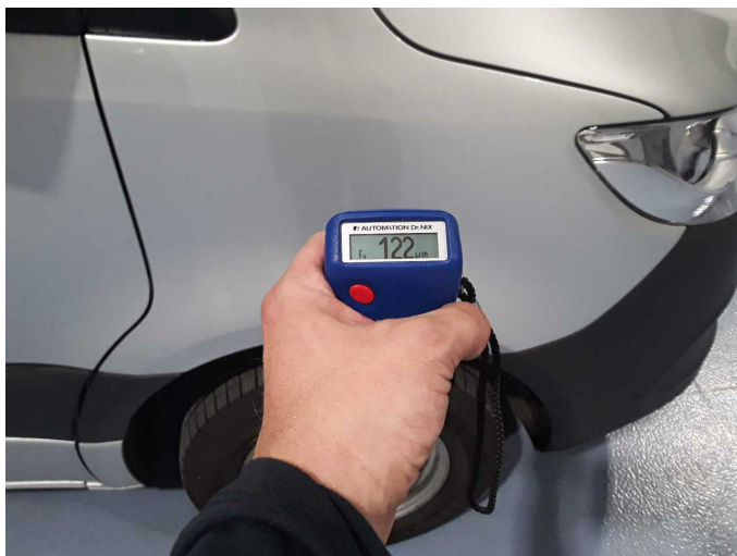
Kotflügel rechts: 122 µm
