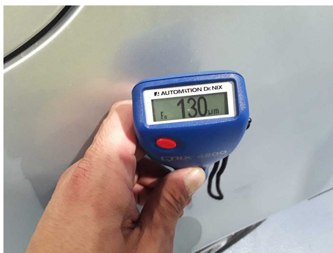
Kotflügel links: 130 \mu\text{m}
