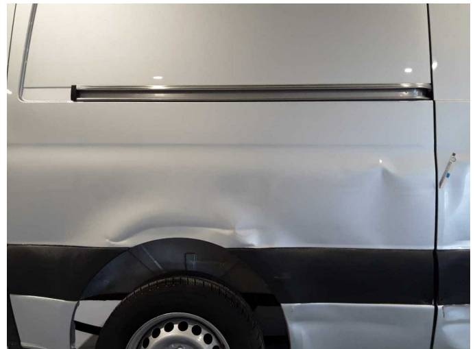
Beschädigung 13: Seitenwand rechts: Seitenwand - Delle / Lackschaden - instandsetzen/lackieren (S3)
