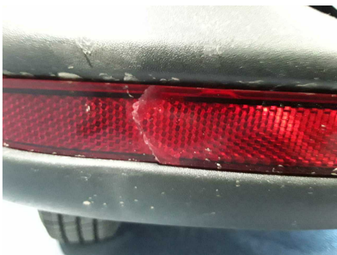
Beschädigung 6: Zusatzleuchte: Leuchtmittel - gebrochen / gerissen - erneuern
