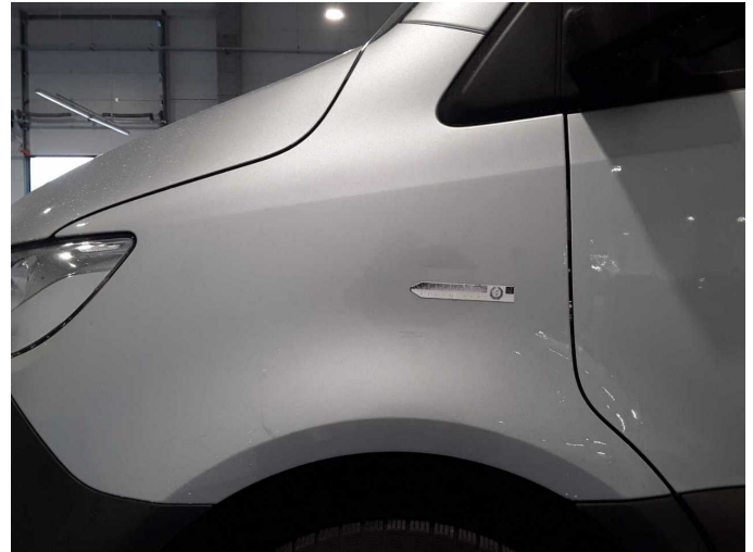
Beschädigung 1: Kotflügel links: Kotflügel links - Delle / Lackschaden - instandsetzen/lackieren (S3)
