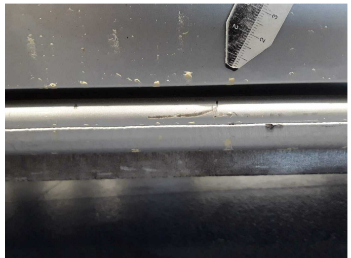
Beschädigung 16: Schweller rechts: Schweller - beschädigt - erneuern
