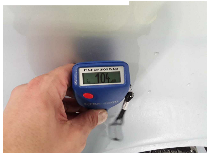
Seitenwand rechts: 104 µm
