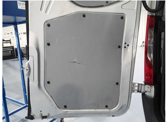
Beschädigung 22: Heckklappe/-tür: Verkl. Hecktür Sperrholz unten - beschädigt - erneuern
