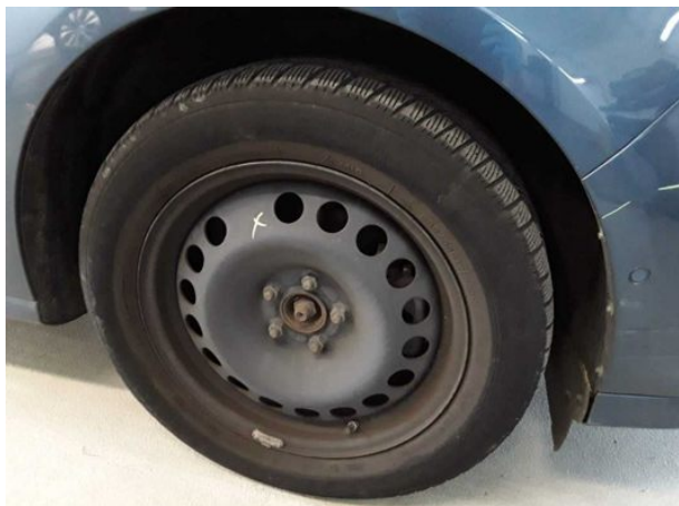
Beschädigung #2: Rad/Reifen: Reifensatz komplett (Winter) - verschlissen - kein Abzug
