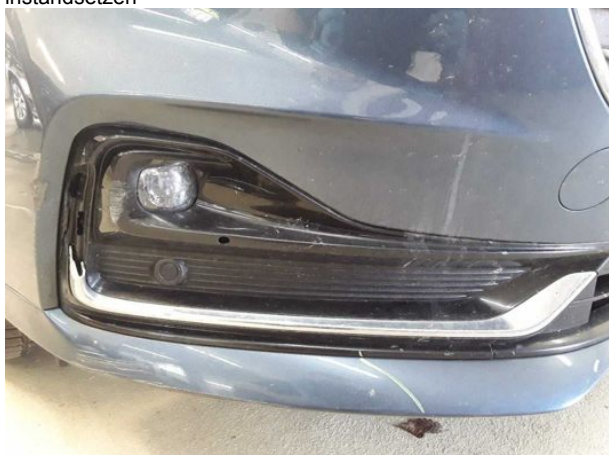
Beschädigung #6: Verkleidungen/Abdeckungen: Verkleidungen/Abdeckungen (Chromleiste) - gebrochen / gerissen - erneuern
