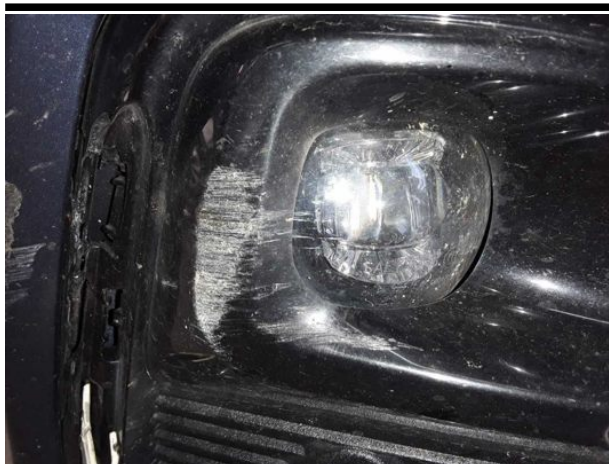
Beschädigung #7: Nebelleuchte: Nebelleuchte vorn rechts - verkratzt / verschürft - erneuern
