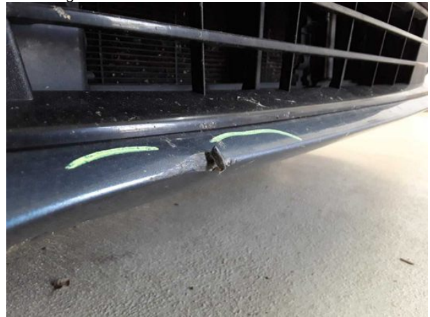
Beschädigung #16: Stossfänger vorn: Stossfänger vorn - beschädigt - erneuern
