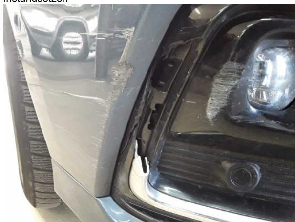
Beschädigung #6: Verkleidungen/Abdeckungen: Verkleidungen/Abdeckungen (Chromleiste) - gebrochen /
