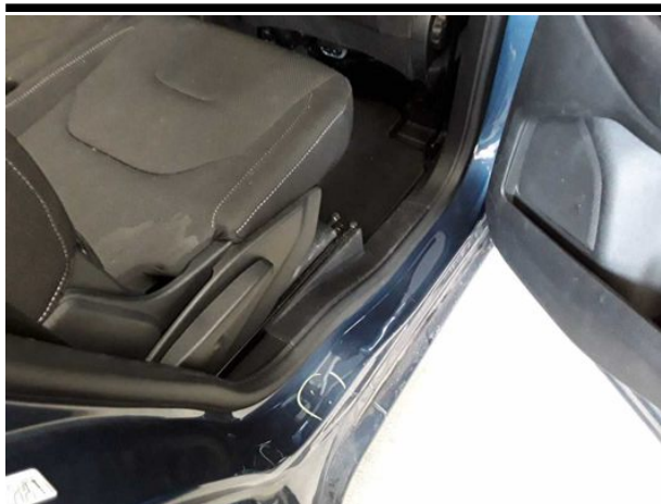
Beschädigung #10: Seitenwand rechts: Einstieg - Delle / Lackschaden - instandsetzen und lackieren
