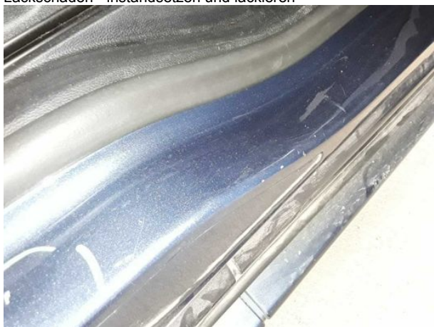
Beschädigung #10: Seitenwand rechts: Einstieg - Delle / Lackschaden - instandsetzen und lackieren
