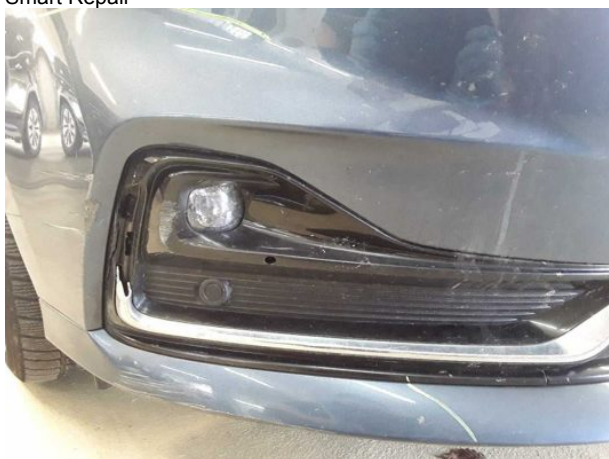
Beschädigung #9: Stossfänger vorn: Spoiler - gebrochen / gerissen - erneuern
