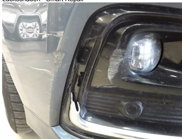
Beschädigung #9: Stossfänger vorn: Spoiler - gebrochen / gerissen - erneuern
