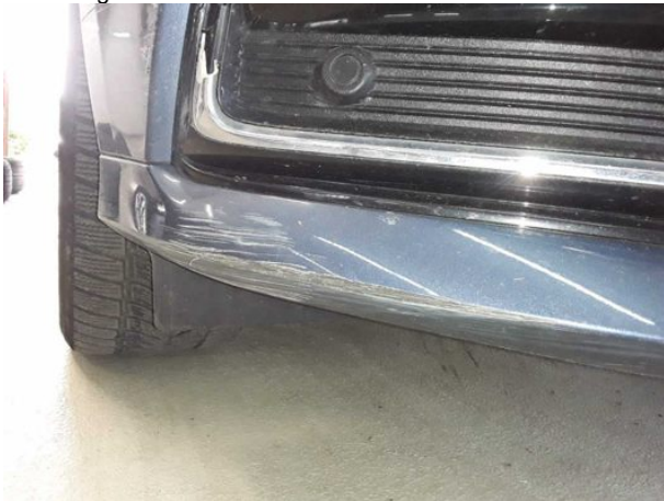
Beschädigung #16: Stossfänger vorn: Stossfänger vorn - beschädigt - erneuern
