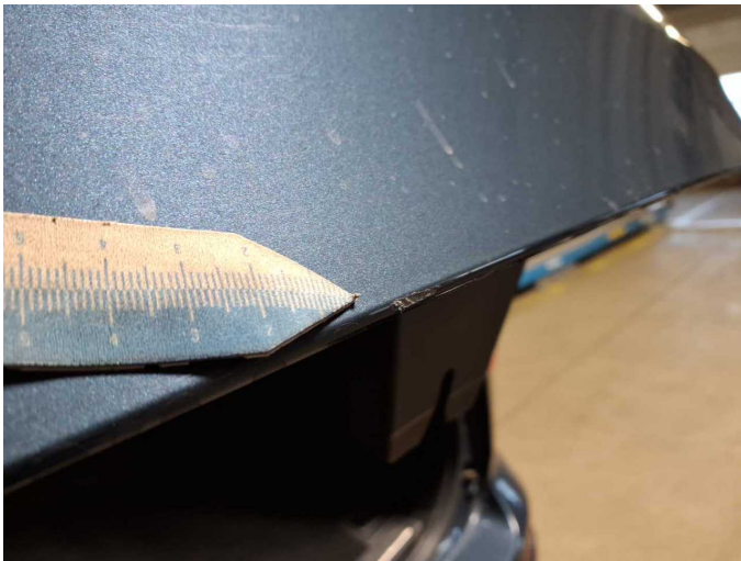
Damage 1: Boot lid / rear door: Boot lid (Kante) - Scratch(es) - Smart repair
