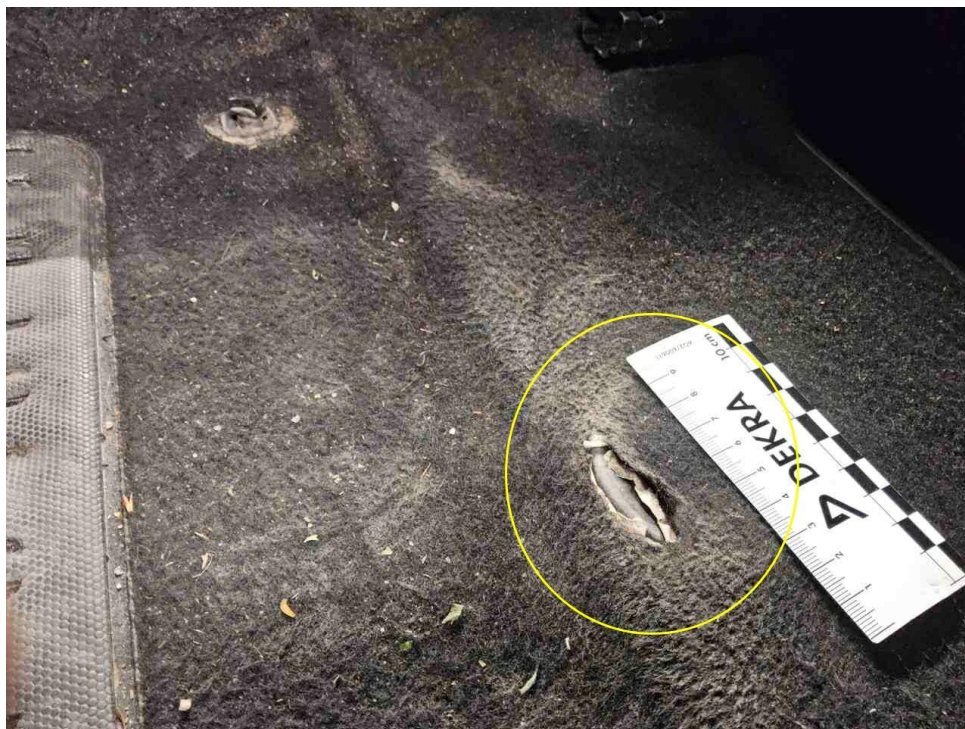
Bild 15 : Bodenbelag vorne, gerissen, smart repair
