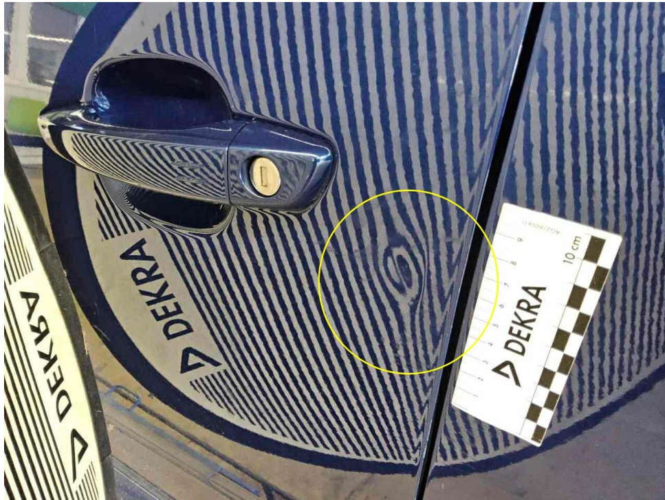
Bild 19 : Tür vorne links, eingedellt, drücken
