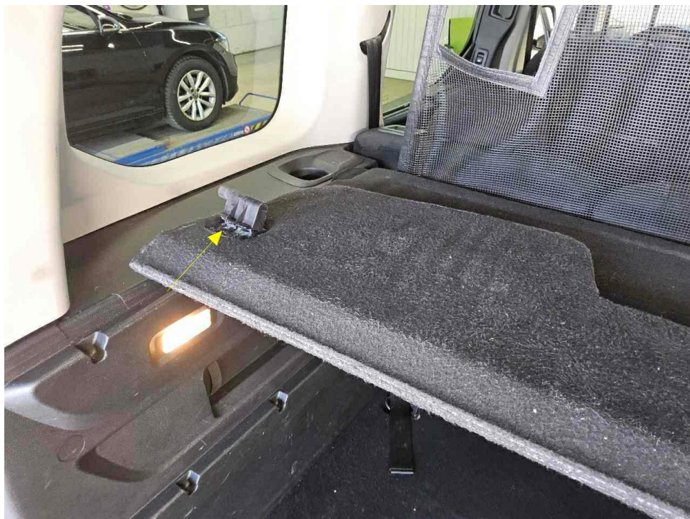
Bild 24 : Laderaumabdeckung, Halterung gebrochen
