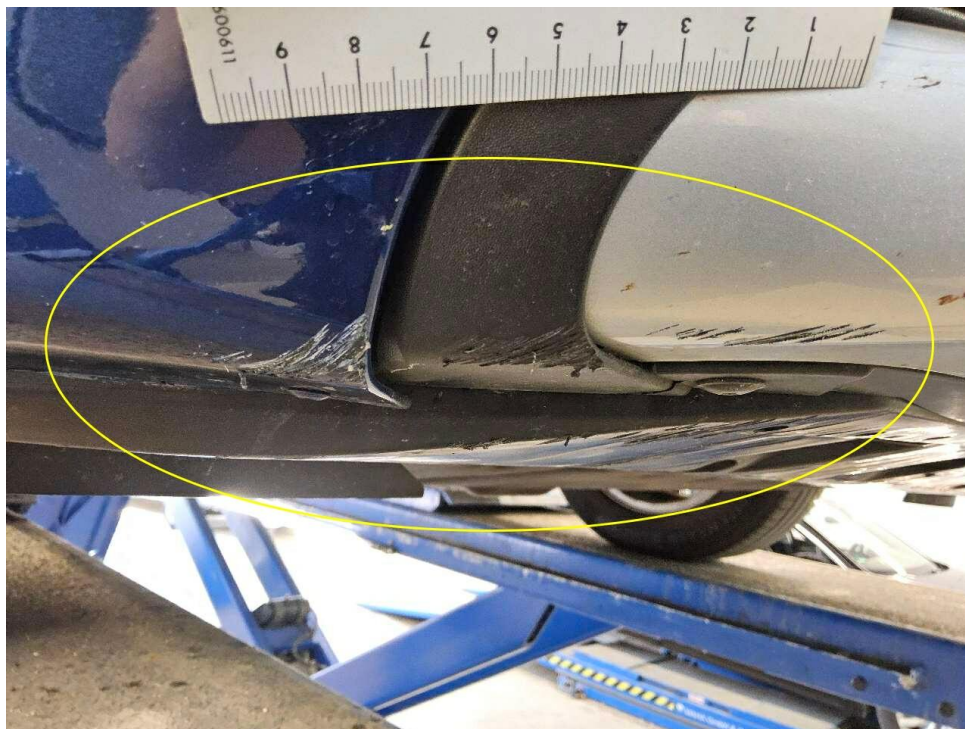
Bild 31 : Schaden Stoßfänger vorne
