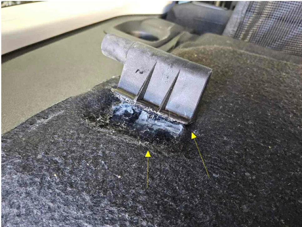
Bild 25 : Laderaumabdeckung, Halterung gebrochen
