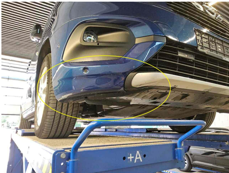
Bild 29 : Schaden Stoßfänger vorne
