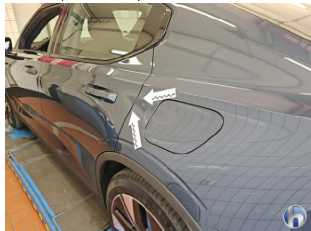
3. Seitenwand - Hinten - Links Kratzer - Smart Repair
