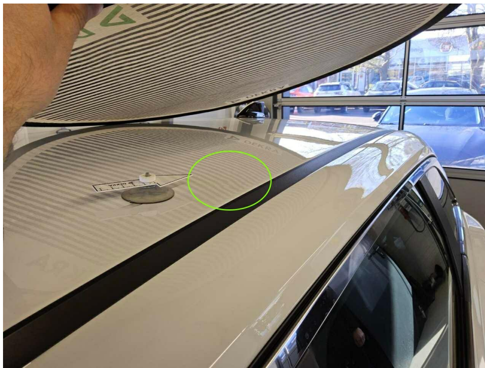
Bild 10 : Dach, Restspuren aus Instandsetzung, noch Dellen vorhanden
