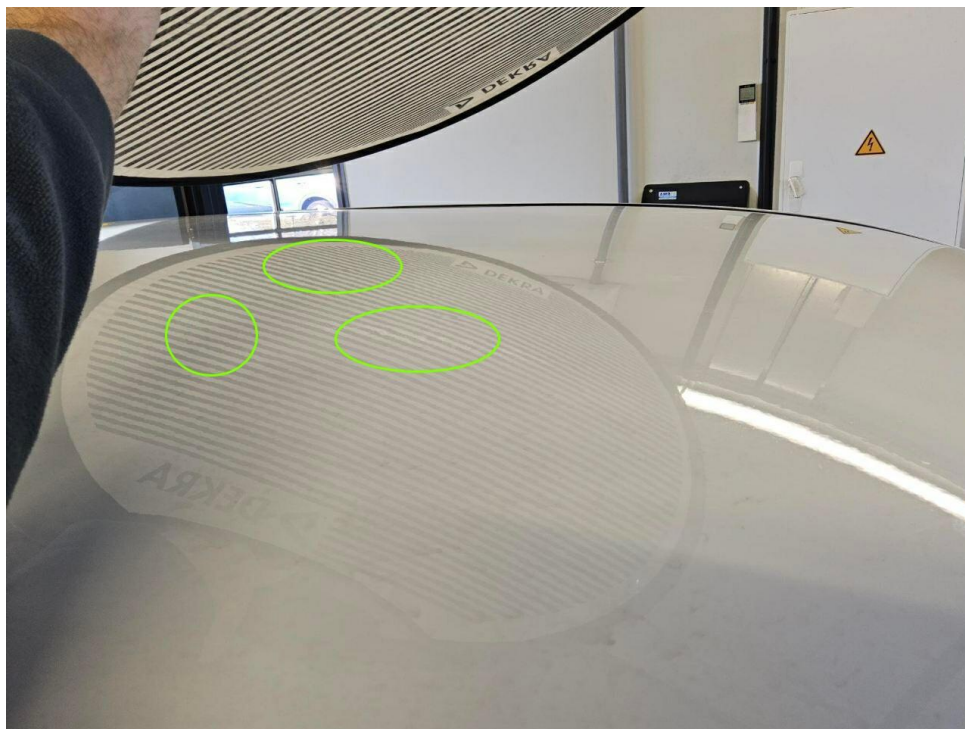
Bild 11 : Dach, Restspuren aus Instandsetzung, noch Dellen vorhanden
