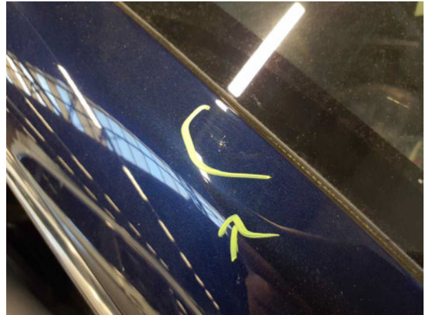
Beschädigung #9: Fahrzeugdach: Dachholm rechts (Lackfehler) - verkratzt / verschürft - auslegen / polieren
