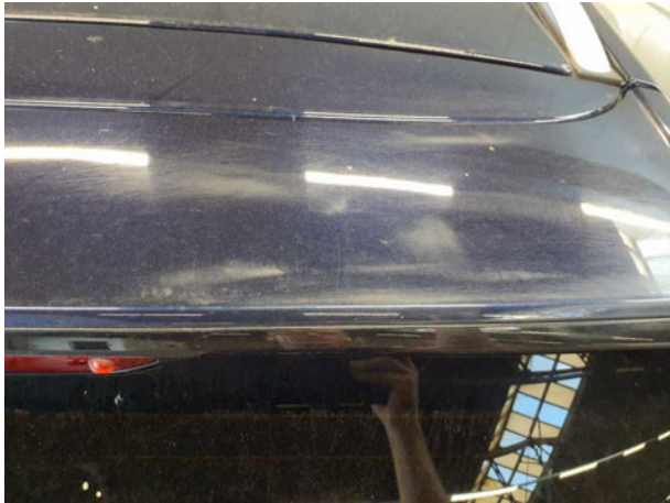
Beschädigung #15: Heckklappe/-tür: Heckspoiler (Schleifspuren) - verkratzt / verschürft - lackieren
