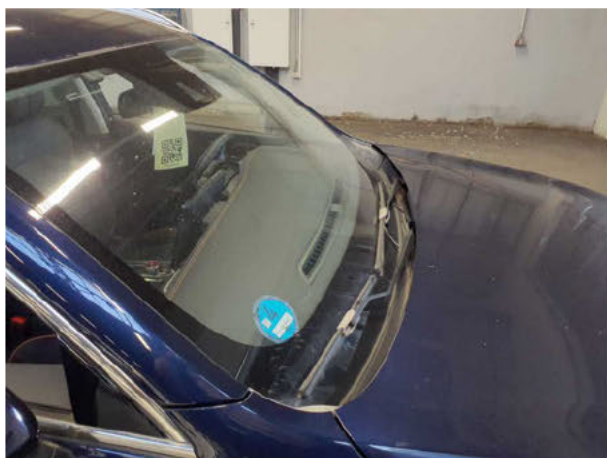
Beschädigung #7: Scheibenreinigung: Scheibenwischerblätter vorn - gebrochen / gerissen - erneuern
