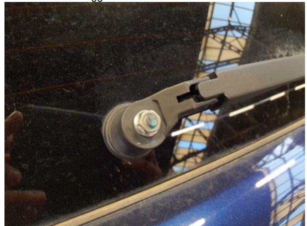
Beschädigung #5: Scheibenreinigung: Scheibenwischerarm hint... (Abdeckung) - fehlt - erneuern
