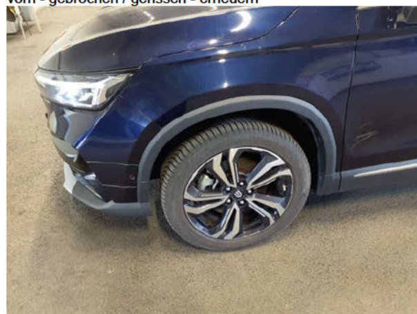
Beschädigung #8: Kotflügel links: Radhausverbreiterung - verkratzt / verschürft - Smart Repair
