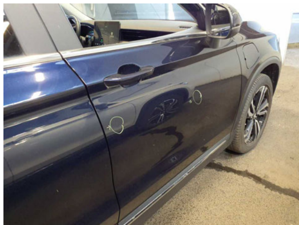
Beschädigung #11: Tür vorn rechts: Tür - Delle(n) - sanft instandsetzen
