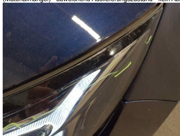
Beschädigung #2: Scheinwerfer: Scheinwerfer links (Materialmangel) - abweichend Auslieferungszustand - kein Abzug
