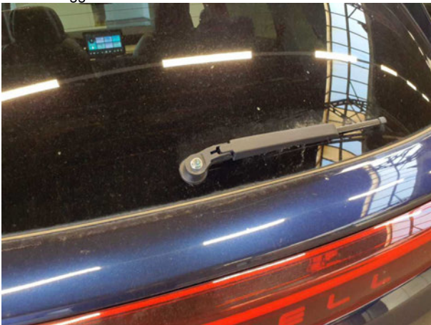
Beschädigung #5: Scheibenreinigung: Scheibenwischerarm hinten (Abdeckung) - fehlt - erneuern
