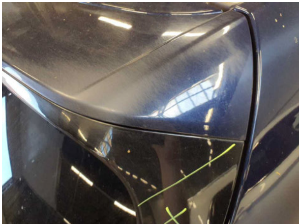
Beschädigung #15: Heckklappe/-tür: Heckspoiler (Schleifspuren) - verkratzt / verschürft - lackieren
