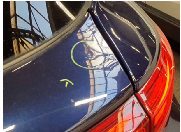
Beschädigung #14: Heckklappe/-tür: Heckklappe - Delle(n) - sanft instandsetzen
