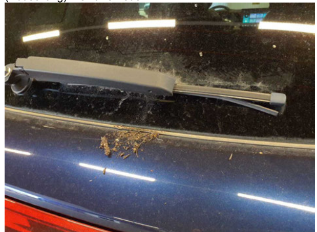
Beschädigung #6: Scheibenreinigung: Scheibenwischerblatt hinten - gebrochen / gerissen - erneuern
