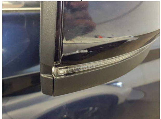
Beschädigung #10: Außenspiegel rechts: Abdeckkappe - verkratzt / verschürft - Smart Repair
