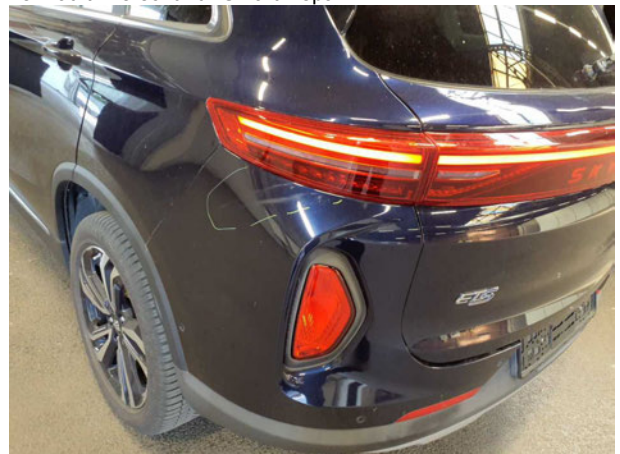
Beschädigung #13: Stossfänger hinten: Stossfänger hinten - verkratzt / verschürft - Smart Repair
