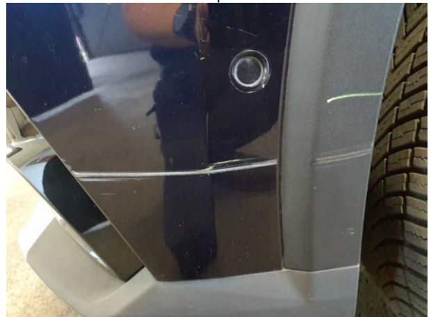
Beschädigung #12: Stossfänger vorn: Stossfänger vorn - verkratzt / verschürft - Smart Repair
