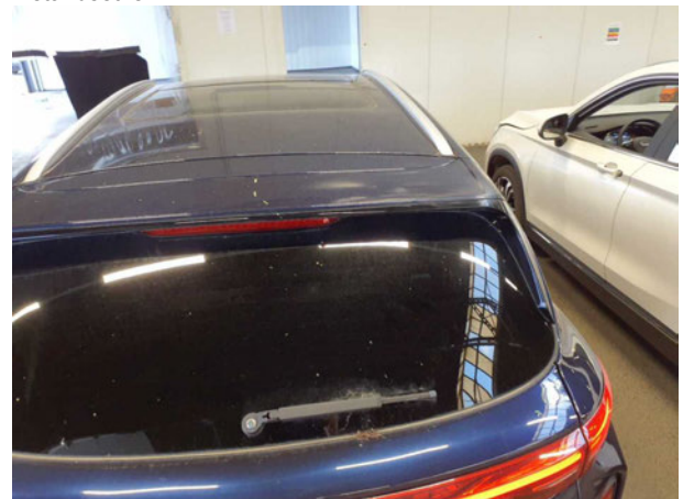
Beschädigung #15: Heckklappe/-tür: Heckspoiler (Schleifspuren) - verkratzt / verschürft - lackieren
