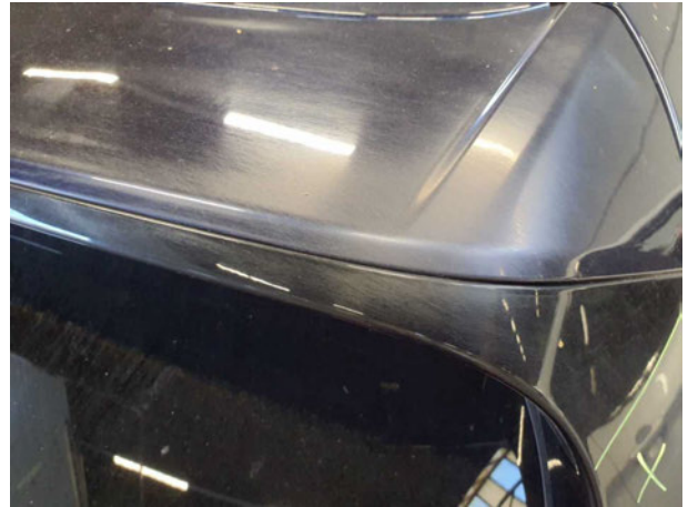
Beschädigung #15: Heckklappe/-tür: Heckspoiler (Schleifspuren) - verkratzt / verschürft - lackieren
