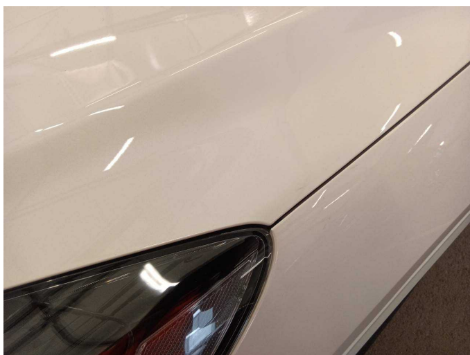
Damage 2: Bonnet: Bonnet (Spaltmaße nicht passend) - Malposition - Un- / install
