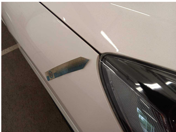
Damage 1: Mudguard - right side: Mudguard - right side (Spaltmaße nicht passend) - Malposition - Un- / install
