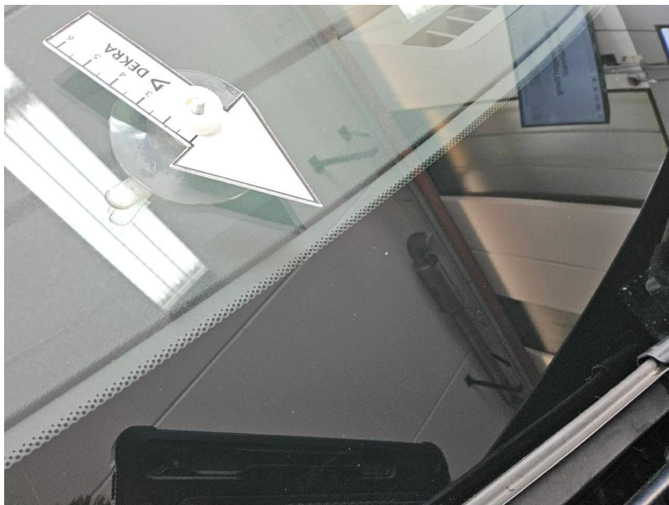
Bild 21 : Windschutzscheibe diverse kleine Steinschläge
