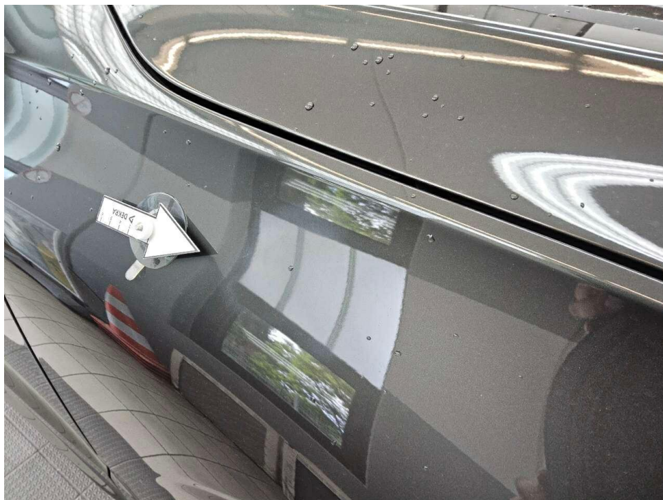
Bild 22 : Kotflügel vorne rechts, Lackierung fleckig
