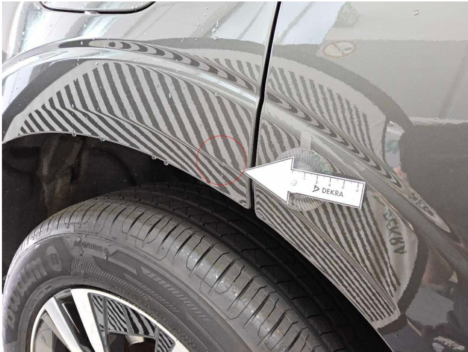
Bild 25 : Seitenteil hinten rechts, eingedellt, mit leichter Lackbeschädigung
