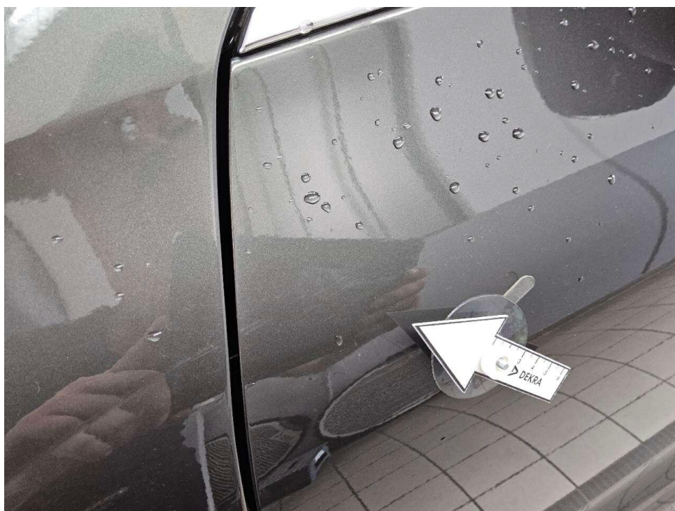
Bild 30 : Tür vorne links Lackierung, zerkratzt, polieren
