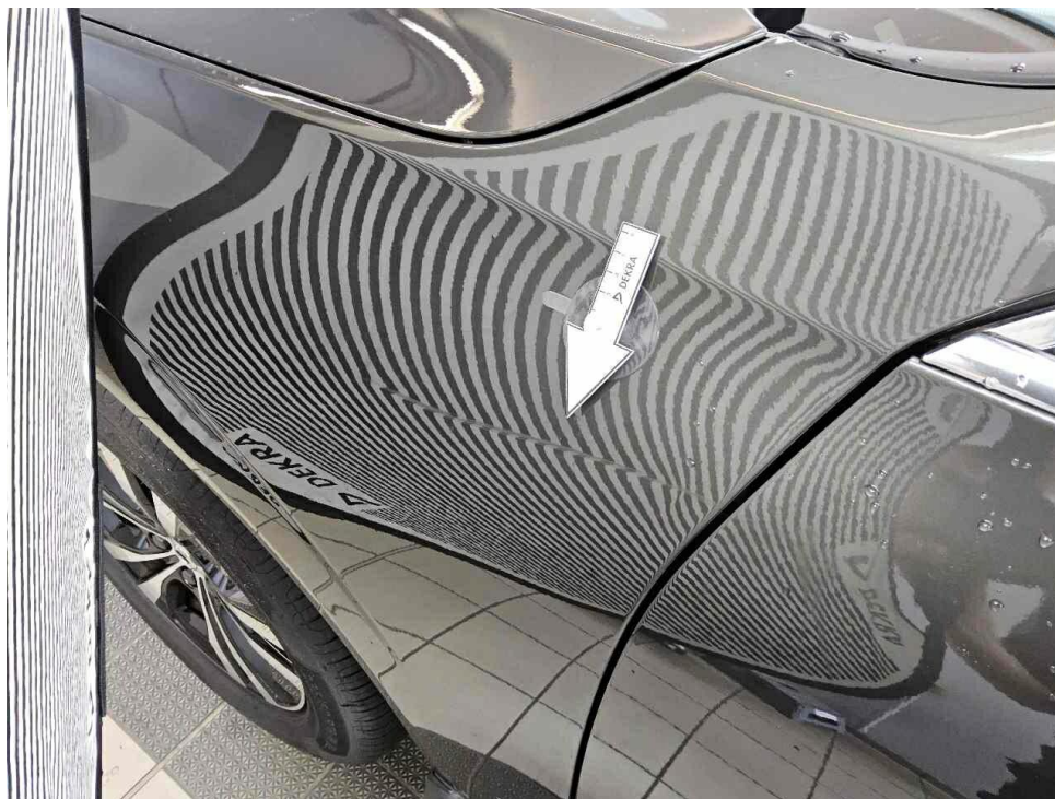
Bild 32 : Kotflügel vorne links, eingedellt, eingedrückt
