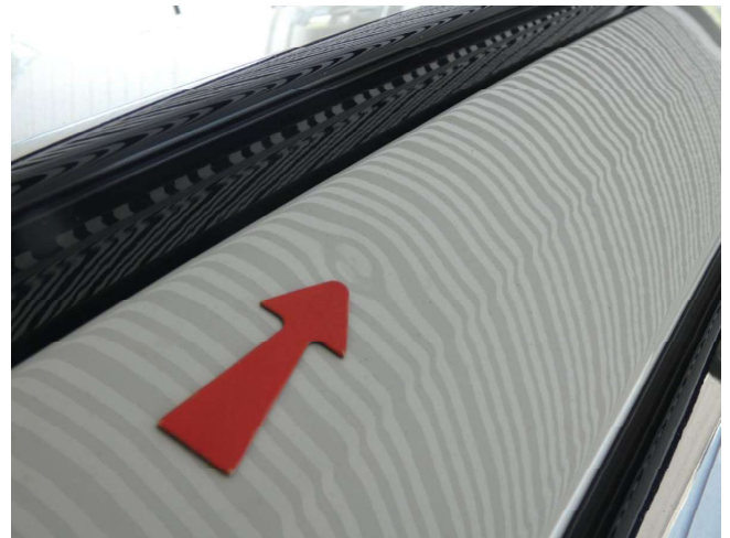
Dach - Delle - entfernen
