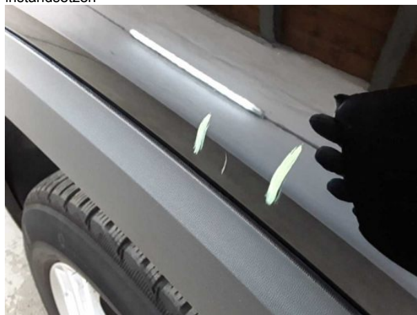
Beschädigung #4: Kotflügel rechts: Kotflügel rechts - verkratzt / verschürft - Smart Repair
