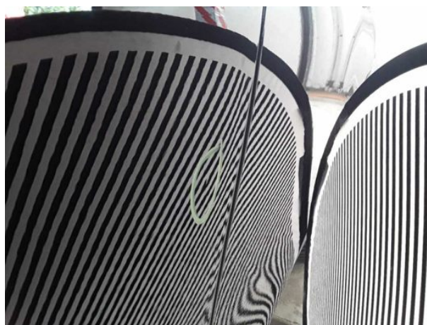
Beschädigung #3: Tür vorn links: Tür - Delle(n) - sanft instandsetzen
