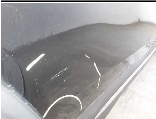
Beschädigung #12: Tür hinten rechts: Tür - Delle / Lackschaden - instandsetzen und lackieren
