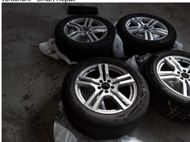
Beschädigung #5: 2.Radsatz: 2 Reifen - verschlissen - erneuern
