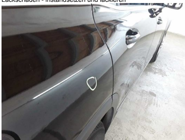
Beschädigung #10: Seitenwand rechts: Seitenwand - Delle(n) - sanft instandsetzen
