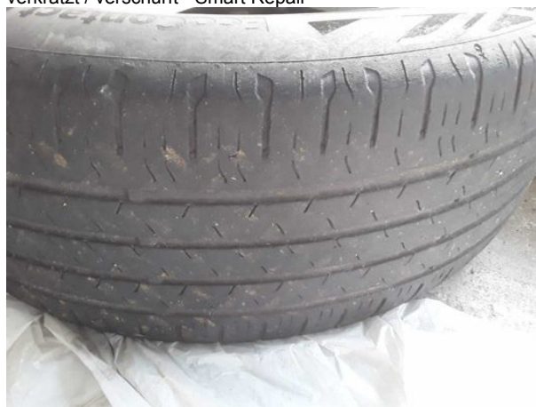
Beschädigung #5: 2.Radsatz: 2 Reifen - verschlissen - erneuern
