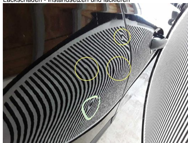
Beschädigung #10: Seitenwand rechts: Seitenwand - Delle(n) - sanft instandsetzen
