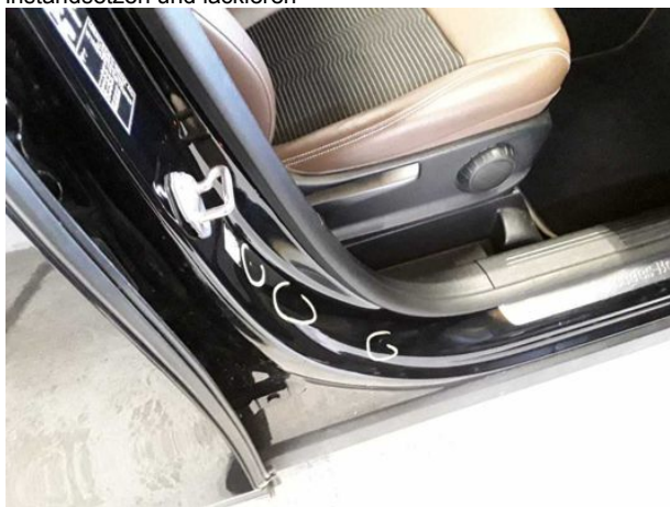
Beschädigung #9: Schweller rechts: Einstieg - Delle / Lackschaden - instandsetzen und lackieren
