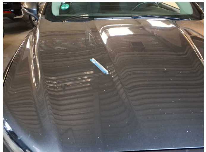
Damage 12: Bonnet: Bonnet (Sandstrahleffekt) - Stone chips - Paint
