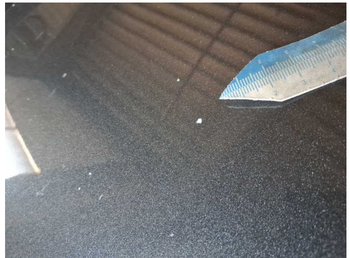
Damage 12: Bonnet: Bonnet (Sandstrahleffekt) - Stone chips - Paint
