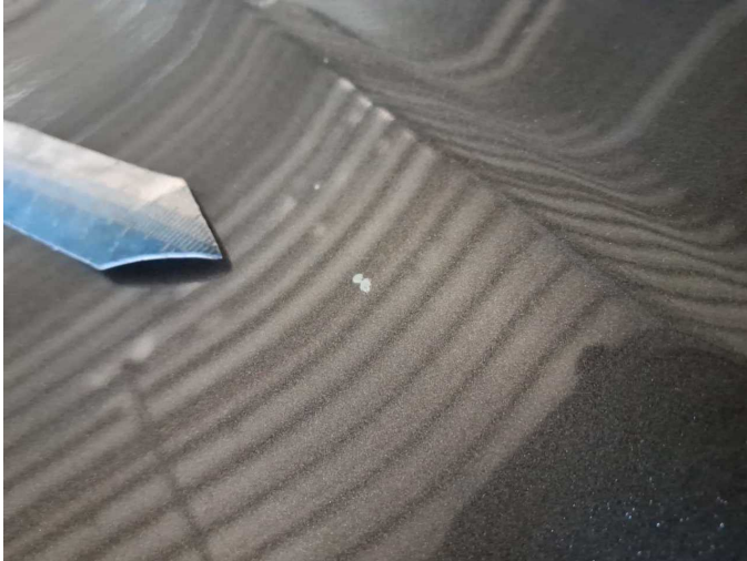
Damage 12: Bonnet: Bonnet (Sandstrahleffekt) - Stone chips - Paint
