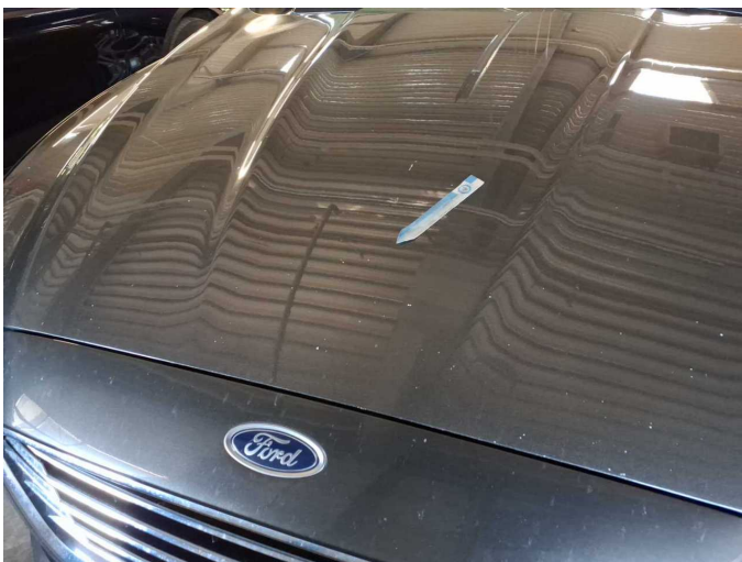
Damage 12: Bonnet: Bonnet (Sandstrahleffekt) - Stone chips - Paint
