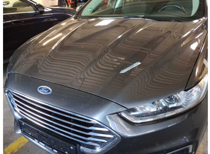
Damage 12: Bonnet: Bonnet (Sandstrahleffekt) - Stone chips - Paint
