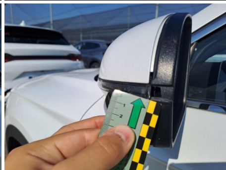
Indicatore di direzione / Sinistro / Rotto
