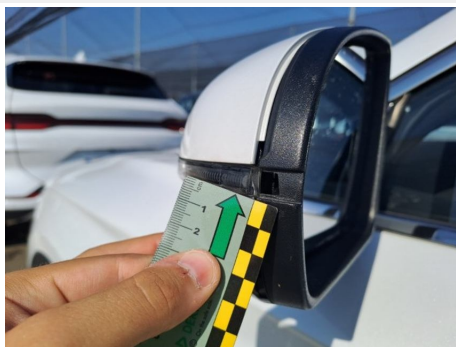
Indicatore di direzione / Sinistro / Rotto
