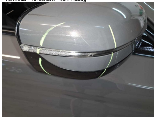
Beschädigung #3: Blinkleuchte: Spiegel rechts - beschädigt - erneuern
