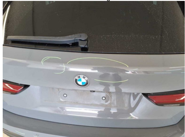
Beschädigung #7: Heckklappe/-tür: Heckklappe - Delle / Lackschaden - Smart Repair
