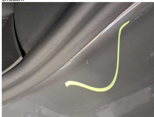
Beschädigung #4: Seitenwand links: Einstieg - verkratzt / verschürft - Smart Repair
