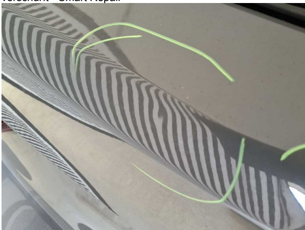
Beschädigung #7: Heckklappe/-tür: Heckklappe - Delle / Lackschaden - Smart Repair
