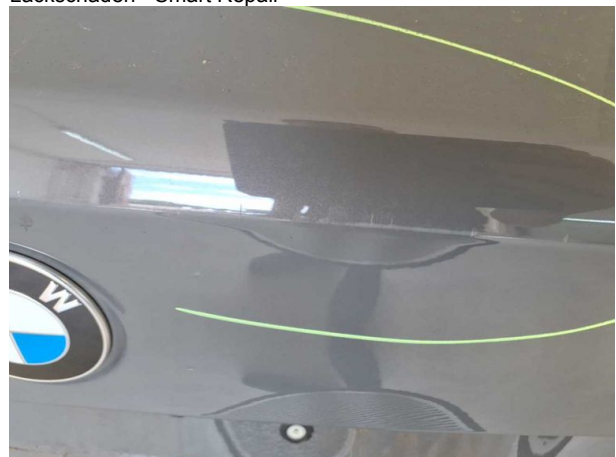
Beschädigung #7: Heckklappe/-tür: Heckklappe - Delle / Lackschaden - Smart Repair
