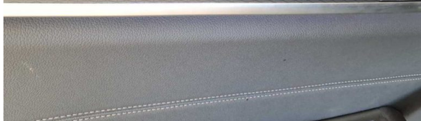
Beschädigung #2: Tür hinten links: Zierleiste oben - verkratzt / verschürft - Wertminderung
