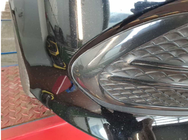
Beschädigung #3: Stossfänger vorn: Stossfänger vorn (inklusive Blende rechts erneuern) - verkratzt / verschürft - instandsetzen und
