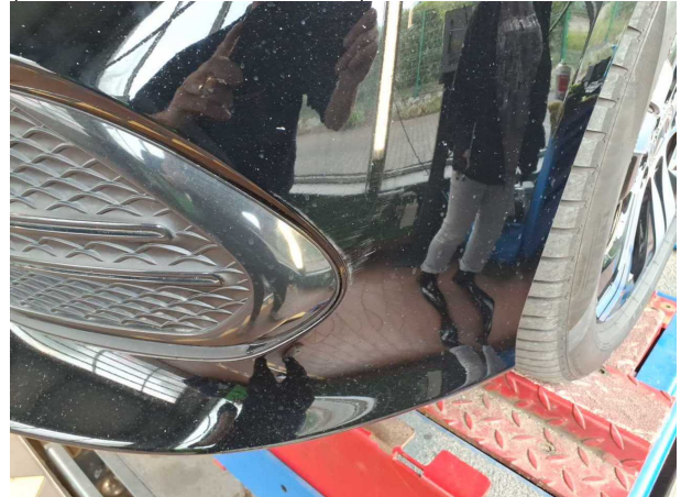
Beschädigung #3: Stossfänger vorn: Stossfänger vorn (inklusive Blende rechts erneuern) - verkratzt / verschürft -
