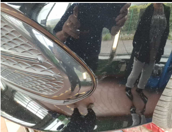
Beschädigung #3: Stossfänger vorn: Stossfänger vorn (inklusive Blende rechts erneuern) - verkratzt / verschürft - instandsetzen und
