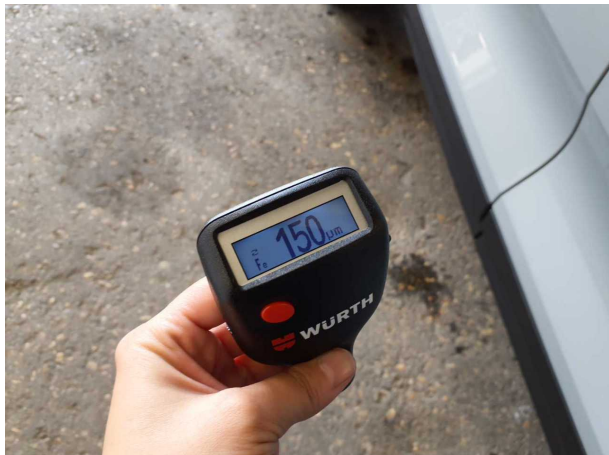
Nachlackierung 1: Dachholm rechts
