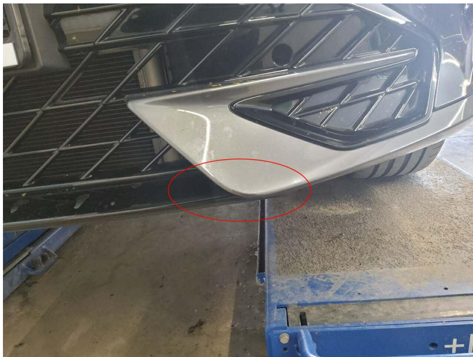
Bild 19 : Blende Stoßfänger vorne links, zerkratzt
