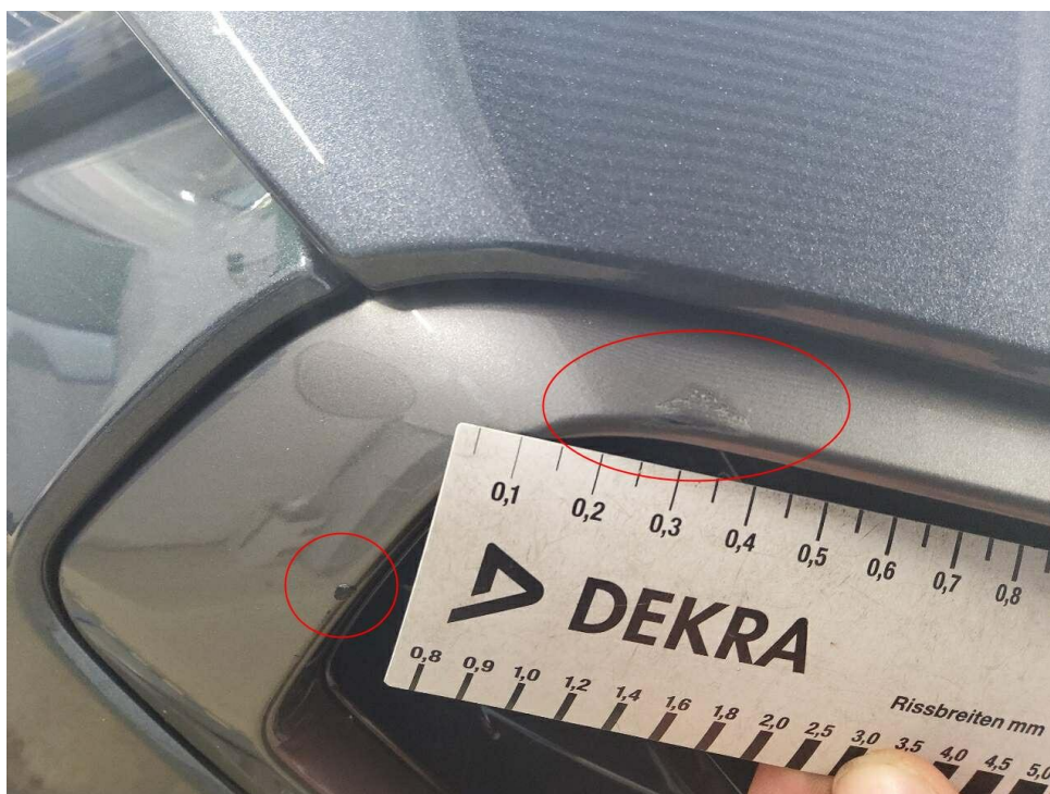
Bild 22 : Zierrahmen Kühlergrill, zerkratzt, Steinschlag
