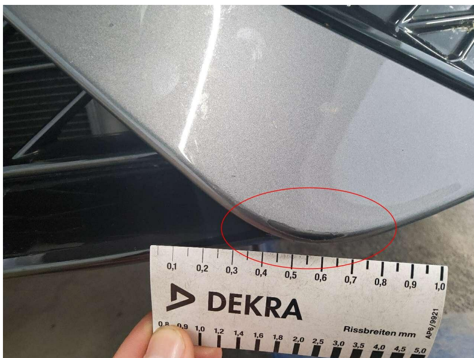
Bild 20 : Blende Stoßfänger vorne links, zerkratzt
