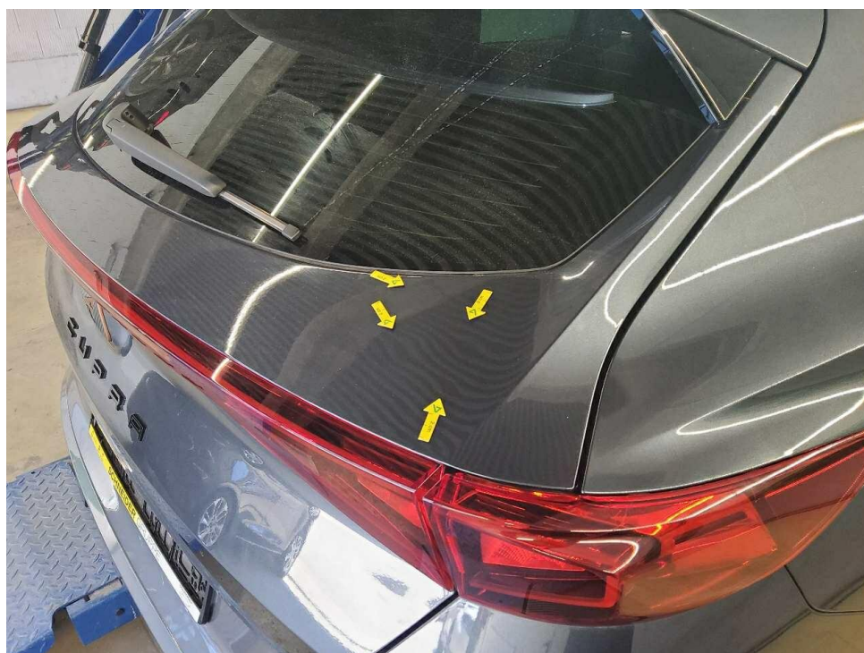
Bild 26 : Heckklappe, mehrfach eingedellt
