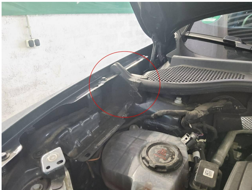
Bild 15 : Dämpfung Motorraum links fehlt rechts vorhanden
