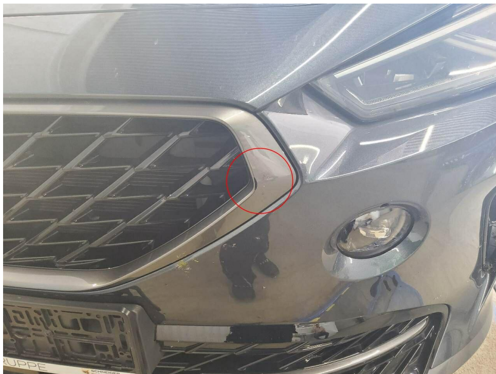
Bild 23 : Zierrahmen Kühlergrill, zerkratzt, Steinschlag
