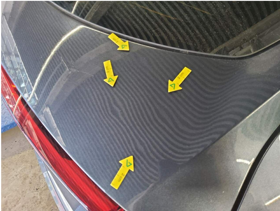
Bild 27 : Heckklappe, mehrfach eingedellt
