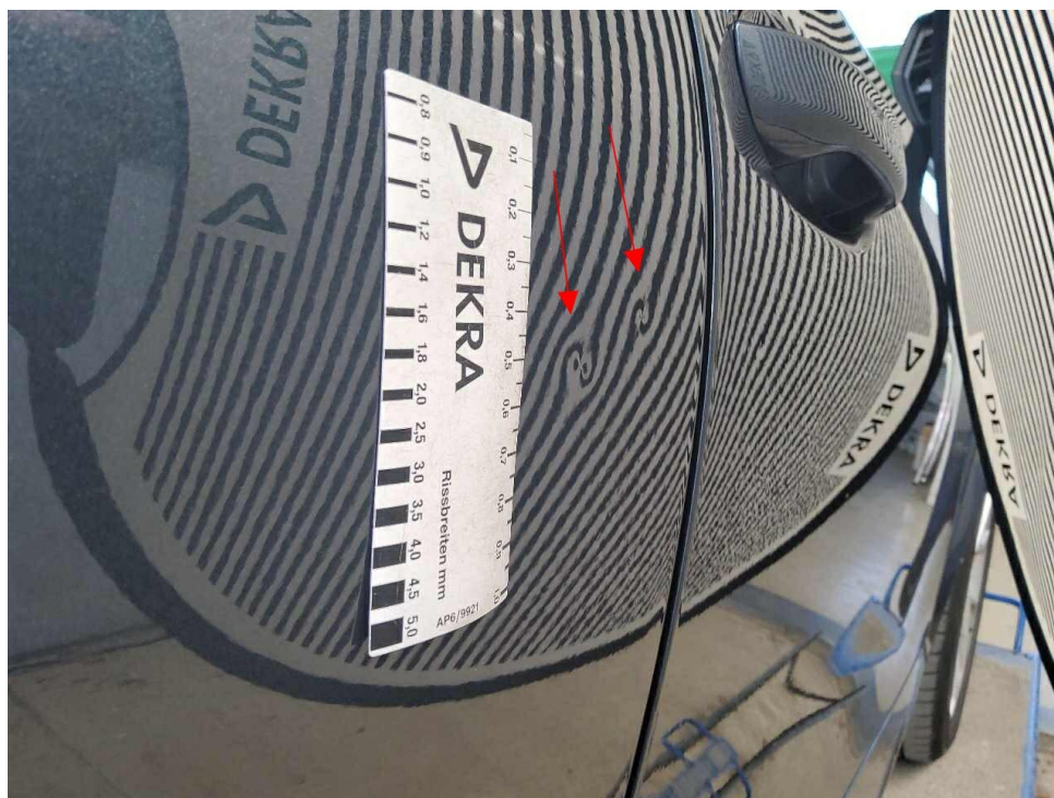
Bild 25 : Tür hinten rechts, eingedellt
