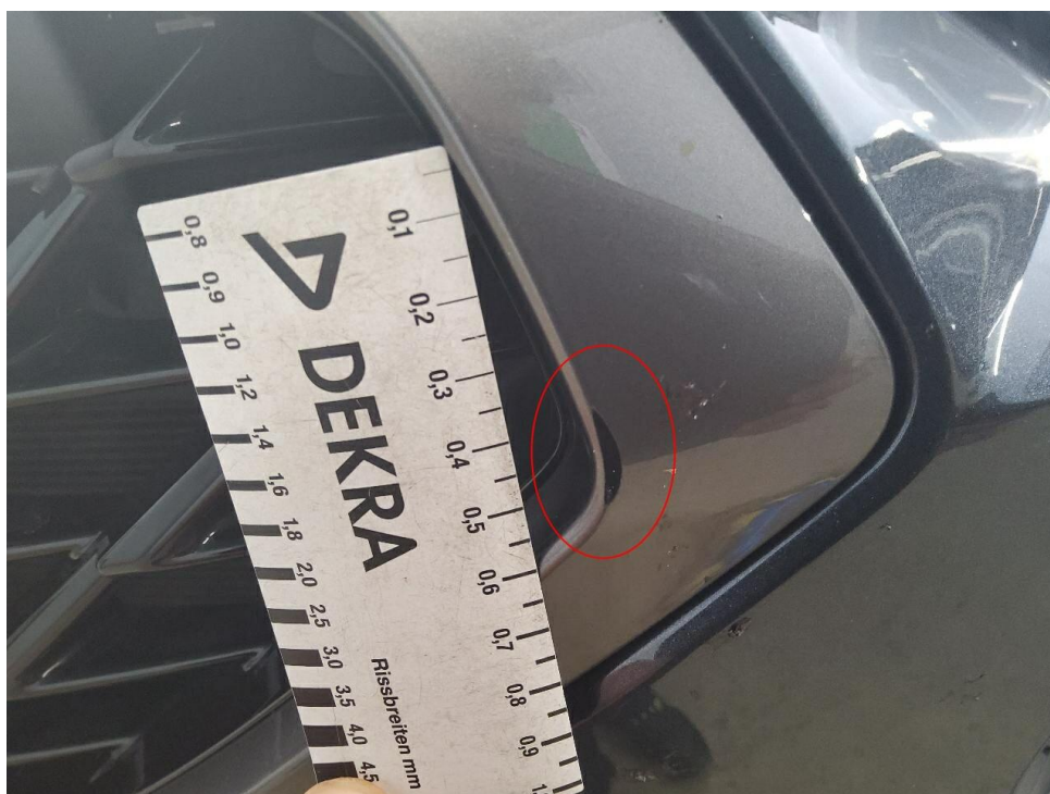
Bild 24 : Zierrahmen Kühlergrill, zerkratzt, Steinschlag
