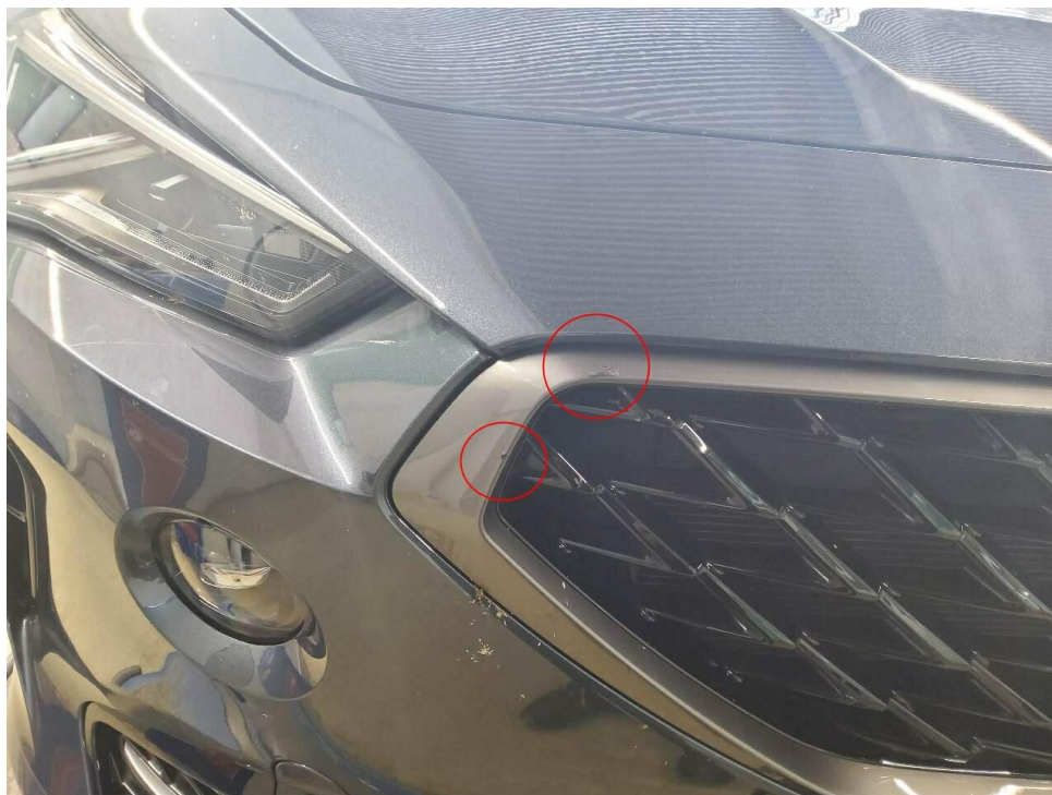
Bild 21 : Zierrahmen Kühlergrill, zerkratzt, Steinschlag
