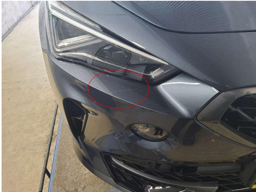
Bild 17 : Stoßfänger vorne, Lackierung, zerkratzt
