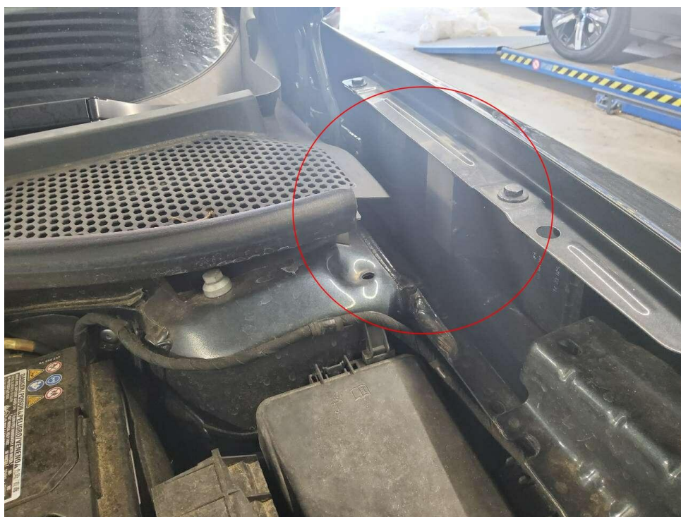
Bild 16 : Dämpfung Motorraum links fehlt links fehlt
