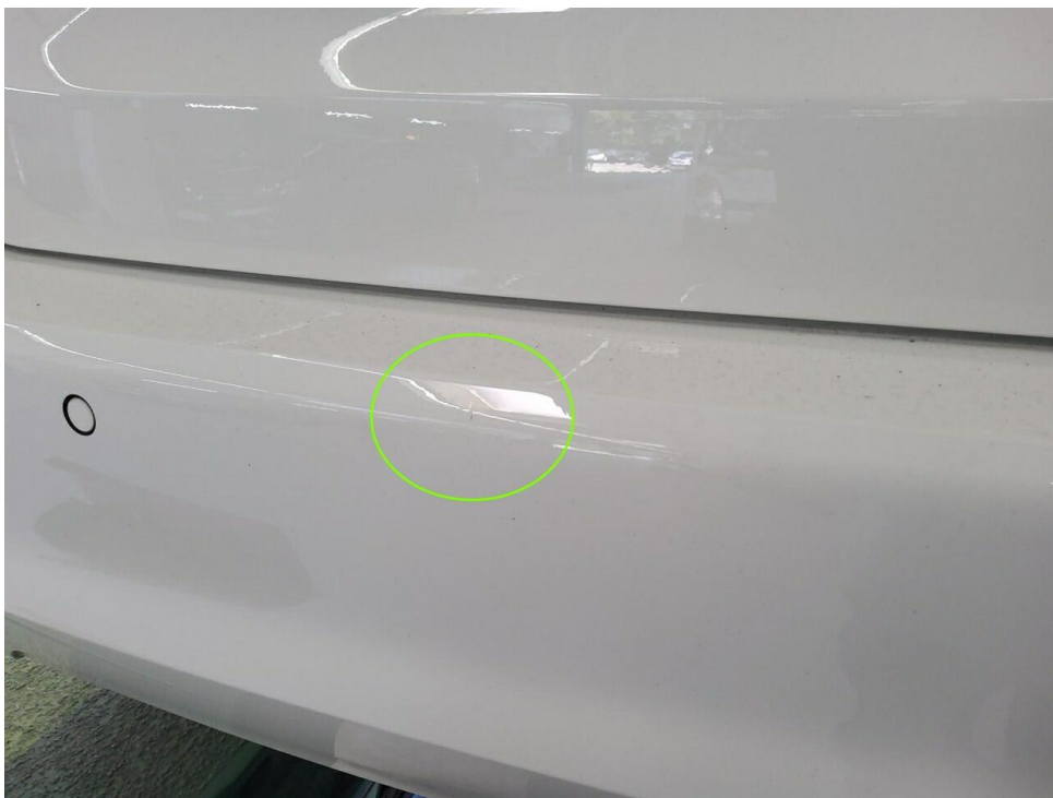
Bild 18 : Stoßfänger hinten Lackierung, zerkratzt, polieren
