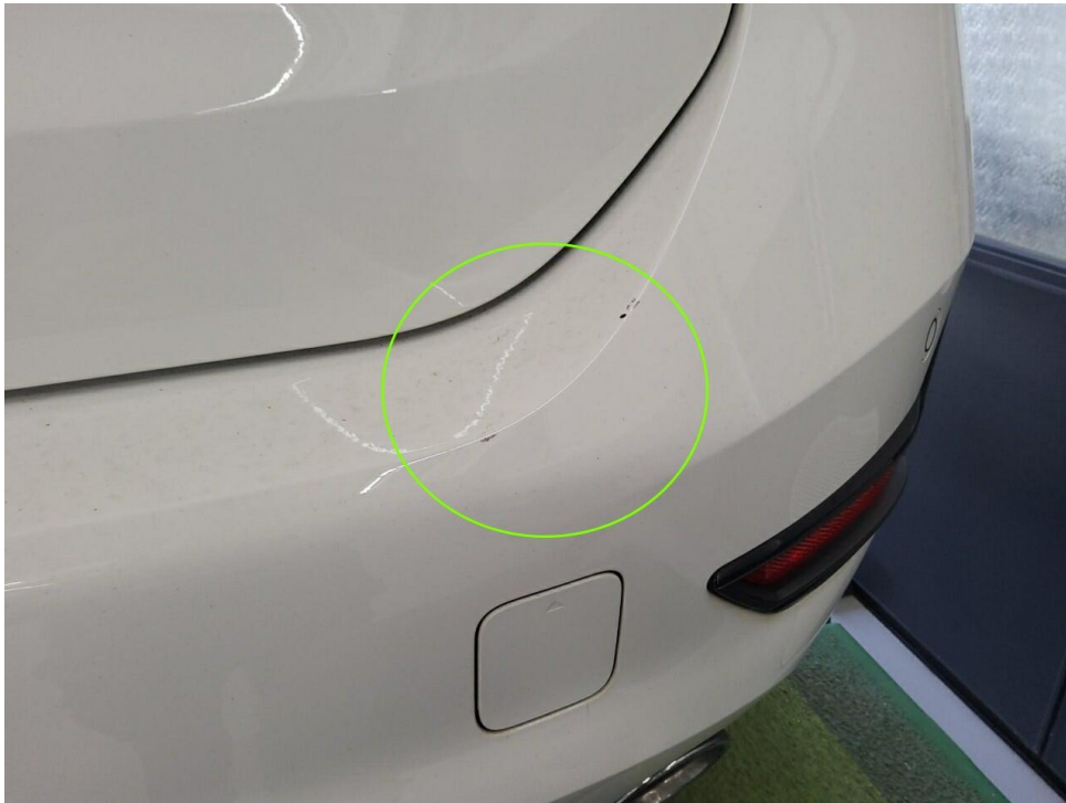
Bild 19 : Stoßfänger hinten Lackierung, zerkratzt, polieren
