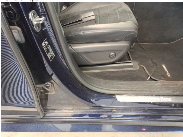
Beschädigung 6: Schweller rechts: Einstieg - Delle / Lackschaden - Smart Repair
