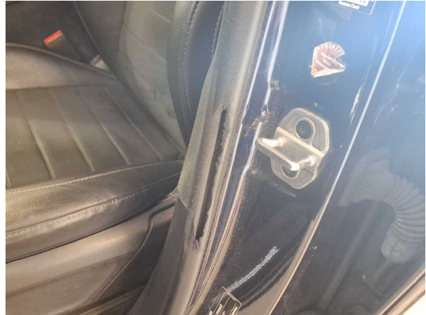
Beschädigung 4: Tür vorn links: Türdichtung - beschädigt - erneuern
