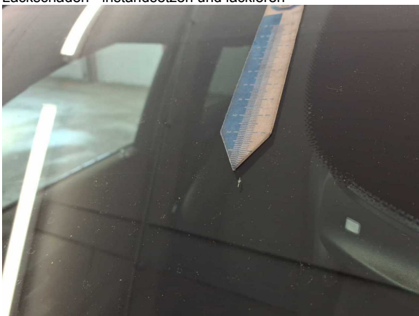
Beschädigung 8: Verglasung: Frontscheibe - Steinschlag - erneuern
