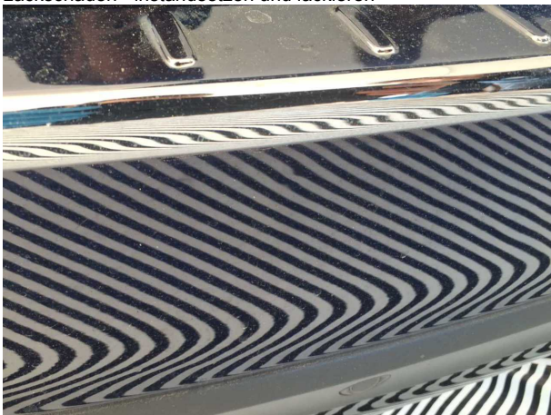
Beschädigung 7: Stossfänger hinten: Stossfänger hinten - Delle / Lackschaden - instandsetzen und lackieren
