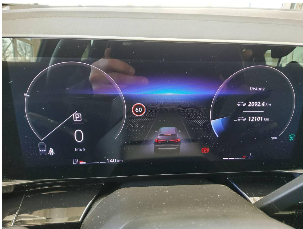
Bild 6 : Kombiinstrument (betriebsbereit) mit Kilometerstand
