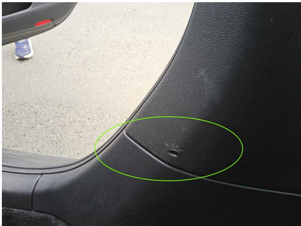
Bild 30 : Seitenverkleidung hinten rechts, Druckstelle
