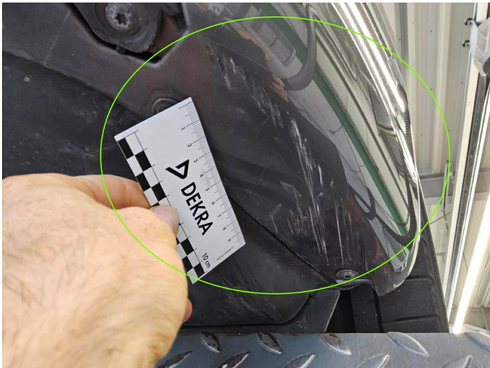
Bild 16 : Stoßfänger vorne Lackierung, zerkratzt, smart repair
