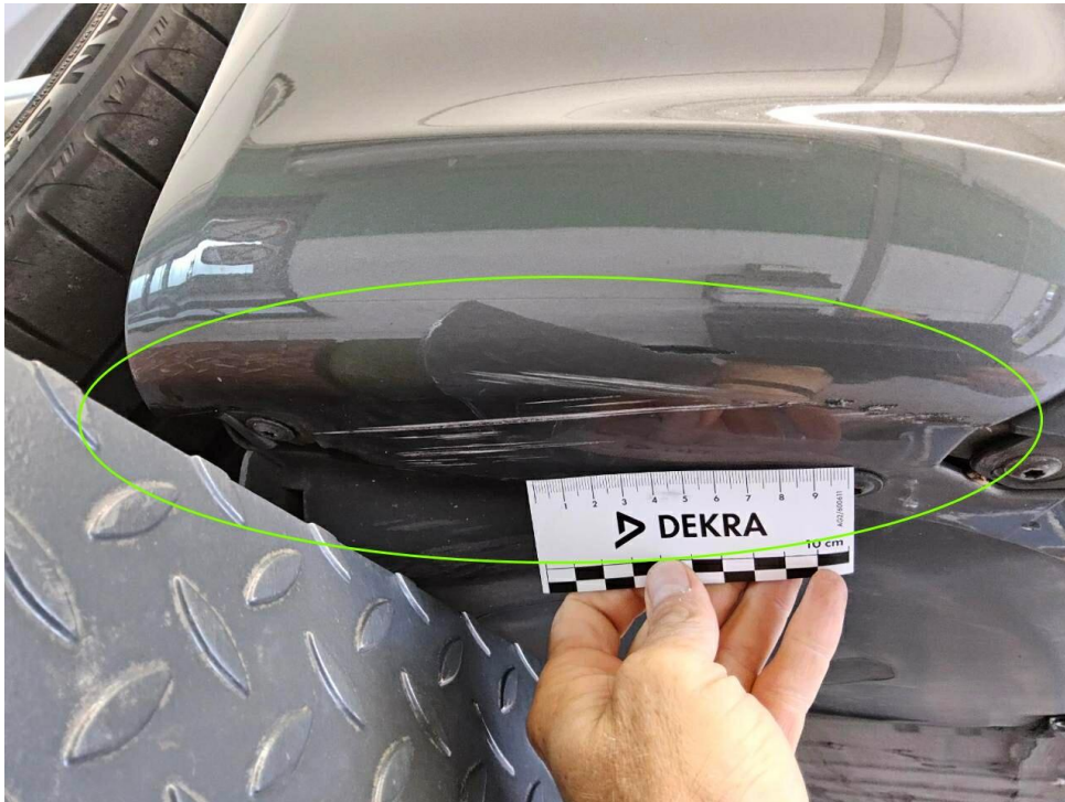
Bild 15 : Stoßfänger vorne Lackierung, zerkratzt, smart repair
