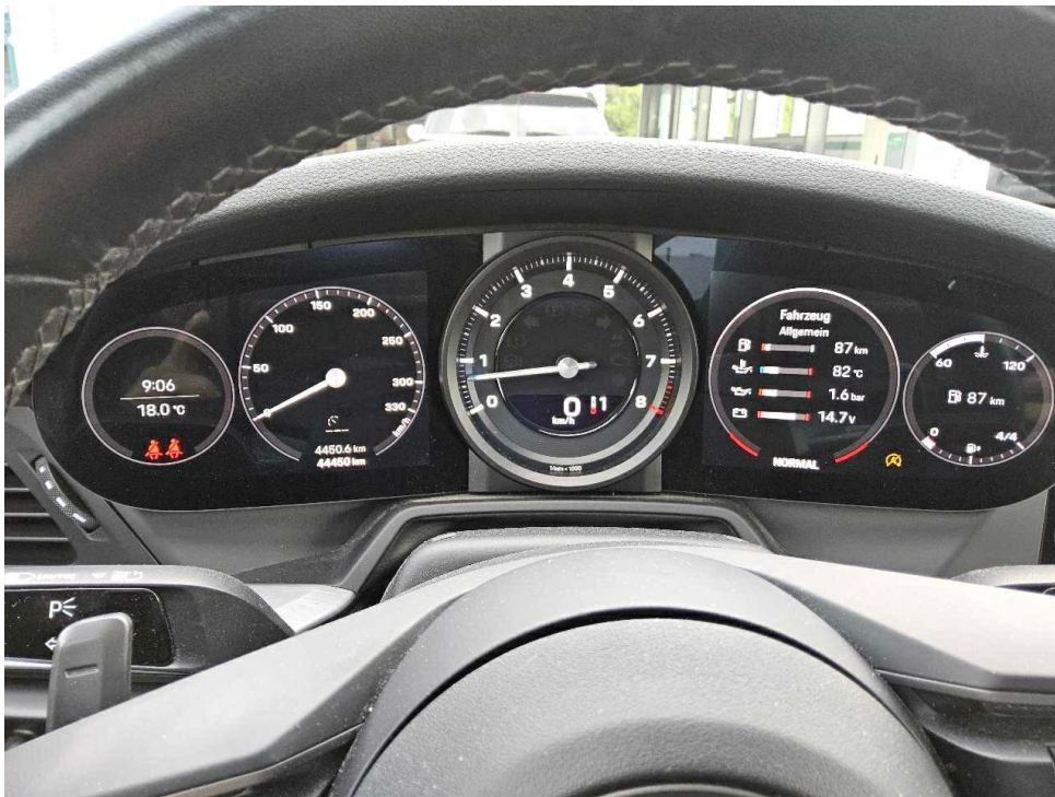
Bild 6 : Kombiinstrument (betriebsbereit) mit Km-Stand
