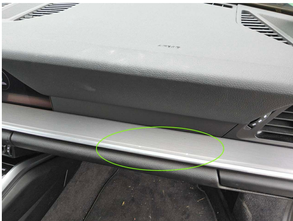
Bild 32 : Zierleiste Armaturenbrett, verschrammt
