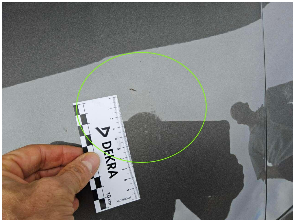
Bild 20 : Motorhaube Lackierung, Umweltschaden, lackieren
