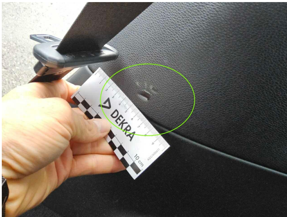
Bild 31 : Seitenverkleidung hinten rechts, Druckstelle
