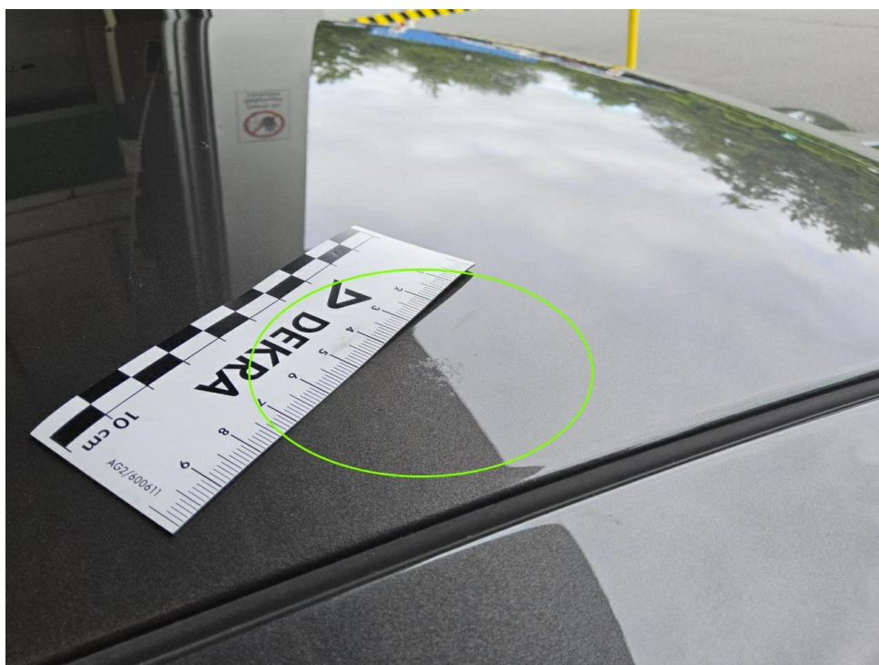
Bild 18 : Dach Lackierung, Umweltschaden, lackieren
