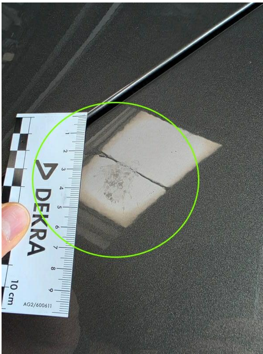
Bild 26 : Kotflügel vorne links Lackierung, Umweltschaden, lackieren
