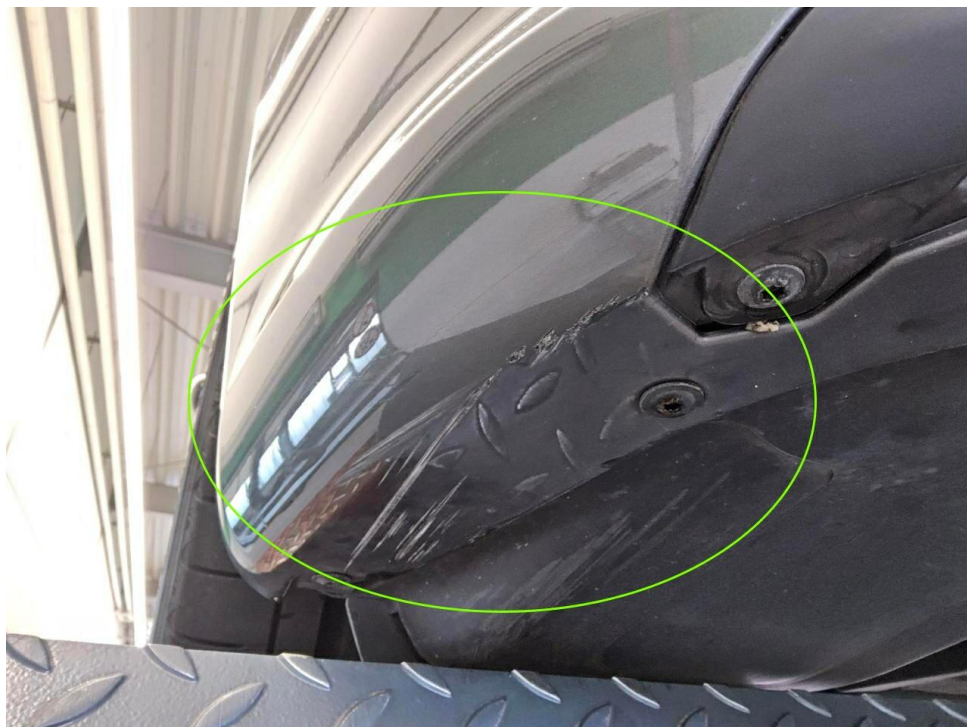
Bild 14 : Stoßfänger vorne Lackierung, zerkratzt, smart repair
