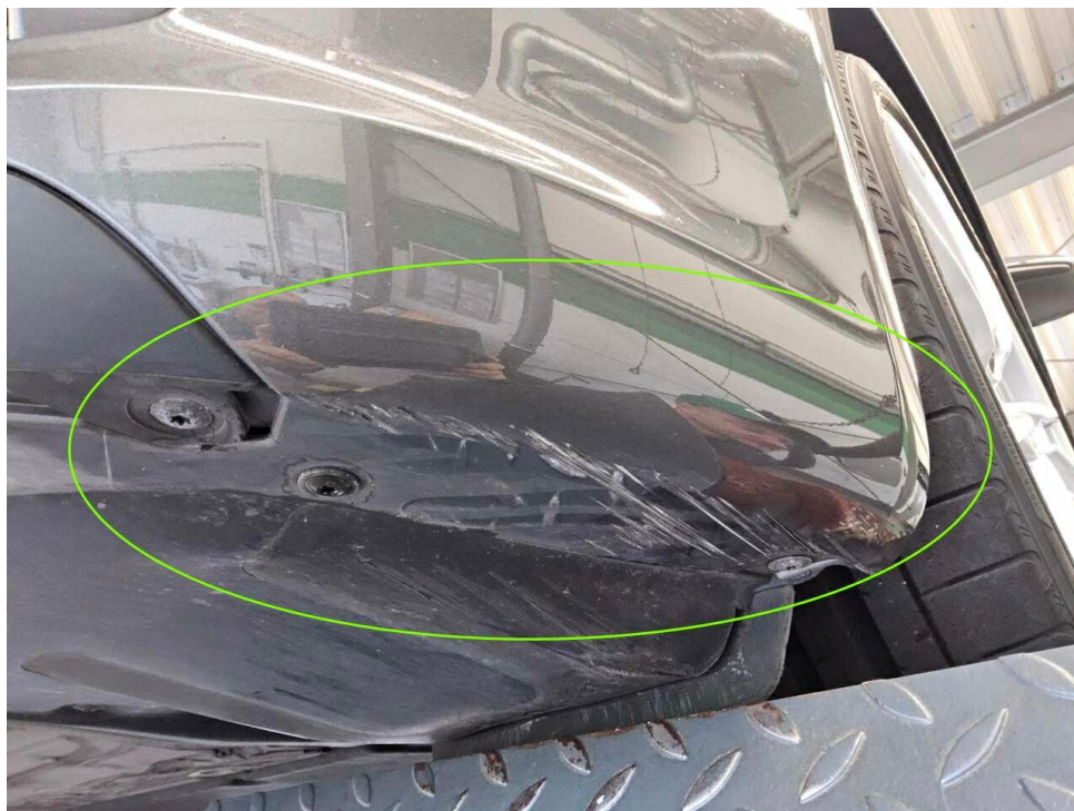
Bild 17 : Stoßfänger vorne Lackierung, zerkratzt, smart repair
