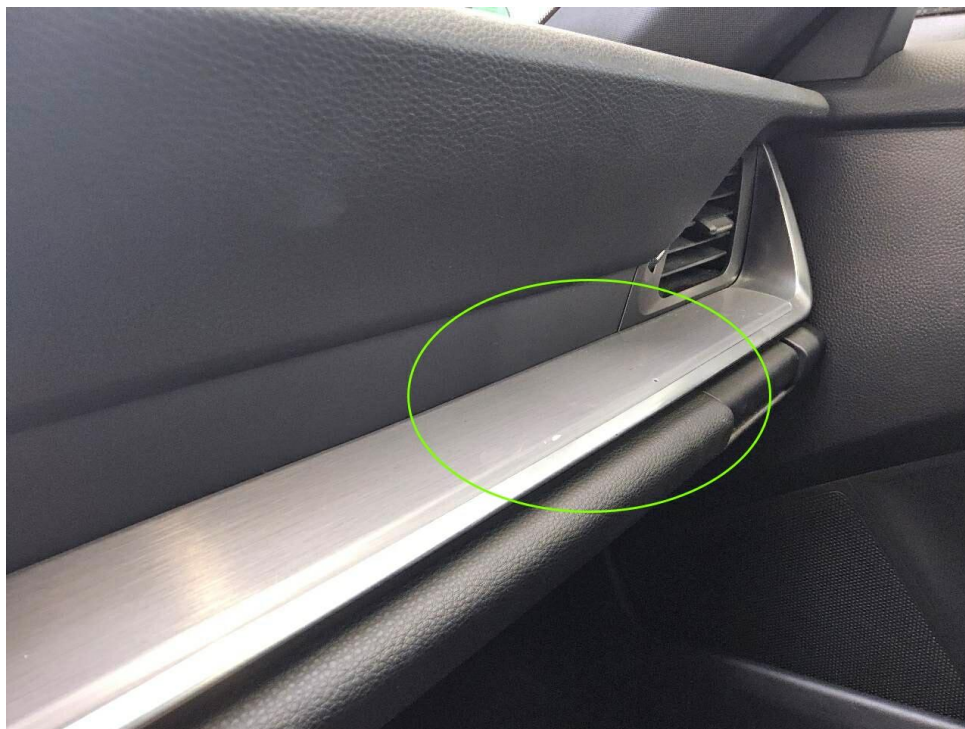
Bild 33 : Zierleiste Armaturenbrett, verschrammt
