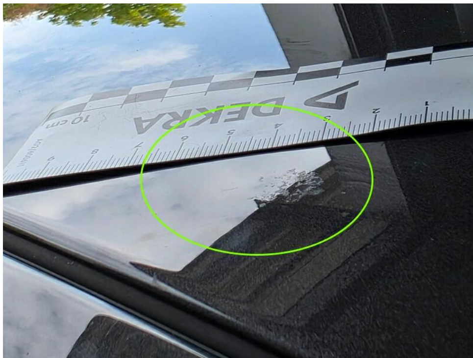
Bild 23 : Dach Lackierung, Umweltschaden, lackieren
