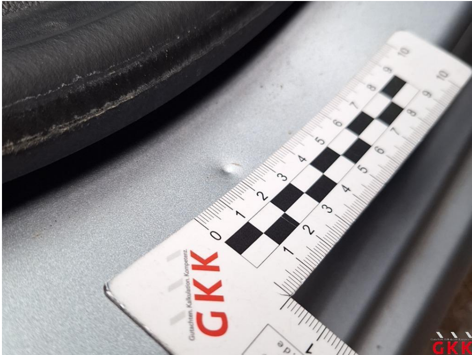
Bild 17. Tür vorne rechts, Einstieg, beschädigt, Smartrepair
