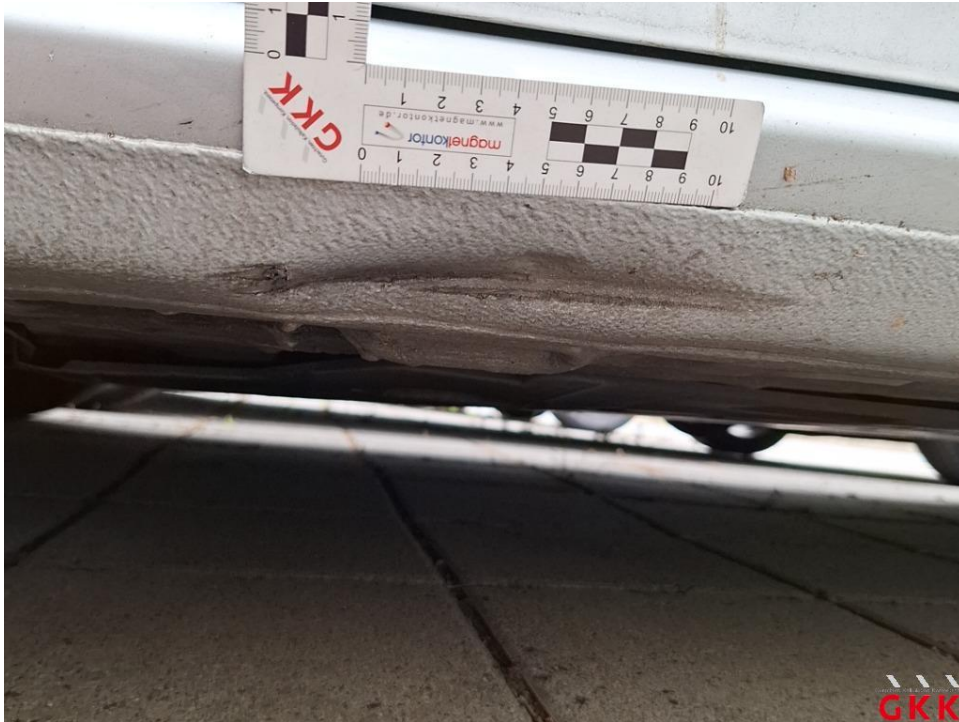
Bild 23. Schweller links, beschädigt, instand setzen - lackieren
