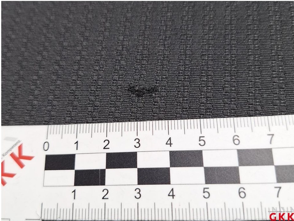
Bild 14. Sitz hinten rechts, Bezug Sitzkissen -Stoff-, gerissen, Smartrepair
