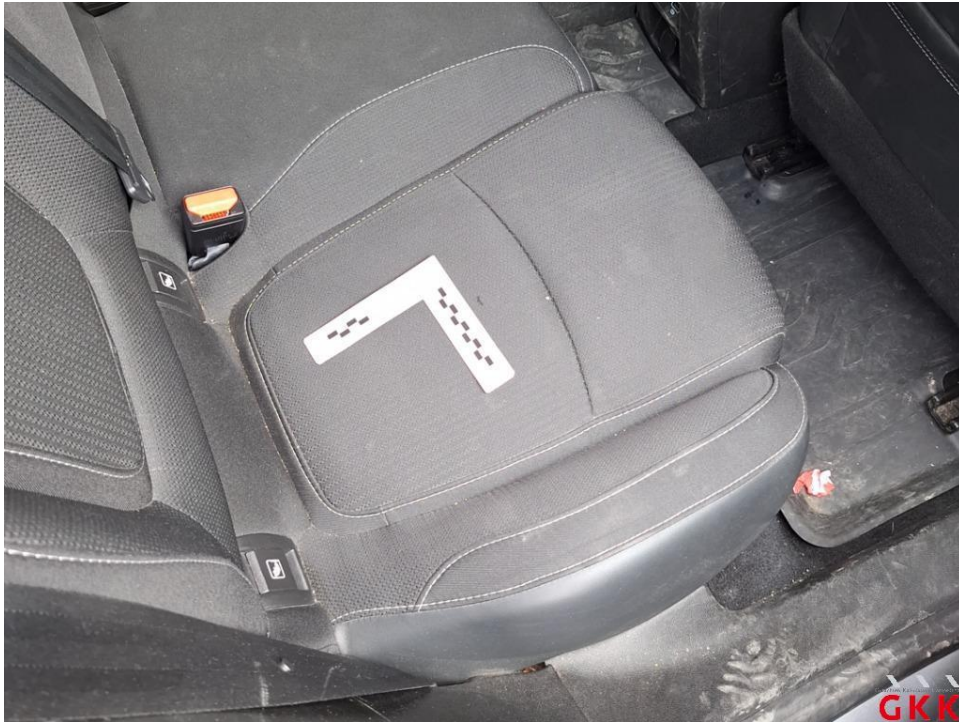
Bild 13. Sitz hinten rechts, Bezug Sitzkissen -Stoff-, gerissen, Smartrepair
