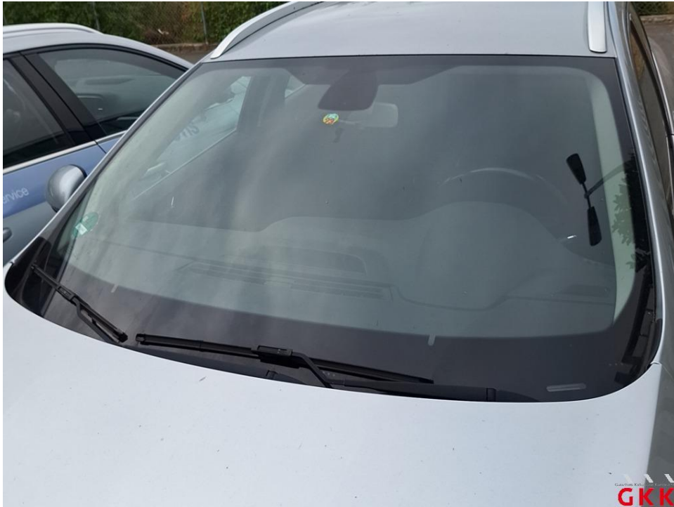
Bild 19. Frontscheibe, mit Regensensor und Frontkamera, Steinschlag mit Rissbildung, ersetzen
