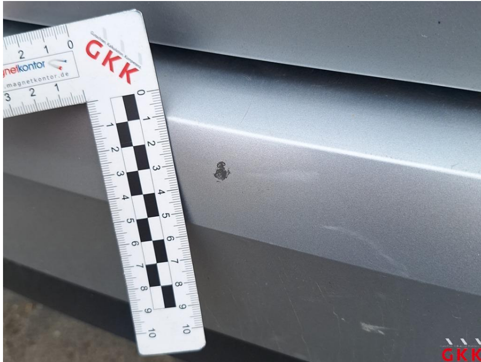
Bild 27. Stoßfänger hinten, Verkleidung -lackiert-, verkratzt, Smartrepair
