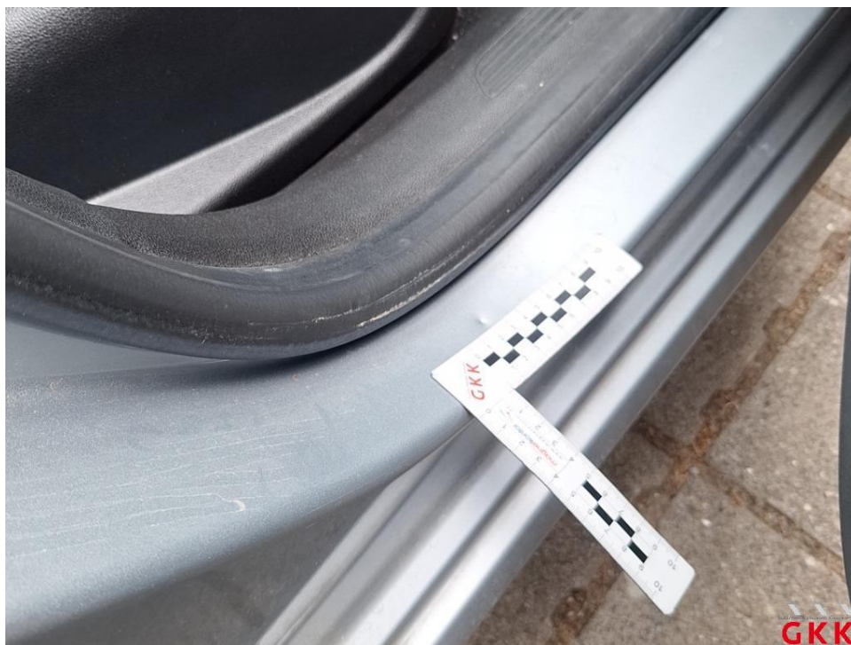
Bild 16. Tür vorne rechts, Einstieg, beschädigt, Smartrepair
