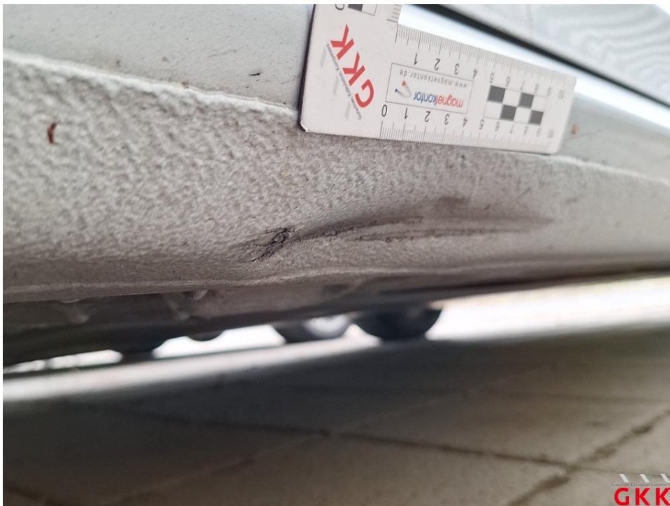
Bild 24. Schweller links, beschädigt, instand setzen - lackieren
