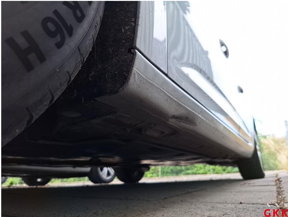
Bild 22. Schweller links, beschädigt, instand setzen - lackieren
