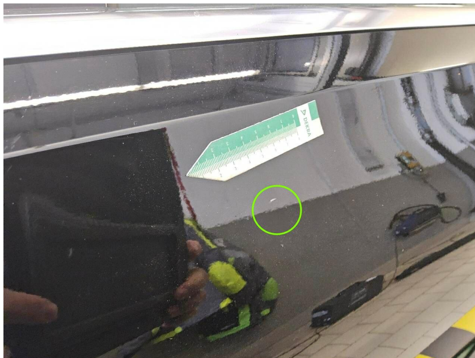
Bild 14 : Tür hinten links Lackierung, verschrämmt
