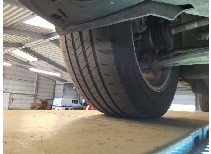
Damage 4: Wheel / tyres: Tyre - front (einseitig abgefahren) - does not meet manufacturer specifications - Replace
