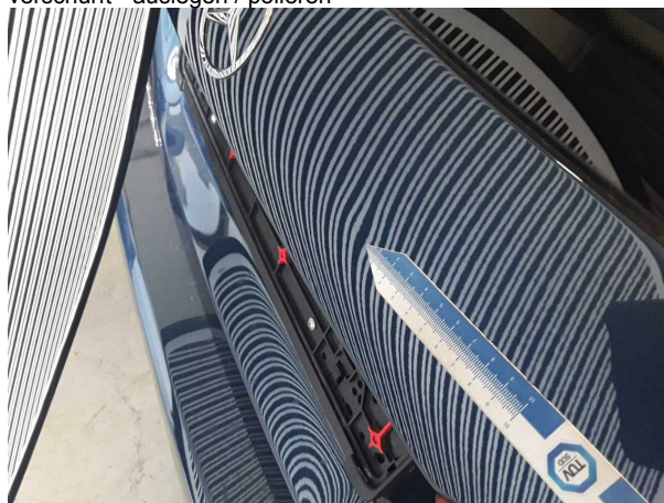
Beschädigung #2: Heckklappe/-tür: Heckklappe - Delle(n) - sanft instandsetzen
