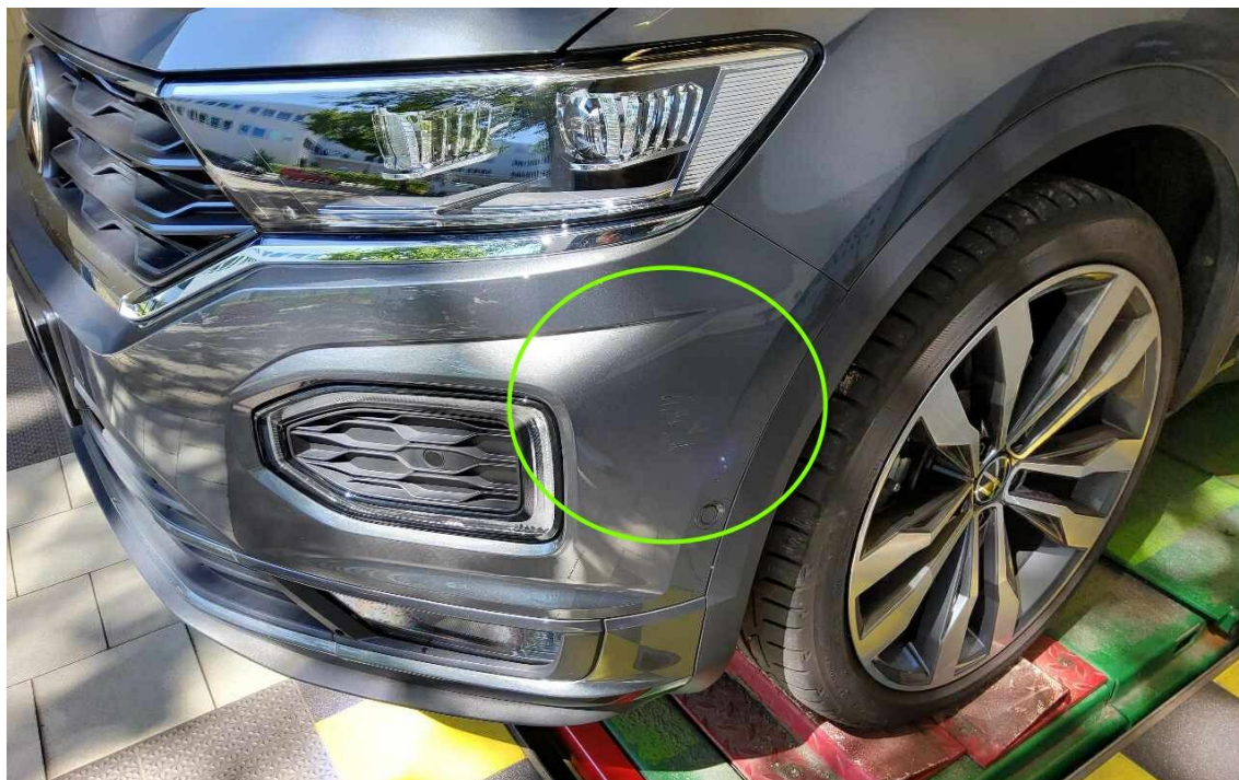
Bild 23 : Stoßfänger vorne Lackierung, zerkratzt, smart repair
