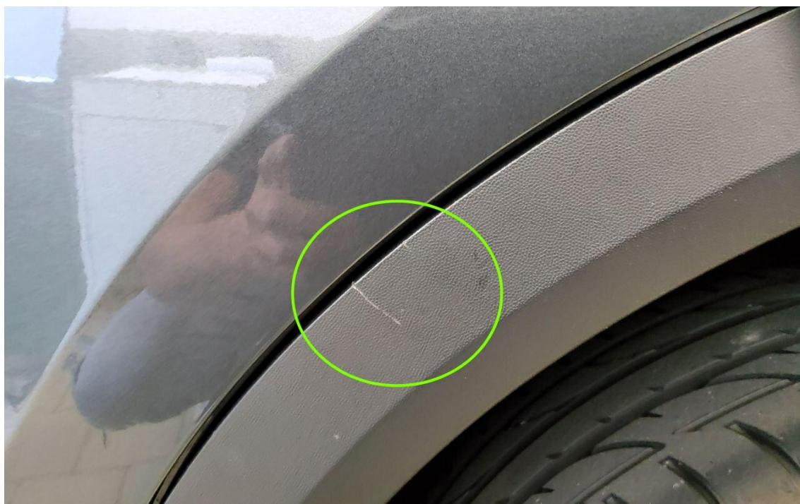
Bild 16 : Radlaufblende hinten links zerschrammt
