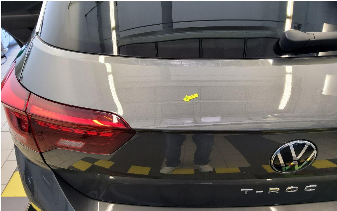
Bild 21 : Heckklappe, eingedellt, drücken
