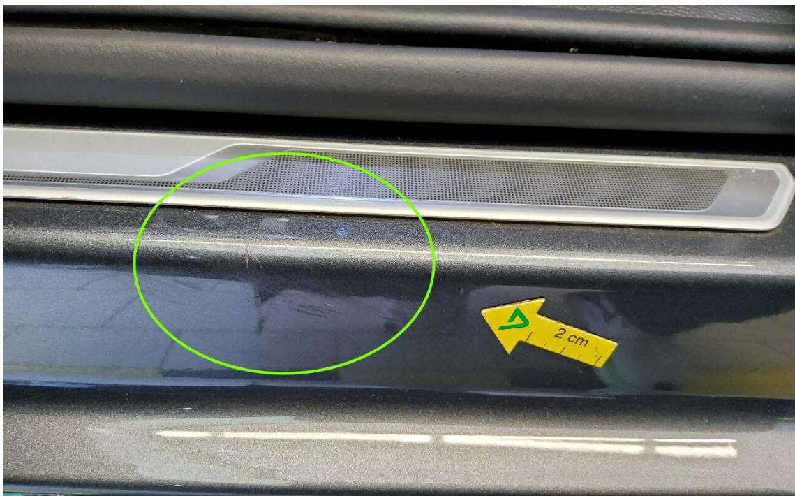
Bild 20 : Tür vorne links Einstieg Lackierung, zerkratzt, smart repair
