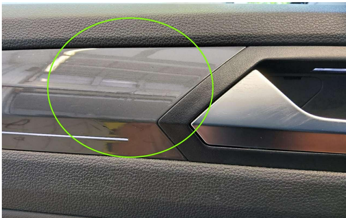
Bild 15 : Zieblende Innen Tür vorne links zerkratzt
