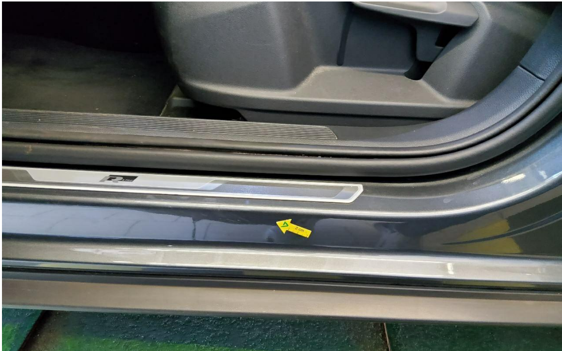
Bild 19 : Tür vorne links Einstieg Lackierung, zerkratzt, smart repair
