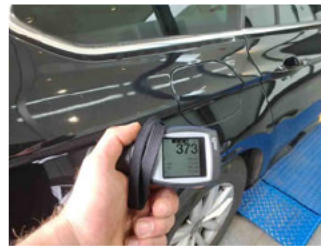
Lackstärke Seitenwand hinten rechts
