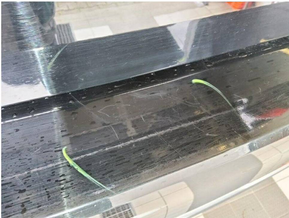
Bild 30 : Heckstoßfängerverkleidung / Ladekante diverse oberflächige Kratzer
