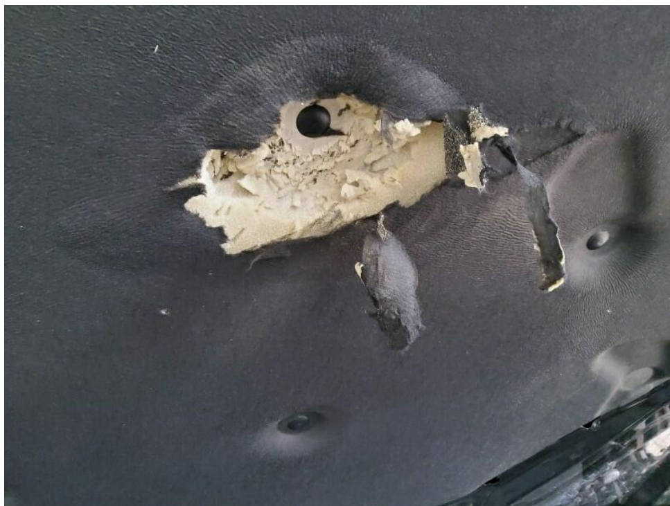
Bild 16 : Motordämmung / Schallisolierung beschädigt
