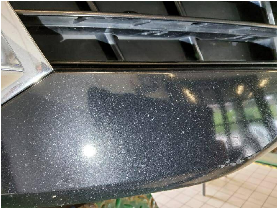
Bild 35 : Frontstoßfängerverkleidung diverse Steinschläge sowie rechts Verschrammung
