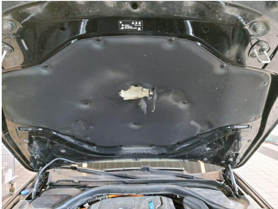
Bild 15 : Motordämmung / Schallisolierung beschädigt
