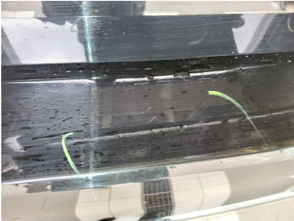
Bild 31 : Heckstoßfängerverkleidung / Ladekante diverse oberflächige Kratzer
