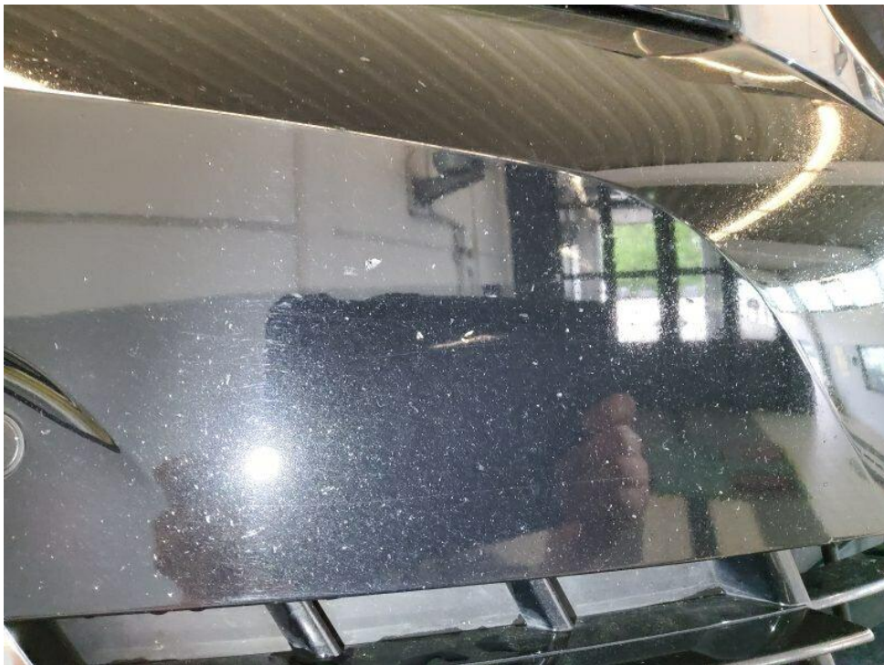
Bild 36 : Frontstoßfängerverkleidung diverse Steinschläge sowie rechts Verschrammung
