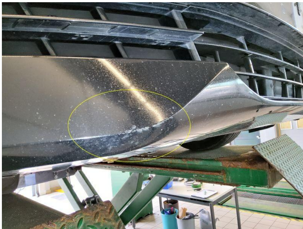
Bild 34 : Frontstoßfängerverkleidung diverse Steinschläge sowie rechts Verschrammung
