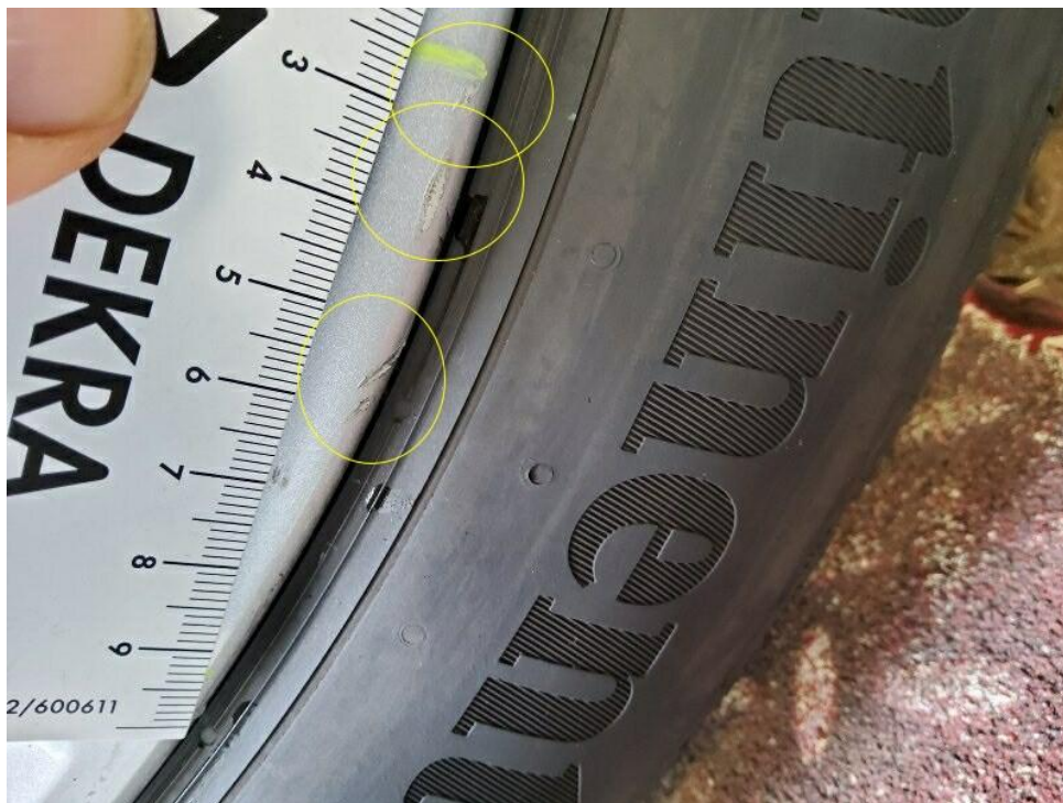
Bild 27 : Leichtmetallfelge Sommer hinten rechts umlaufende Kratzer - nach Herstellervorlage aufbereiten
