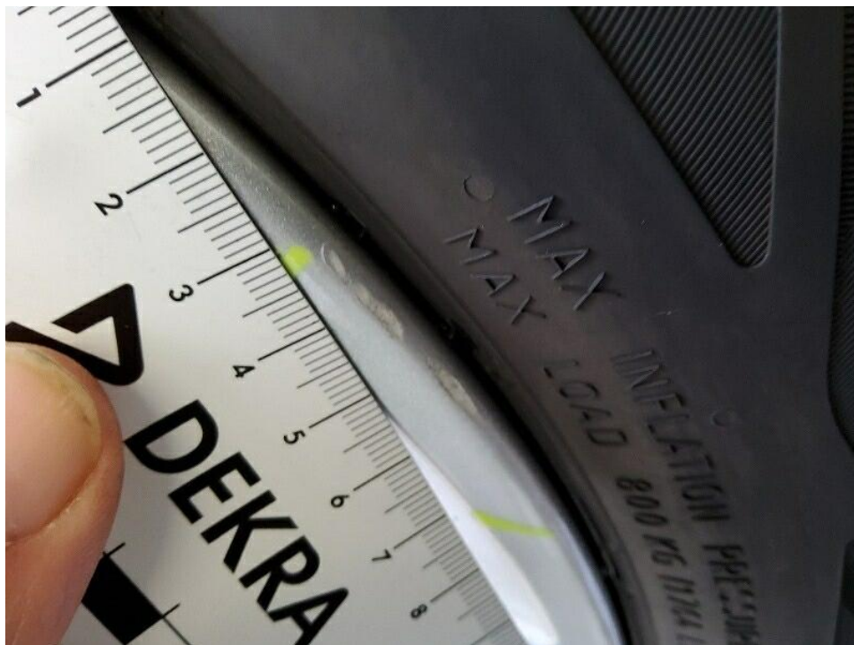
Bild 25 : Leichtmetallfelge Sommer hinten rechts umlaufende Kratzer - nach Herstellervorlage aufbereiten
