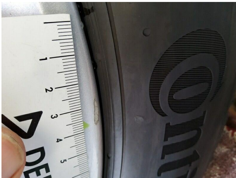
Bild 26 : Leichtmetallfelge Sommer hinten rechts umlaufende Kratzer - nach Herstellervorlage aufbereiten
