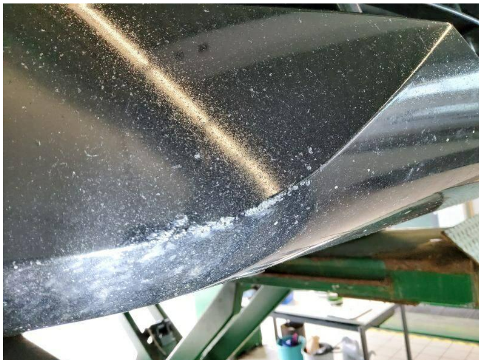
Bild 40 : Frontstoßfängerverkleidung diverse Steinschläge sowie rechts Verschrammung
