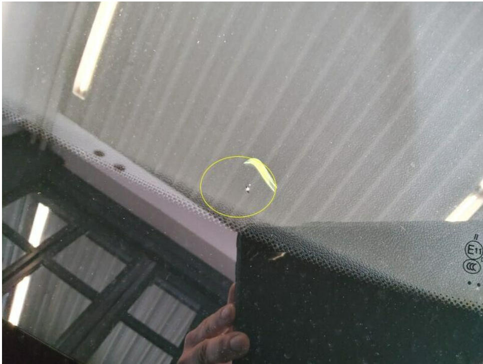
Bild 21 : Frontscheibe kleine Abplatzungen
