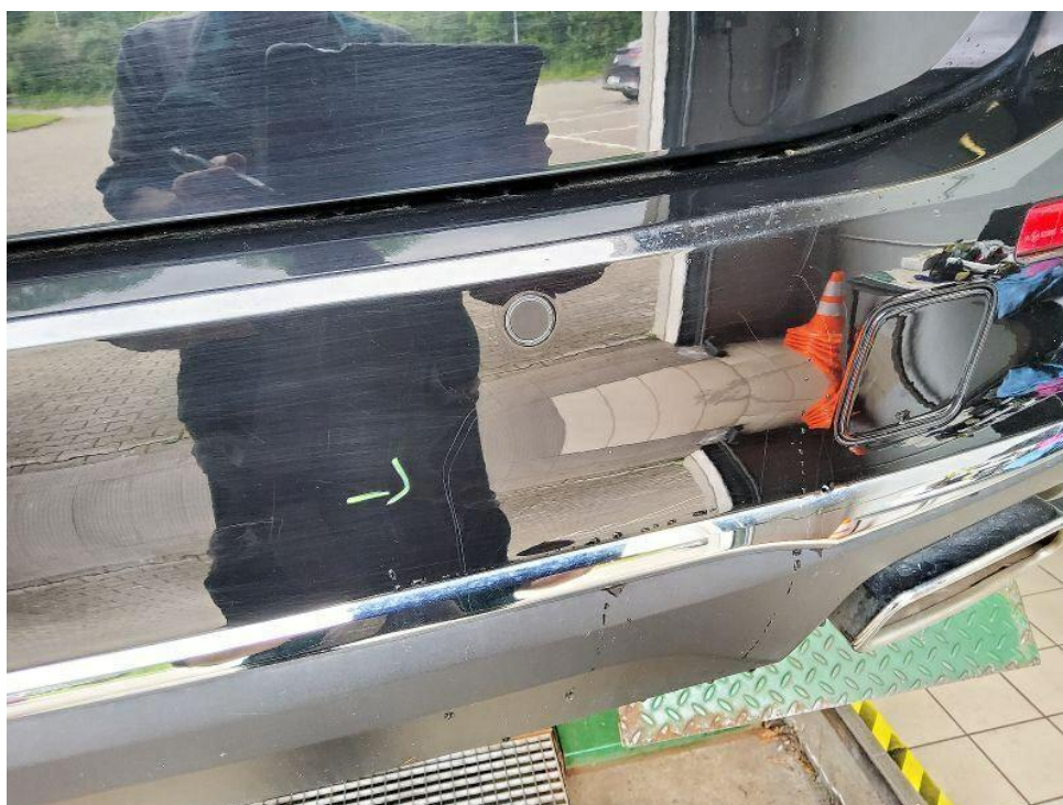
Bild 28 : Heckstoßfängerverkleidung / Ladekante diverse oberflächige Kratzer
