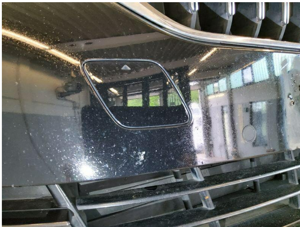
Bild 37 : Frontstoßfängerverkleidung diverse Steinschläge sowie rechts Verschrammung
