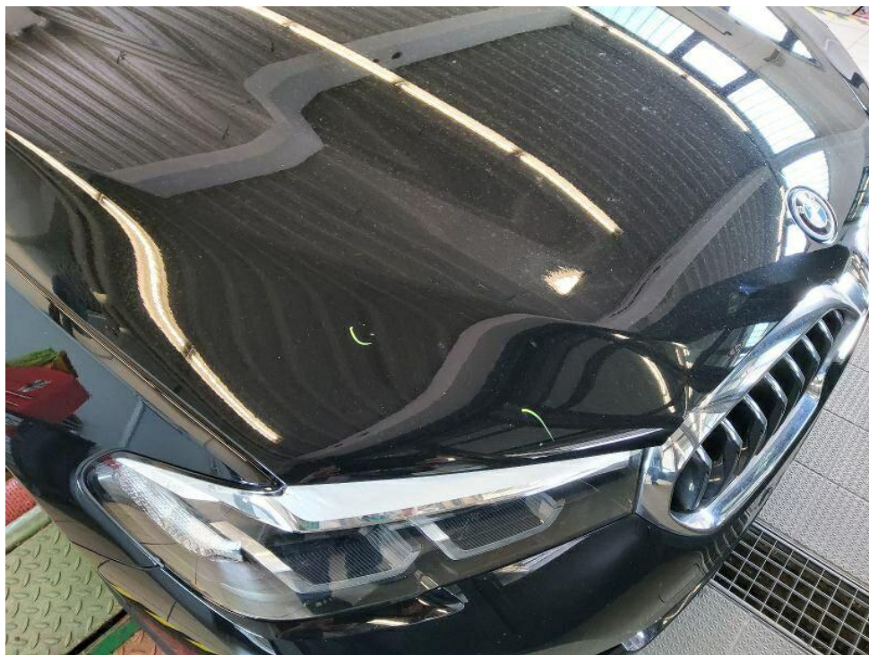
Bild 18 : Fahrzeugfront mit laufleistungsbedingter Steinschlagbelastung
