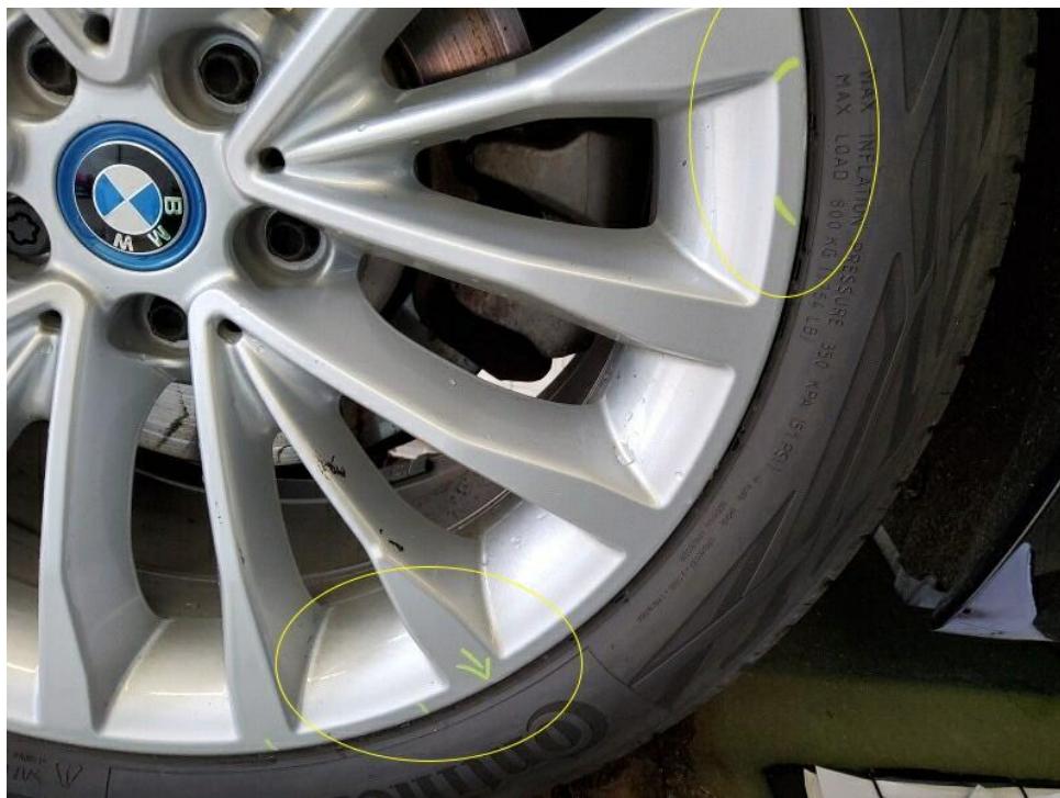
Bild 24 : Leichtmetallfelge Sommer hinten rechts umlaufende Kratzer - nach Herstellervorlage aufbereiten
