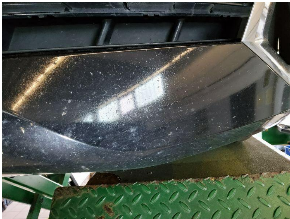
Bild 39 : Frontstoßfängerverkleidung diverse Steinschläge sowie rechts Verschrammung
