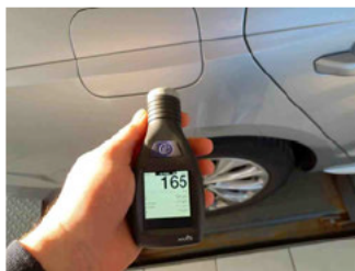
Lackstärke Seitenwand hinten rechts
