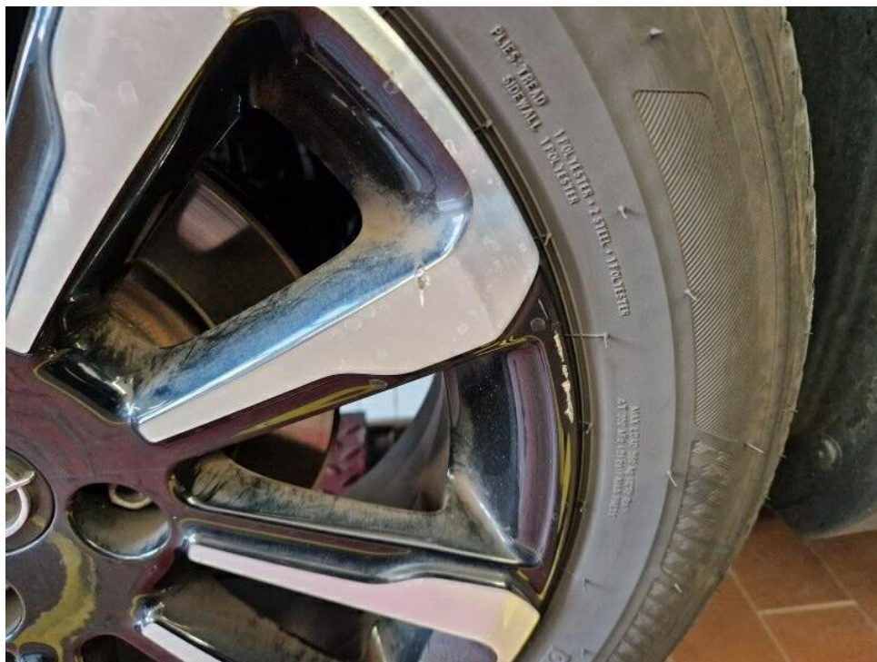
Bild 16 : Leichtmetallfelge vorn links verschrammt, erneuern
