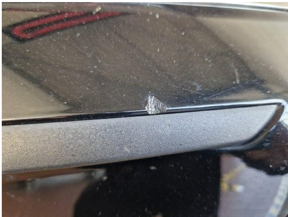
Bild 17 : Stoßfänger vorn rechts eingekerbt, instandsetzen und lackieren mit Lackaufbau
