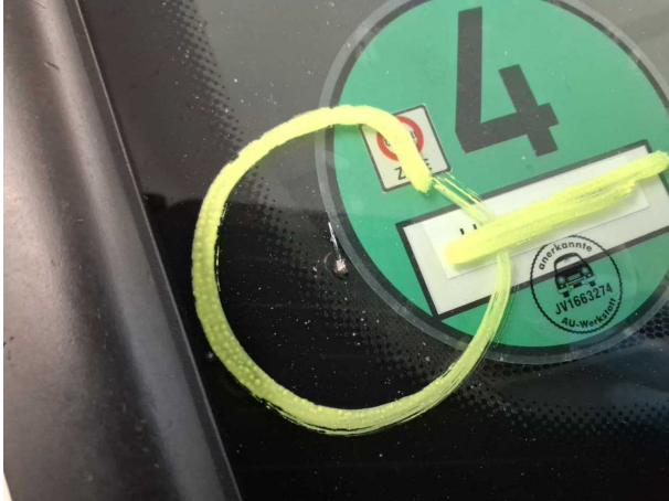
Beschädigung #6: Verglasung: Frontscheibe - Steinschlag - erneuern
