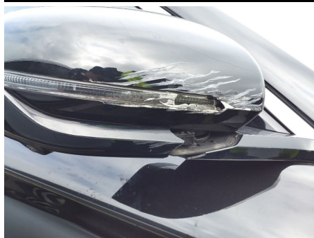
Retrovisore elettrico / Destro / Rotto
