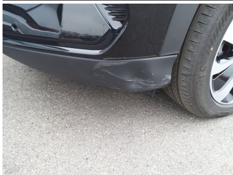
Modanatura paraurti / Anteriore Sinistro / Ammaccato vernice incisa
