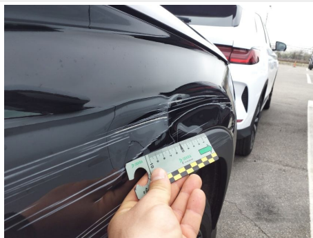
Parafango / Anteriore Destro / Ammaccato vernice incisa
