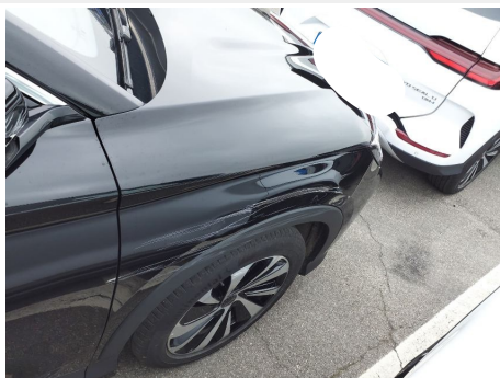
Parafango / Anteriore Destro / Ammaccato vernice incisa
