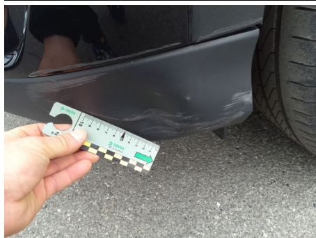
Modanatura paraurti / Anteriore Sinistro / Ammaccato vernice incisa
