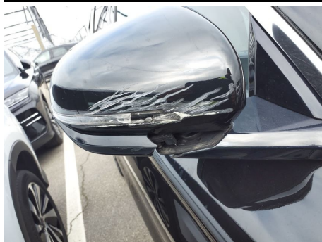
Retrovisore elettrico / Destro / Rotto
