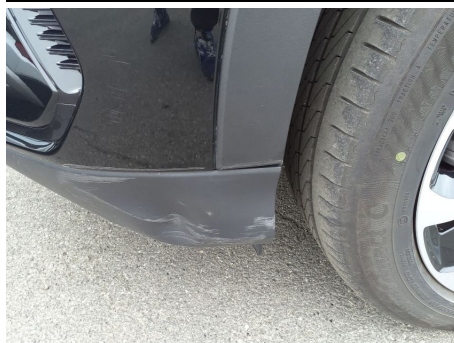
Modanatura parafrangente / Anteriore Sinistro / Riga
