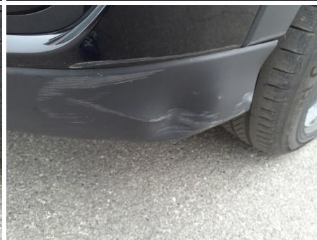
Modanatura paraurti / Anteriore Sinistro / Ammaccato vernice incisa
