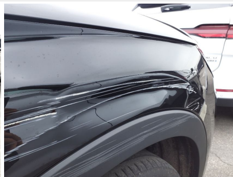
Parafango / Anteriore Destro / Ammaccato vernice incisa
