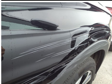
Parafango / Anteriore Destro / Ammaccato vernice incisa
