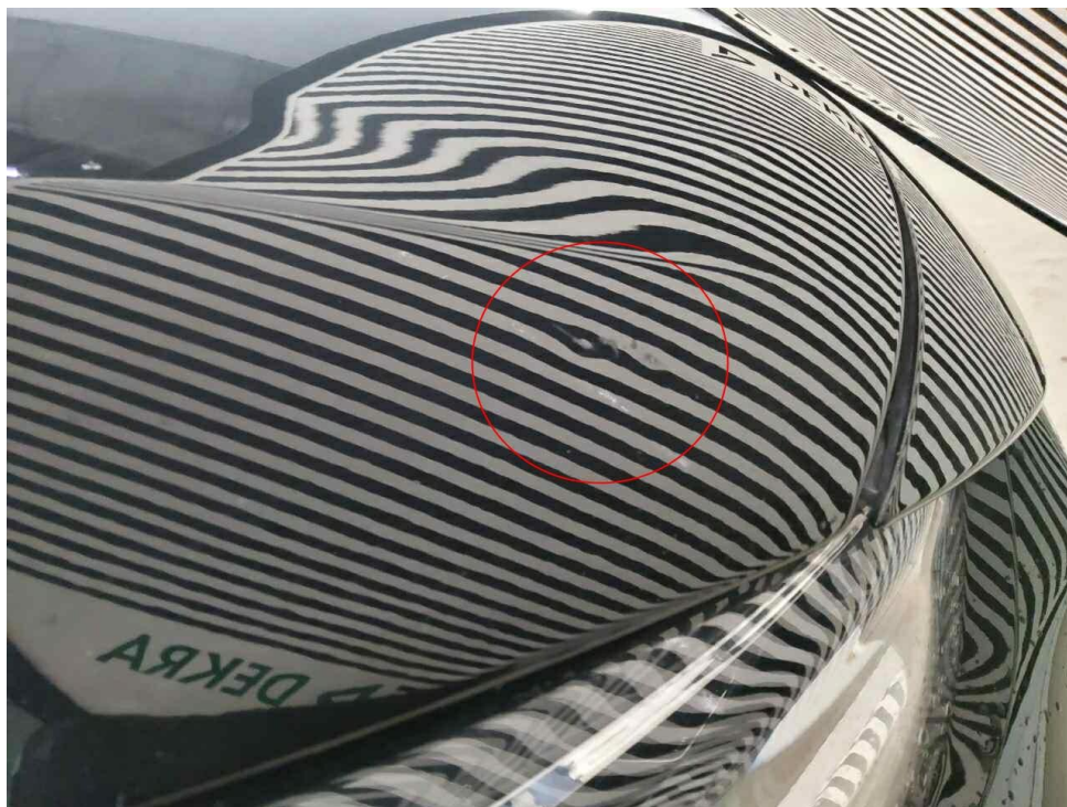
Bild 16 : Motorhaube, eingedellt, instandsetzen und lackieren mit Lackaufbau
