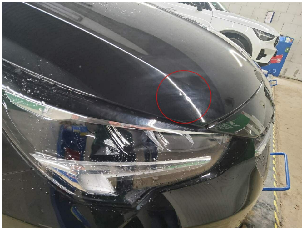
Bild 14 : Motorhaube, eingedellt, instandsetzen und lackieren mit Lackaufbau
