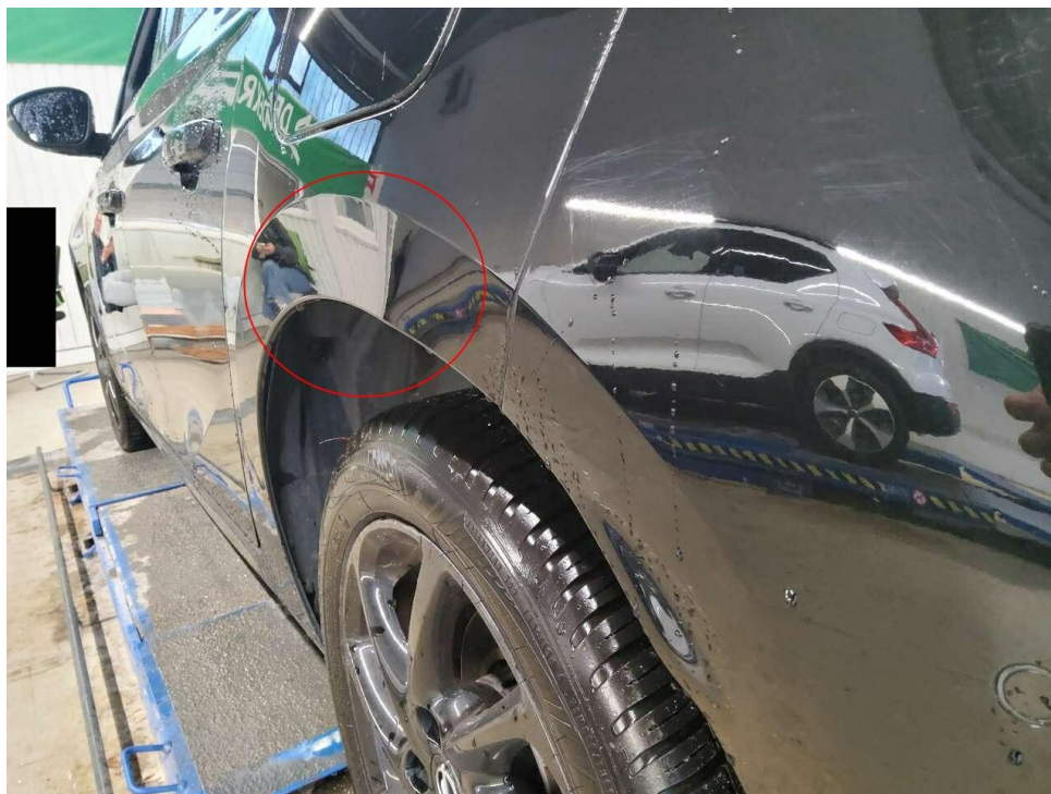
Bild 17 : Seitenteil hinten links, verformt, instandsetzen und lackieren mit Lackaufbau
