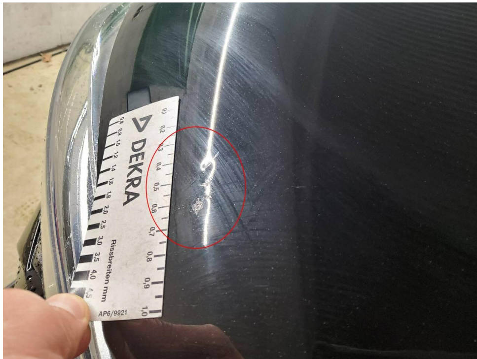
Bild 15 : Motorhaube, eingedellt, instandsetzen und lackieren mit Lackaufbau
