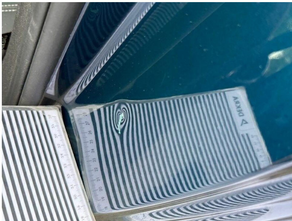
Bild 20 : Türeinstieg hinten links eingedellt und verkratzt
