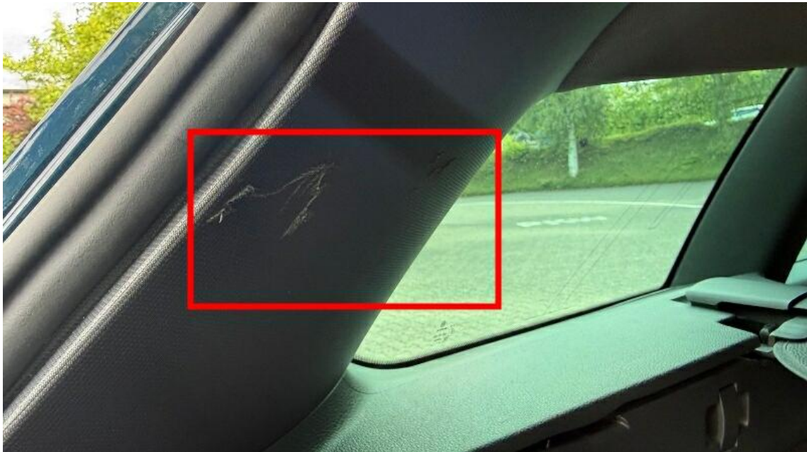
Bild 22 : D-Säulenverkleidung links innen stark verschrammt
