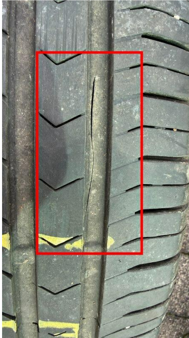
Bild 23 : 1 x Sommerreifen in der Lauffläche beschädigt
