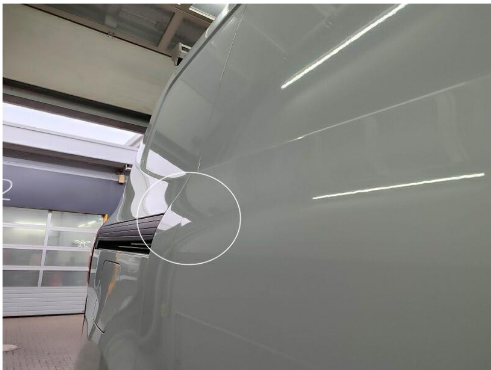
Bild 18 : Tür hinten rechts hat eine Delle
