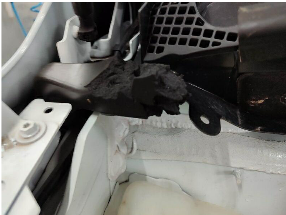
Bild 14 : Motorraum hat Marderspuren
