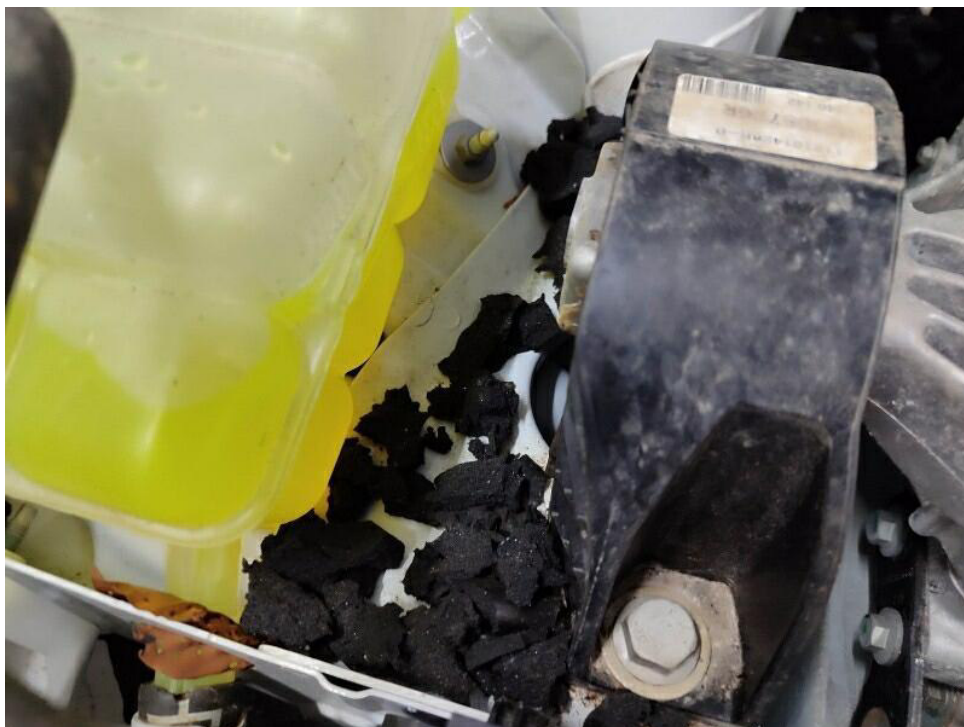
Bild 13 : Motorraum hat Marderspuren
