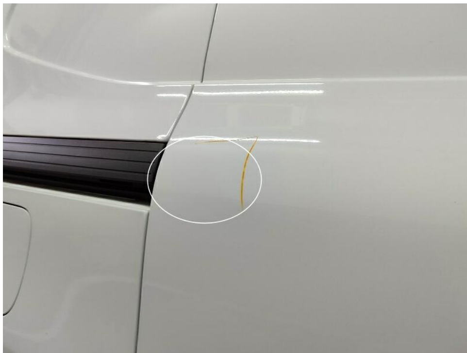
Bild 19 : Tür hinten rechts hat eine Delle
