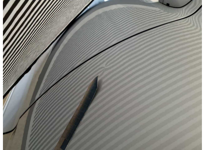
Damage 4: Door - rear left side: Door (Beule, spitz) - dent(s) - Smooth repair work
