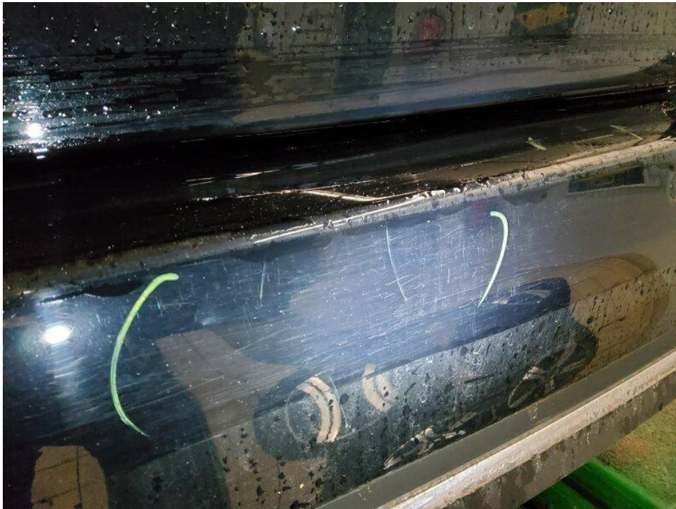
Bild 17 : Heckstoßfängerverkleidung / Ladekante mehrere oberflächige Kratzer
