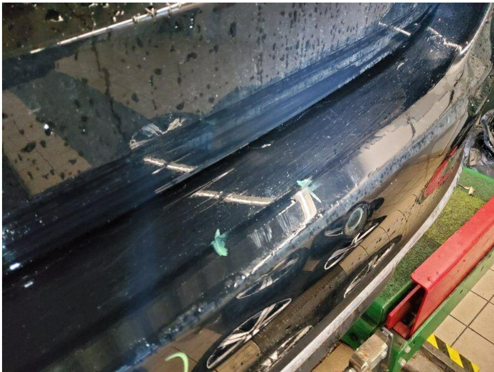
Bild 18 : Heckstoßfängerverkleidung / Ladekante mehrere oberflächige Kratzer
