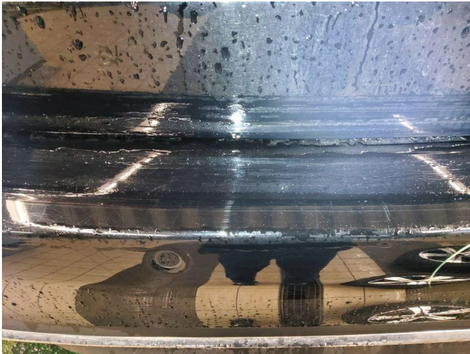
Bild 19 : Heckstoßfängerverkleidung / Ladekante mehrere oberflächige Kratzer
