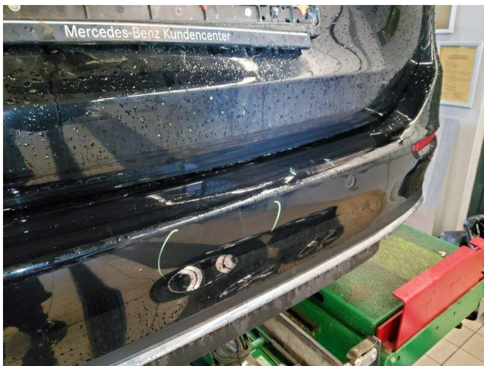
Bild 16 : Heckstoßfängerverkleidung / Ladekante mehrere oberflächige Kratzer
