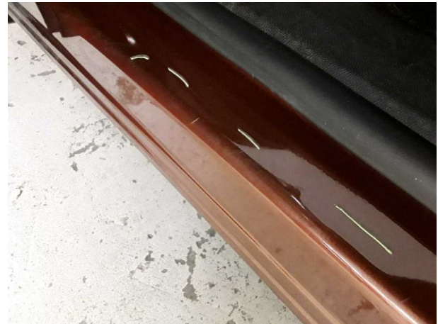
Beschädigung #5: Seitenwand links: Einstieg - Delle / Lackschaden - instandsetzen und lackieren
