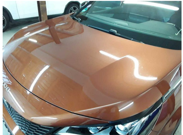
Beschädigung #10: Motorhaube: Motorhaube - verkratzt / verschürft - instandsetzen und lackieren
