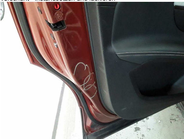
Beschädigung #8: Tür hinten links: Tür - Delle(n) - instandsetzen und lackieren
