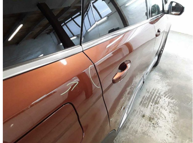
Beschädigung #2: Seitenwand rechts: Seitenwand - Delle(n) - sanft instandsetzen
