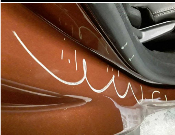
Beschädigung #6: Seitenwand rechts: Einstieg - Delle / Lackschaden - instandsetzen und lackieren
