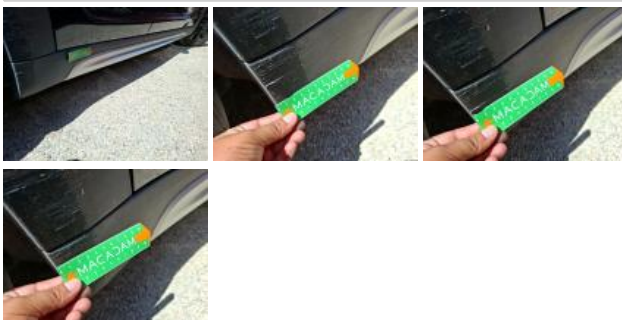
Door trim RR, Scratch(es), Replace
