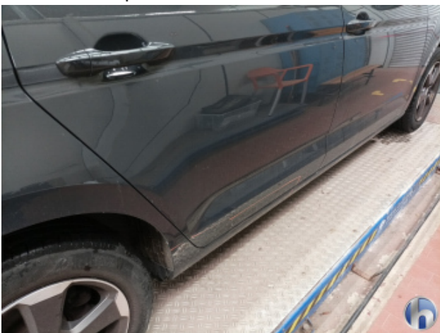
4. Schweller - Rechts Unfallschaden - Lackieren
