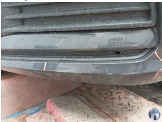
1. Frontspoiler Beschädigt - Erneuern
