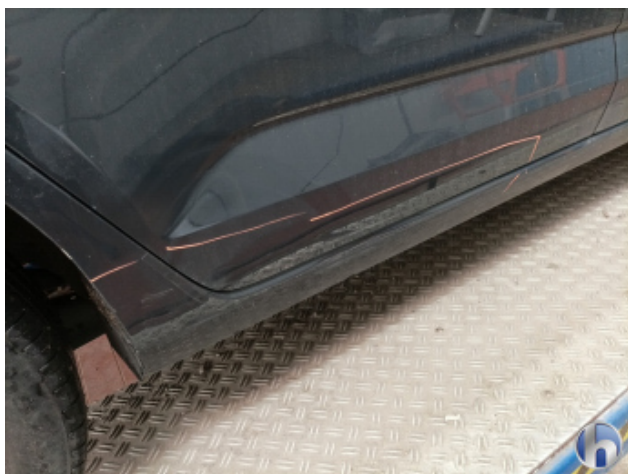
4. Schweller - Rechts Unfallschaden - Lackieren
