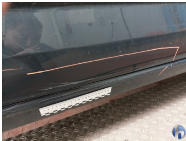
4. Schweller - Rechts Unfallschaden - Lackieren
