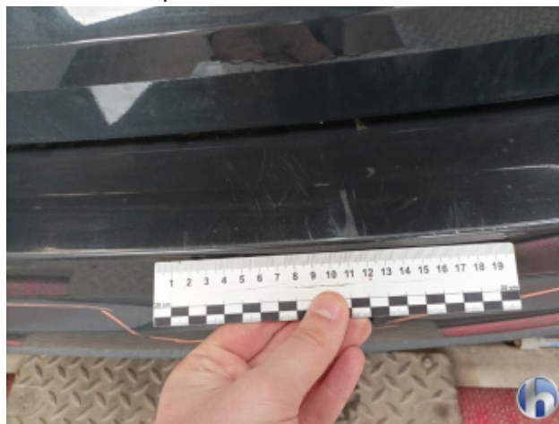
3. Stoßfänger Hinten Kratzer - Smart Repair
