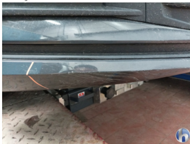
1. Frontspoiler Beschädigt - Erneuern
