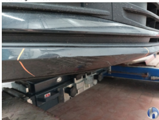
1. Frontspoiler Beschädigt - Erneuern
