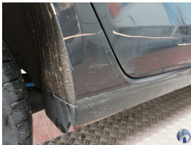
4. Schweller - Rechts Unfallschaden - Lackieren
