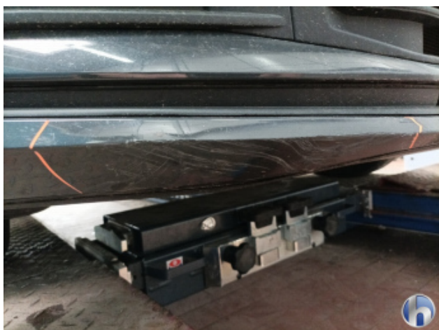
1. Frontspoiler Beschädigt - Erneuern
