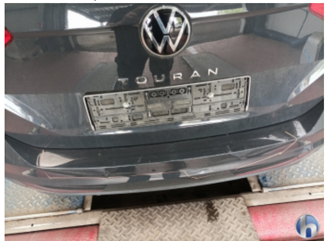
3. Stoßfänger Hinten Kratzer - Smart Repair
