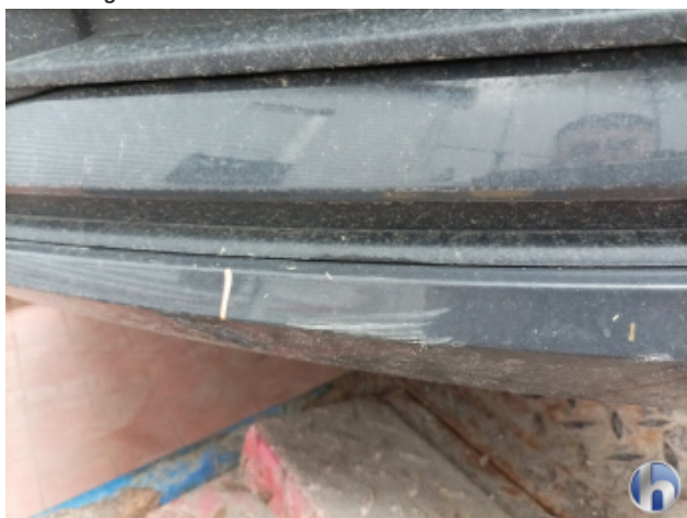
1. Frontspoiler Beschädigt - Erneuern
