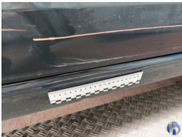
4. Schweller - Rechts Unfallschaden - Lackieren
