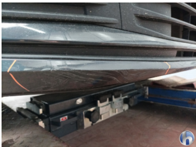
1. Frontspoiler Beschädigt - Erneuern
