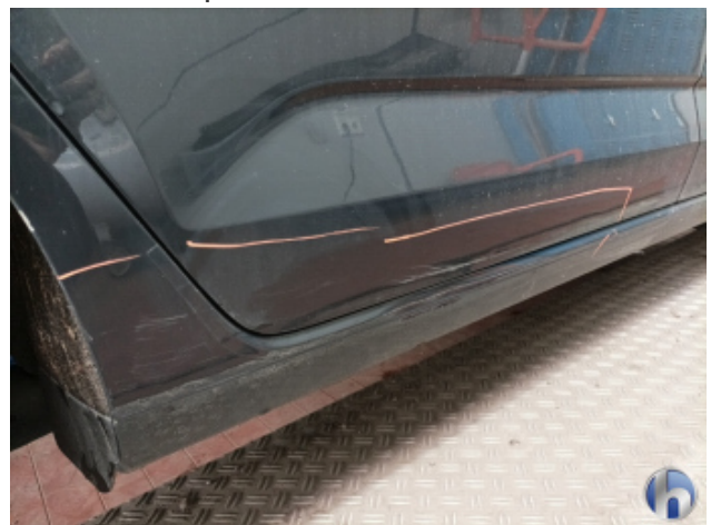
4. Schweller - Rechts Unfallschaden - Lackieren
