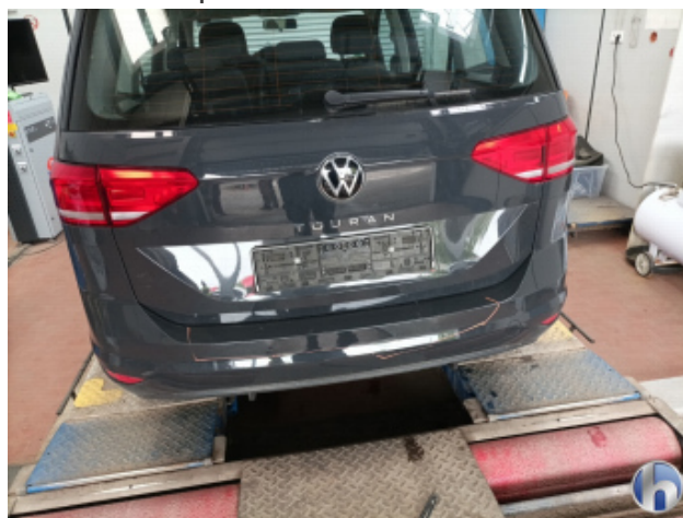
3. Stoßfänger Hinten Kratzer - Smart Repair
