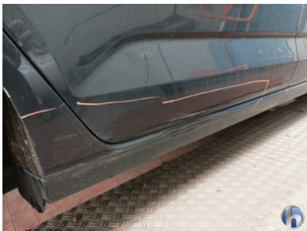
4. Schweller - Rechts Unfallschaden - Lackieren
