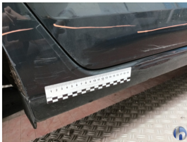
4. Schweller - Rechts Unfallschaden - Lackieren
