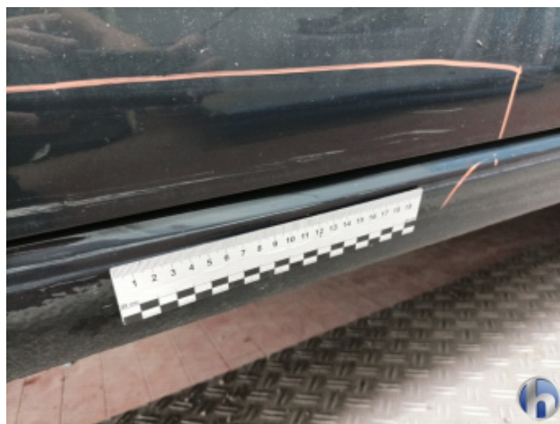
4. Schweller - Rechts Unfallschaden - Lackieren
