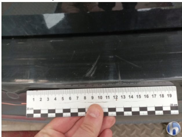
3. Stoßfänger Hinten Kratzer - Smart Repair
