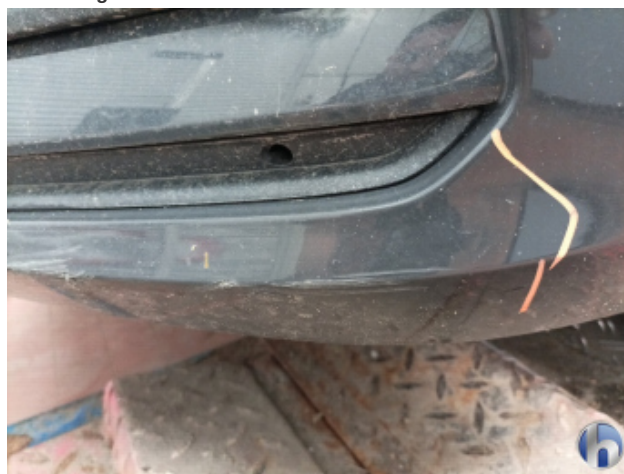
1. Frontspoiler Beschädigt - Erneuern
