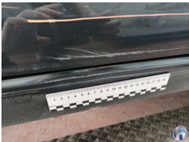
4. Schweller - Rechts Unfallschaden - Lackieren
