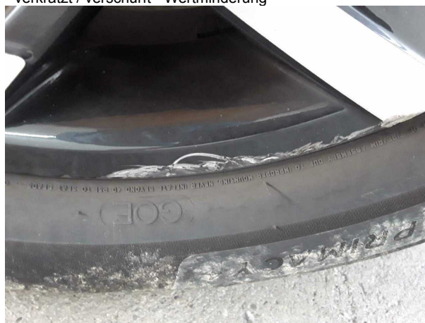
Beschädigung #3: Rad/Reifen: Leichtmetallfelge vorn rechts - verkratzt / verschürft - Wertminderung
