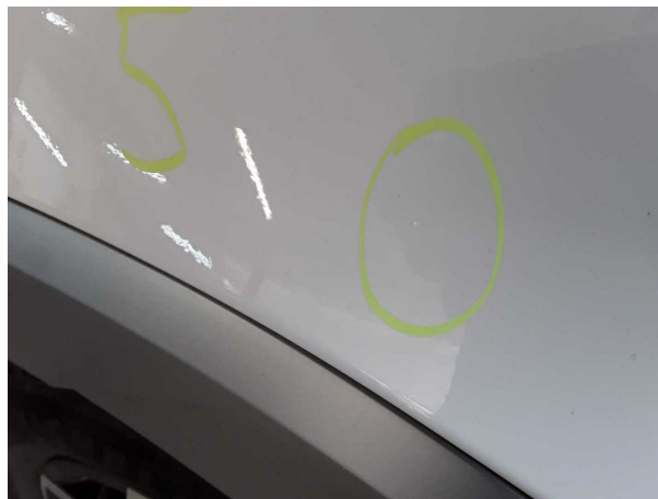
Beschädigung #1: Seitenwand links: Seitenwand - Lackmangel - auslegen / polieren
