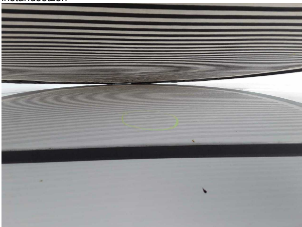
Beschädigung #4: Fahrzeugdach: Dach - Delle(n) - sanft instandsetzen
