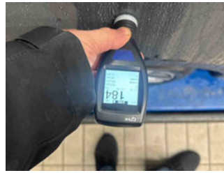
Lackstärke Kotflügel vorne links
