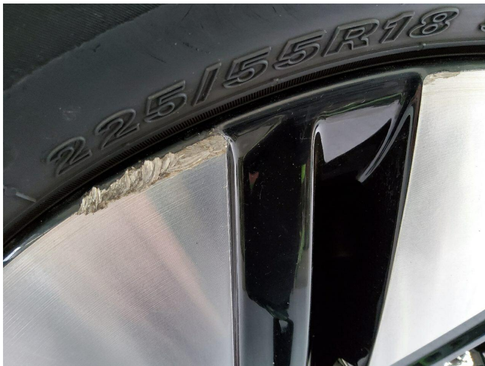
Bild 7 : Felge vorne rechts verschrammt
