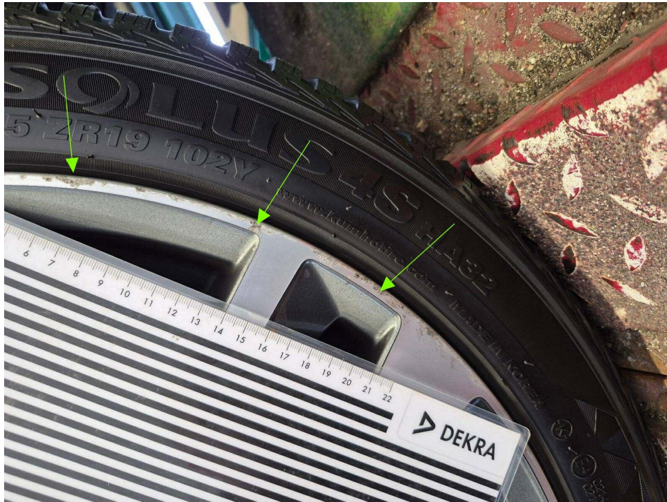
Bild 9 : Leichtmetallfelge vorne links Hochglanz verschrammt
