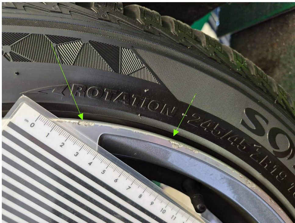
Bild 8 : Leichtmetallfelge vorne links Hochglanz verschrammt
