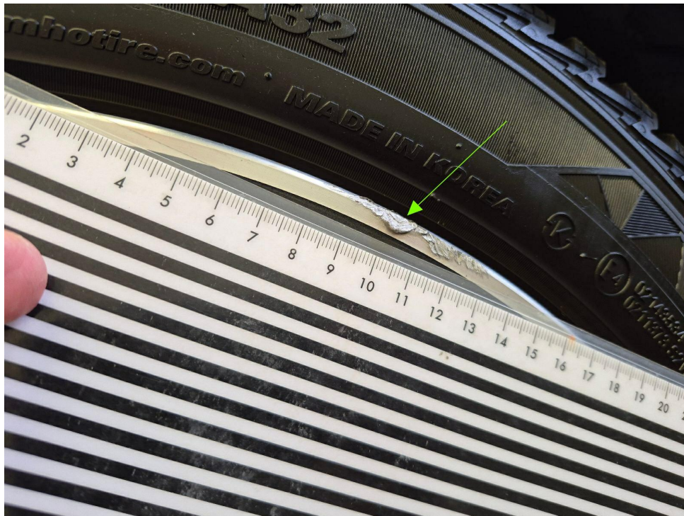
Bild 11 : Leichtmetallfelge vorne rechts Hochglanz verschrammt
