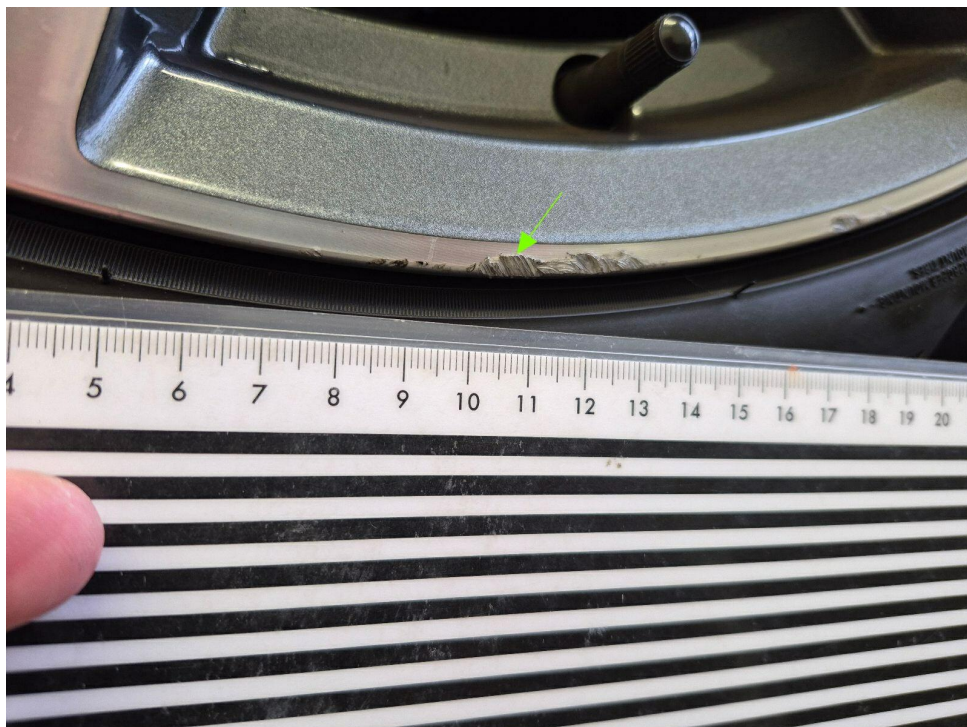
Bild 12 : Leichtmetallfelge vorne rechts Hochglanz verschrammt
