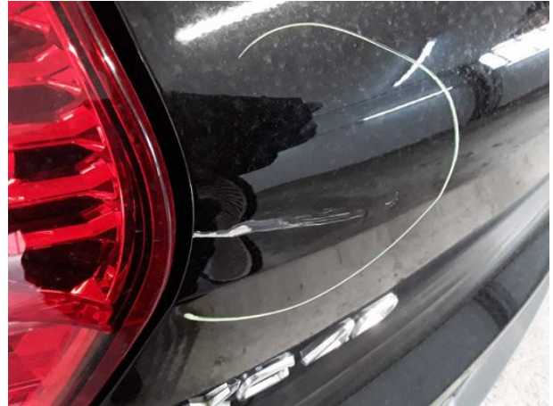
Beschädigung #10: Heckklappe/-tür: Heckklappe - Delle / Lackschaden - instandsetzen und lackieren
