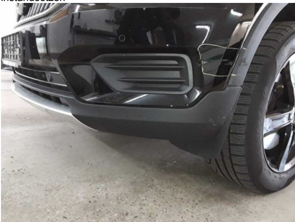
Beschädigung #3: Stossfänger vorn: Spoiler - verkratzt / versch... - Wertminderung
