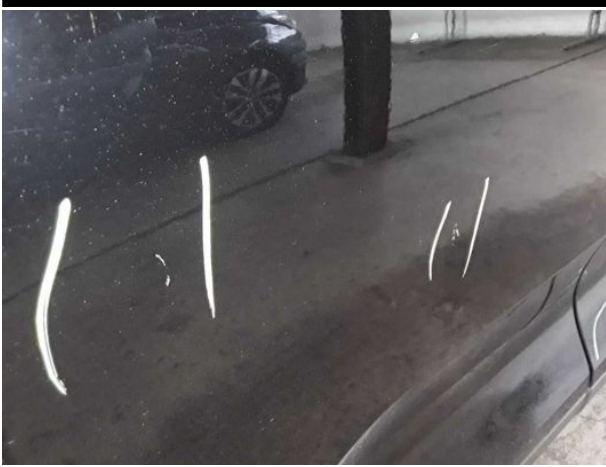
Beschädigung #8: Tür hinten rechts: Tür - verkratzt / verschürft - instandsetzen und lackieren
