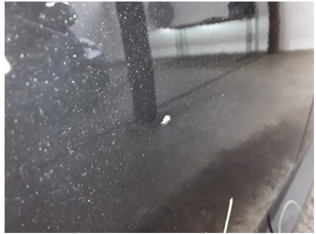
Beschädigung #8: Tür hinten rechts: Tür - verkratzt / versch... - instandsetzen und lackieren
