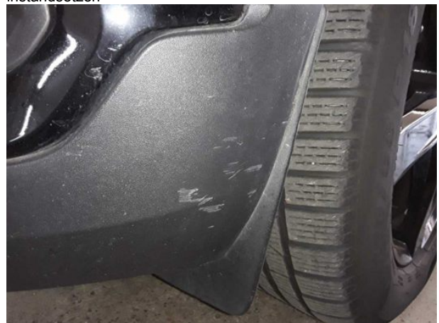
Beschädigung #3: Stossfänger vorn: Spoiler - verkratzt / verschürft - Wertminderung
