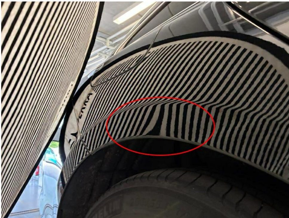
Bild 24 : Seitenwand hinten rechts Verformung
