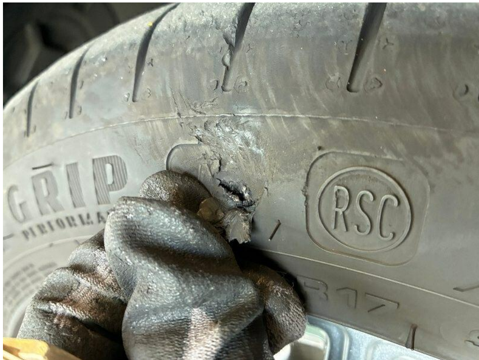
Bild 18 : Reifen vorne schadhaft
