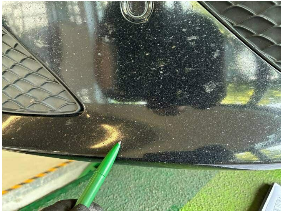
Bild 19 : Stoßfänger vorne Kratzer + erhöhte Steinschlagdichte + leichte Verformung
