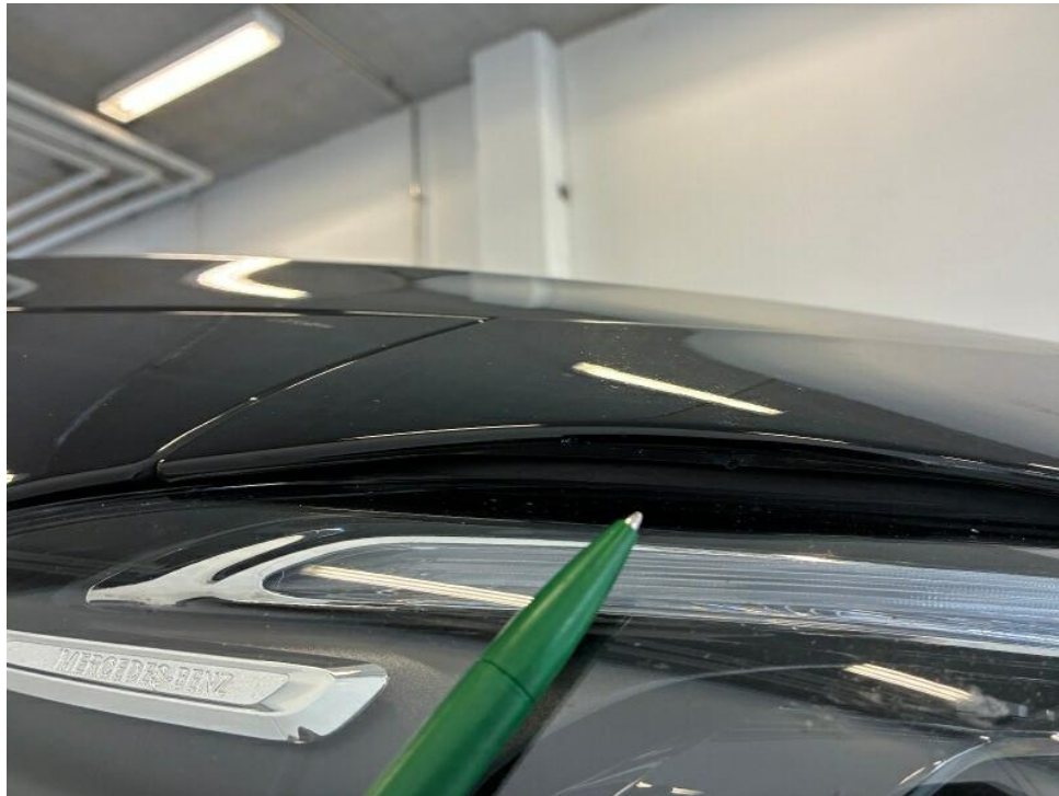
Bild 21 : Stoßfänger vorne Kratzer + erhöhte Steinschlagdichte + leichte Verformung
