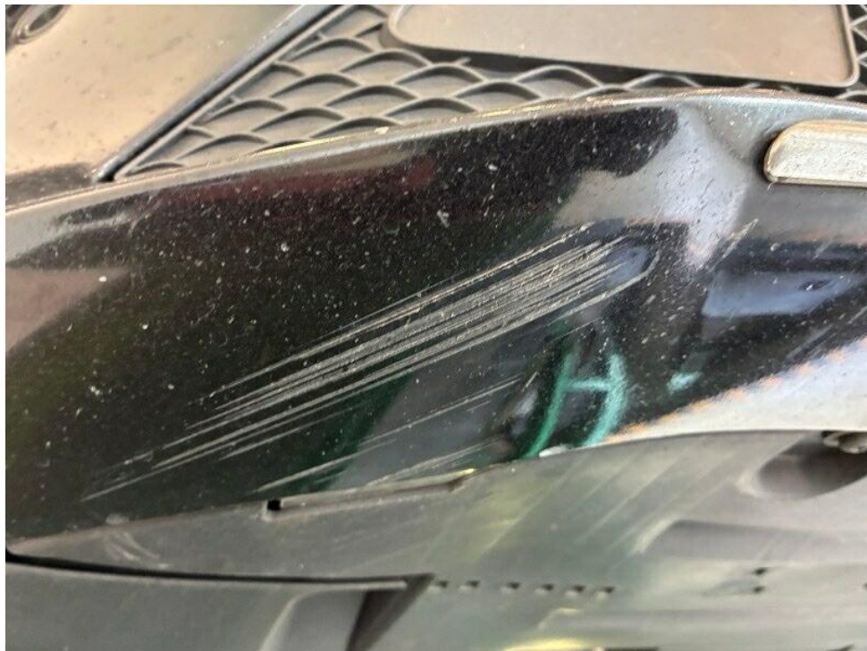
Bild 20 : Stoßfänger vorne Kratzer + erhöhte Steinschlagdichte + leichte Verformung
