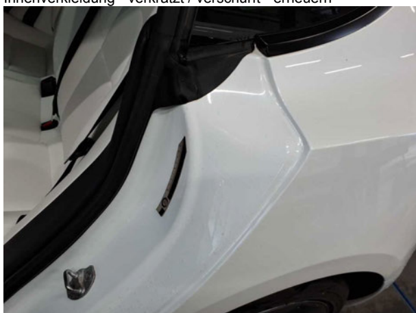
Beschädigung #2: Seitenwand links: Einstieg - Kratzer - Smart Repair
