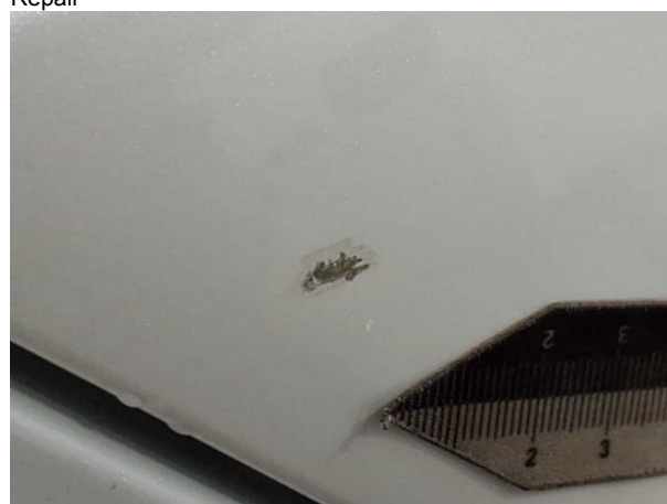
Beschädigung #3: Tür hinten rechts: Tür - verkratzt / verschürft - lackieren
