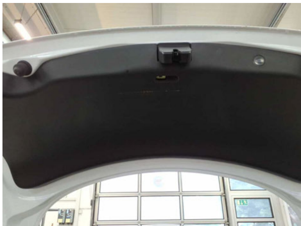
Beschädigung #1: Verkleidungen/Abdeckungen: Heckdeckel, Innenverkleidung - verkratzt / verschürft - erneuern
