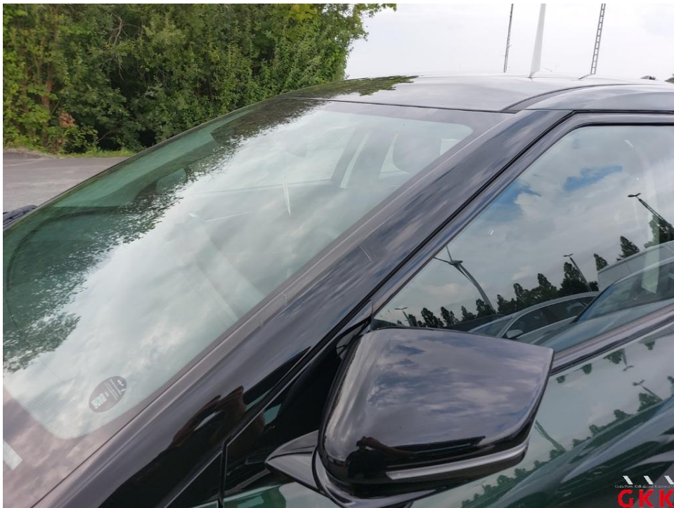
Bild 16. A- Säule links, Blende -lackiert-, verkratzt, lackieren
