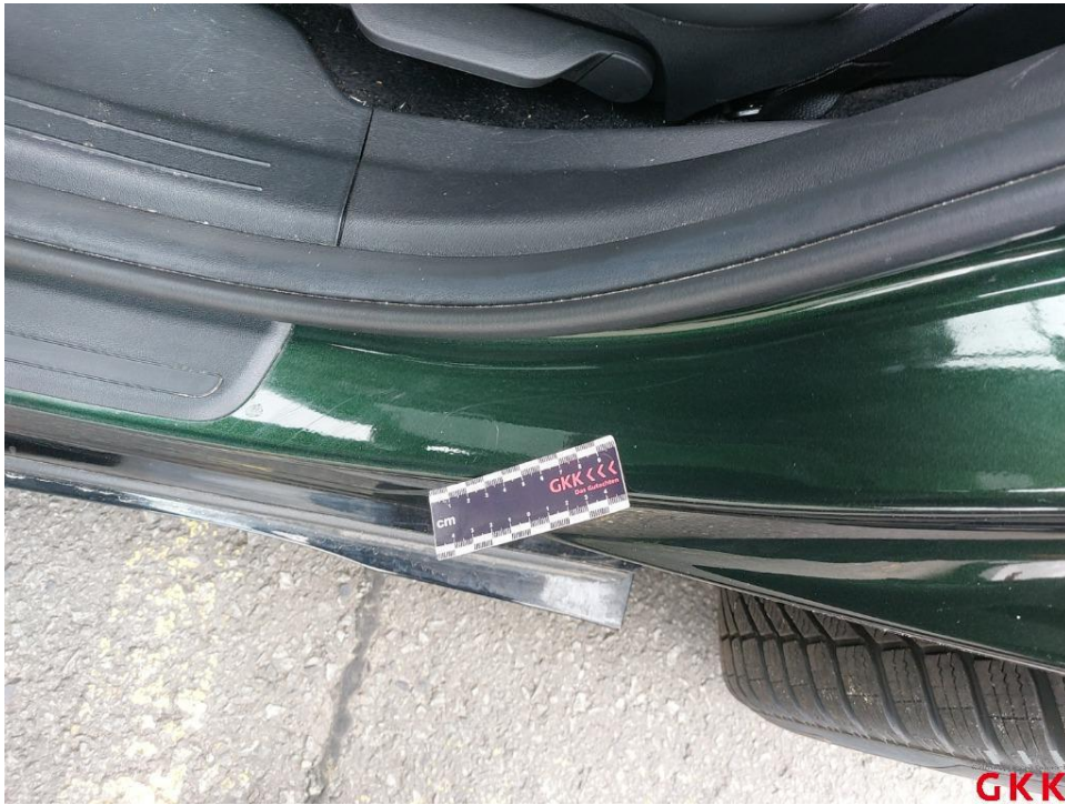
Bild 23. Tür hinten links, Einstieg, verkratzt, Smartrepair
