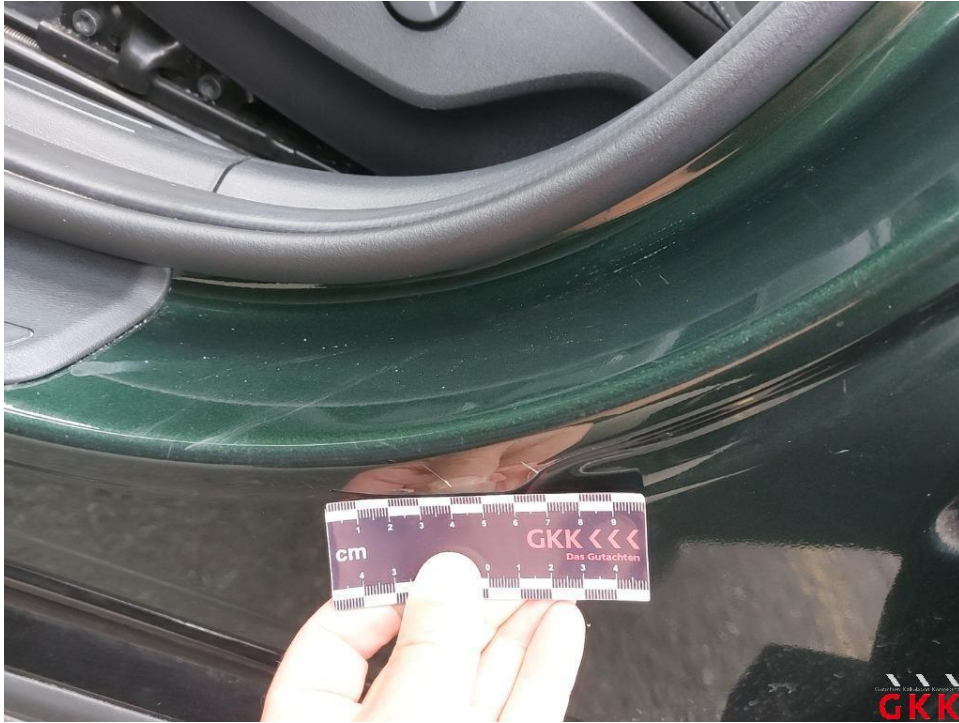
Bild 21. Tür vorne links, Einstieg, verkratzt, Smartrepair
