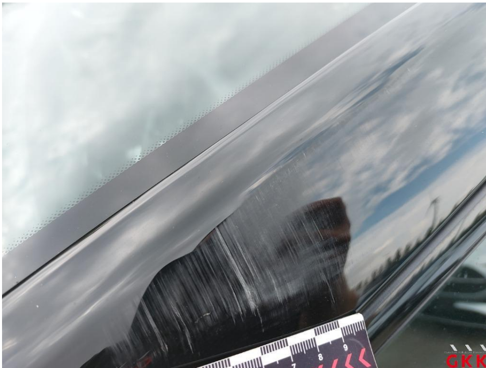
Bild 18. A- Säule links, Blende -lackiert-, verkratzt, lackieren
