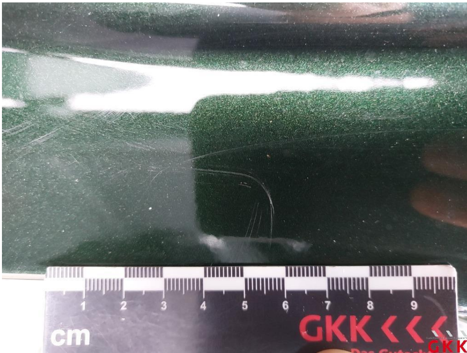
Bild 24. Tür hinten links, Einstieg, verkratzt, Smartrepair
