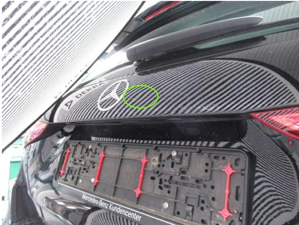
Bild 25 : Heckklappe, eingedellt, Gebrauchsspur
