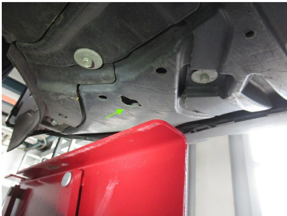
Bild 36 : Unterbodenverkleidung vorne links gebrochen
