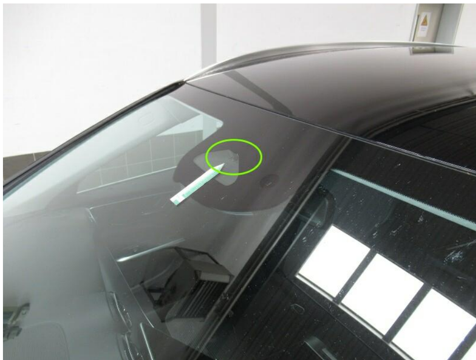
Bild 22 : "T" Frontscheibe Steinschlag mit Rissbildung nahe Kamera
