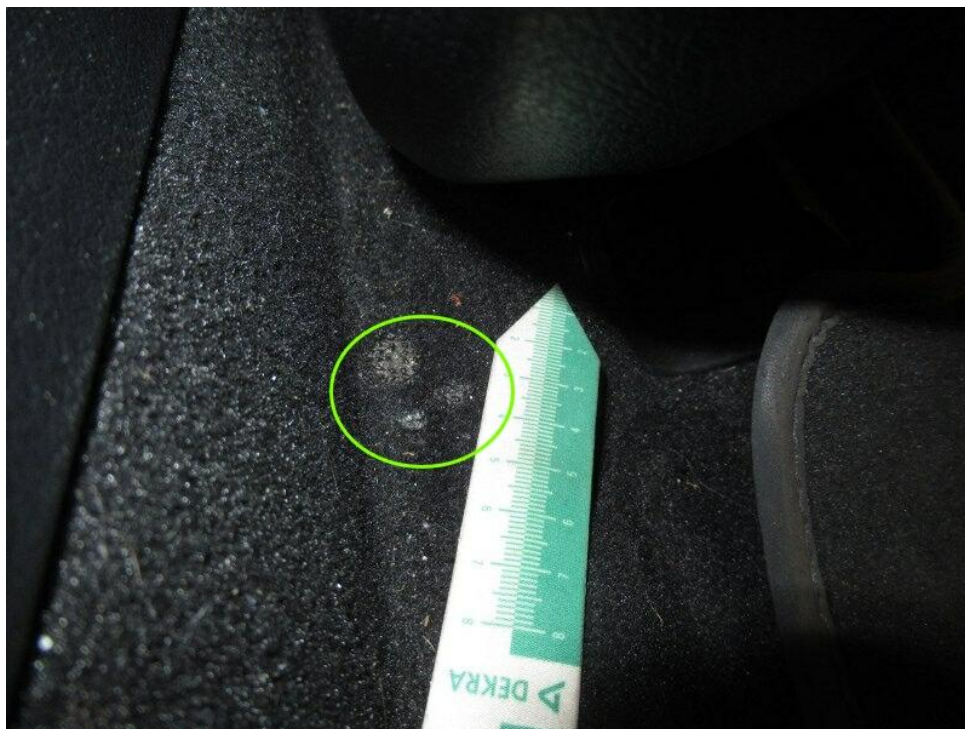
Bild 21 : Bodenbelag vorne links hinter Fahrersitz Brandloch
