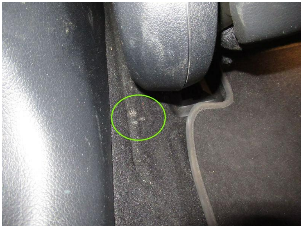
Bild 20 : Bodenbelag vorne links hinter Fahrersitz Brandloch
