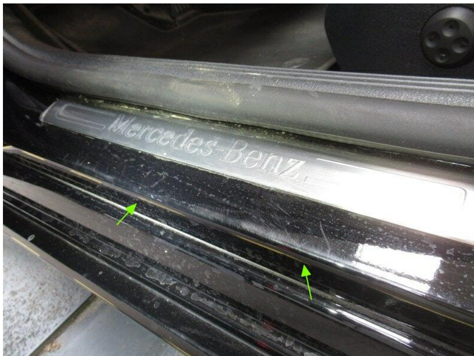
Bild 18 : Tür vorne links Einstieg Lackierung, zerkratzt, smart repair
