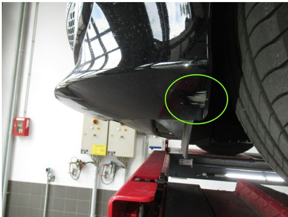
Bild 35 : Stoßfänger vorne links Lackierung zerkratzt
