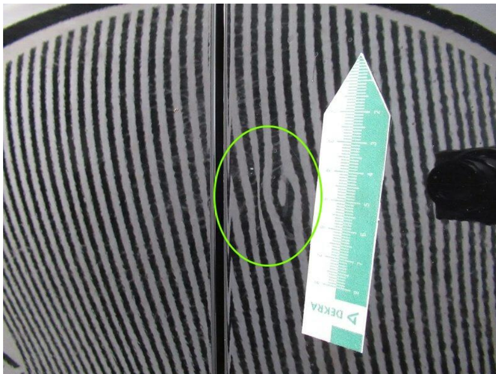
Bild 31 : Tür vorne rechts, eingedellt, drücken
