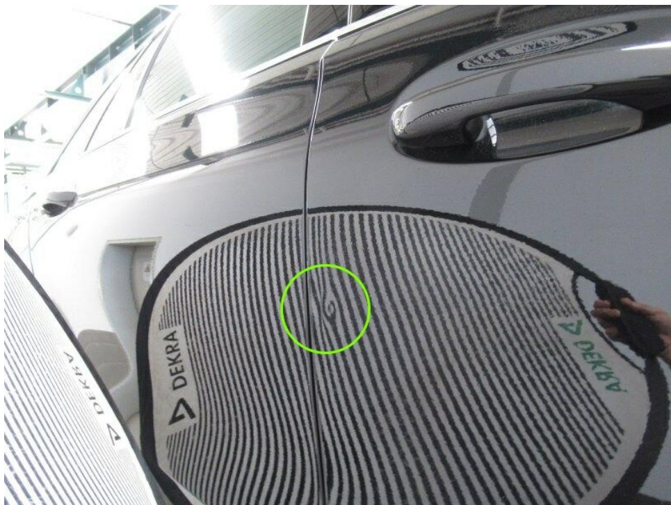
Bild 30 : Tür vorne rechts, eingedellt, drücken
