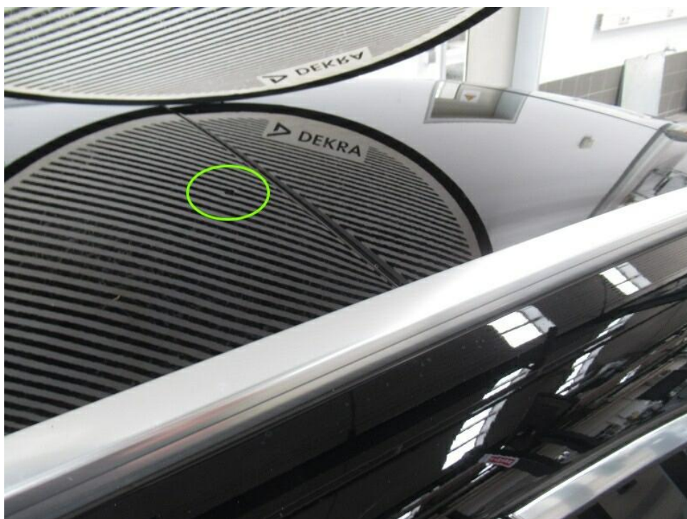
Bild 24 : Dach, eingedellt, Gebrauchsspur
