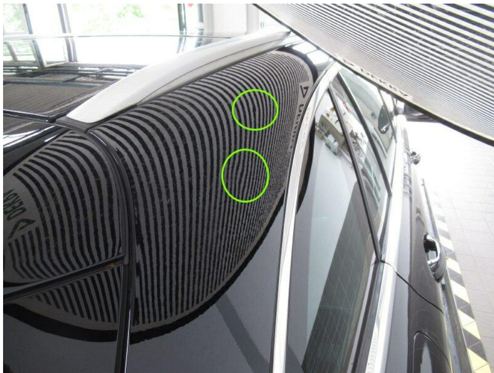
Bild 29 : Dachrahmen rechts, mehrfach eingedellt, drücken
